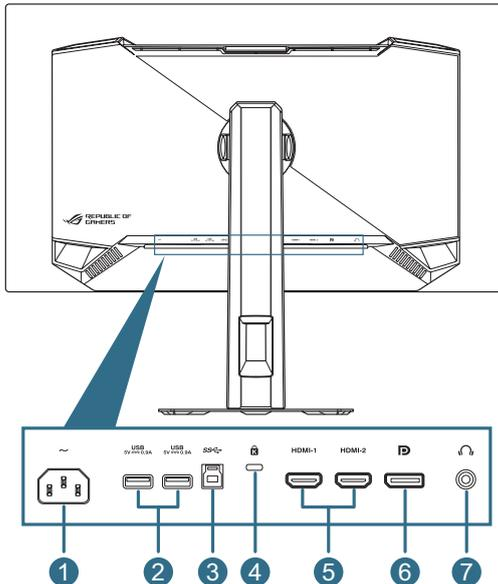
1. **Wechselstromeingang:** Hier schließen Sie das Netzkabel an.
