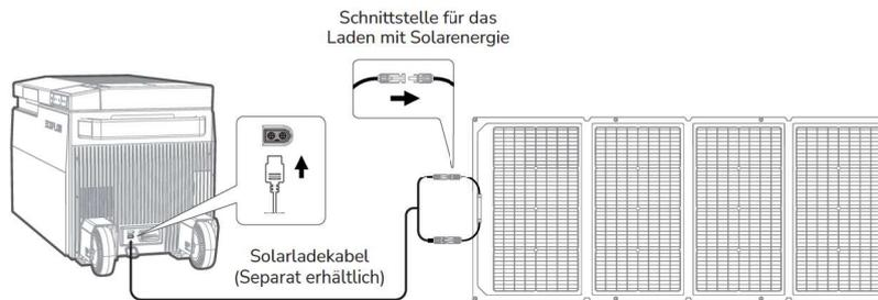
Dieses Produkt unterstützt das Aufladen mit Solarenergie und unterstützt das Aufladen des Akkupacks EFBX100-EB (fakultativ) mit einer maximalen Leistung von 180 W.
