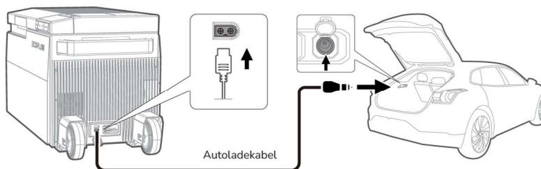
Dieses Produkt unterstützt das Laden im Auto über den 12 V/24 V-Autoladeanschluss und lädt den angeschlossenen EFBX100-EB-Akkupack (fakultativ) mit einem maximalen Strom von 10 A.
