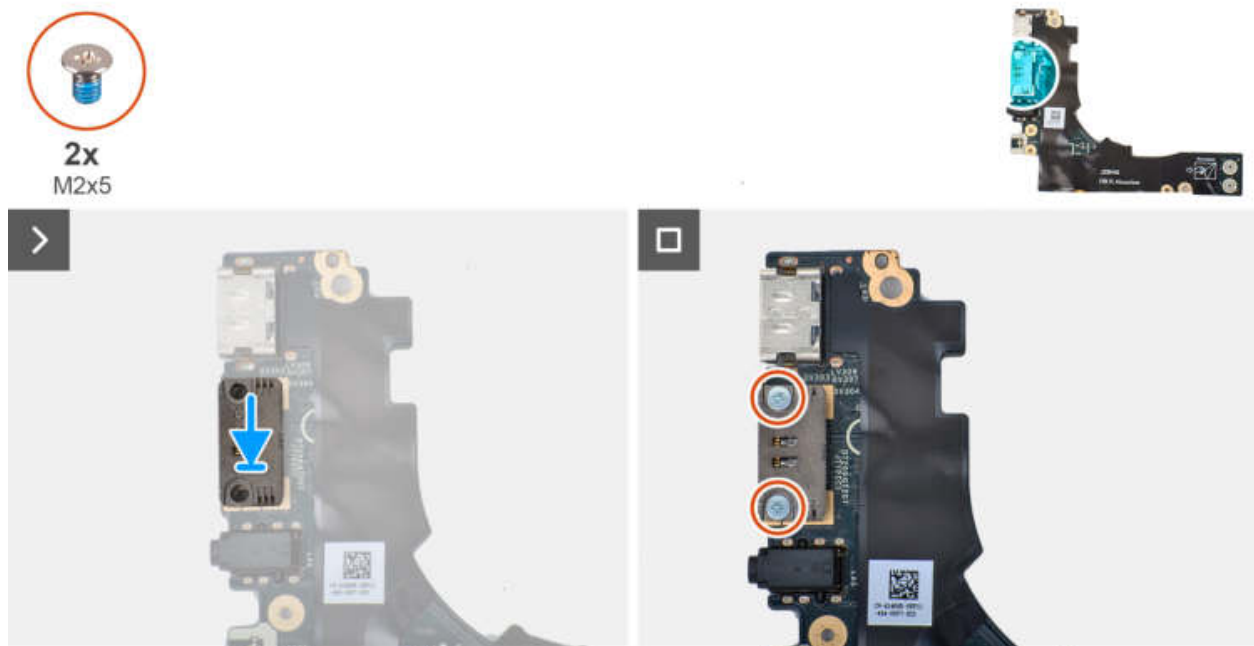
Abbildung 56. Installieren des rechten USB Typ-C-Moduls
