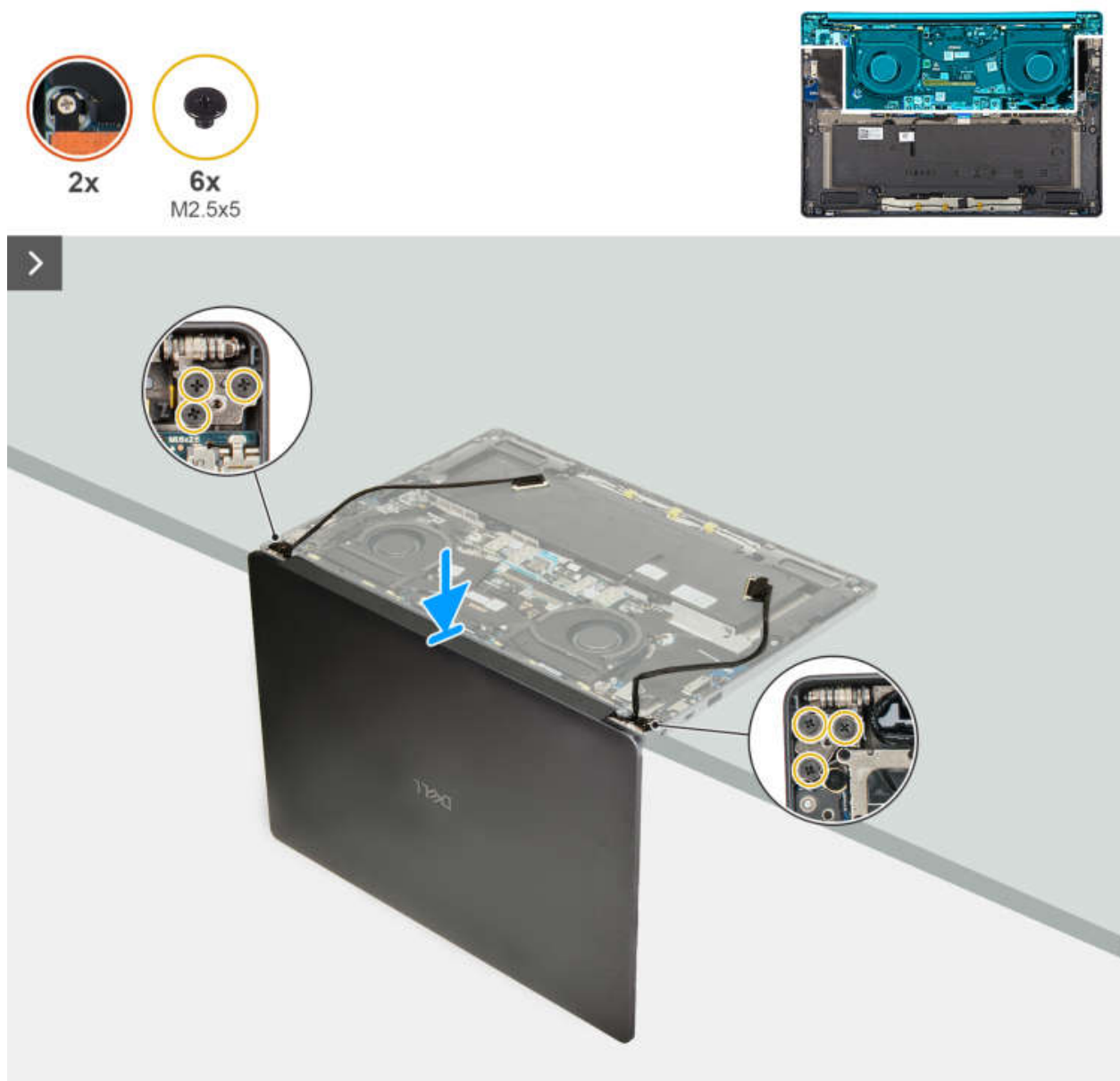
Abbildung 62. Einbauen der Displaybaugruppe
