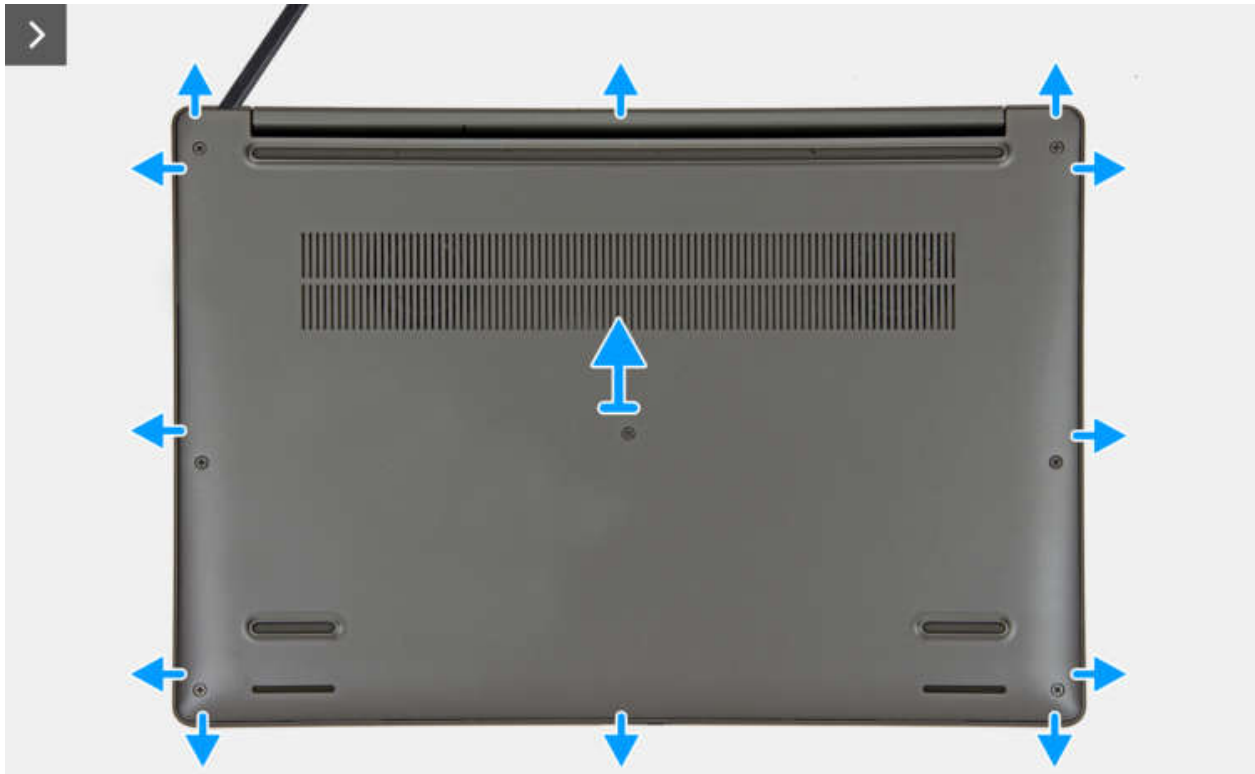
Abbildung 15. Entfernen der Bodenabdeckung
