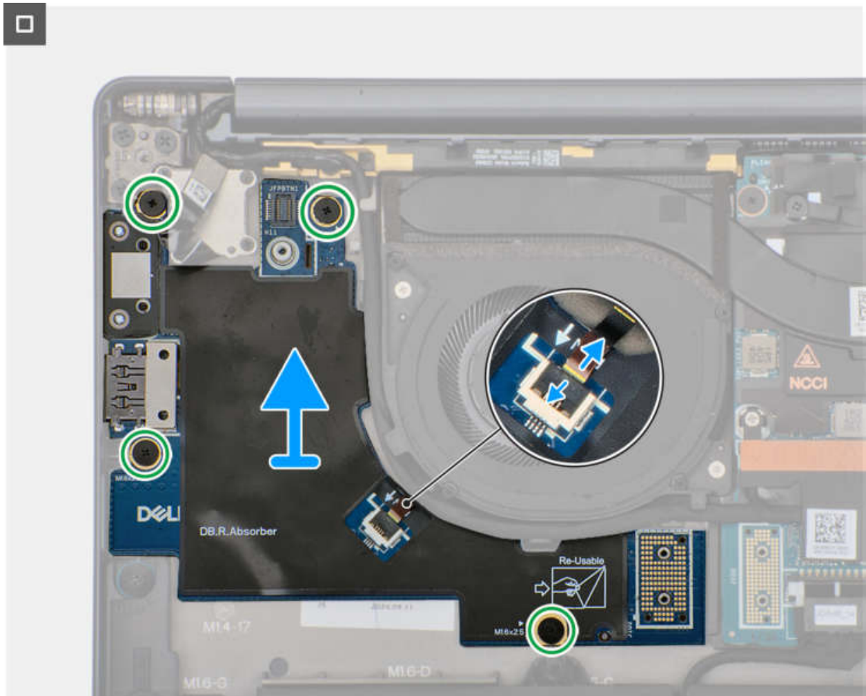
Abbildung 42. Entfernen der rechten I/O-Platine (ohne WWAN-Antennen)
