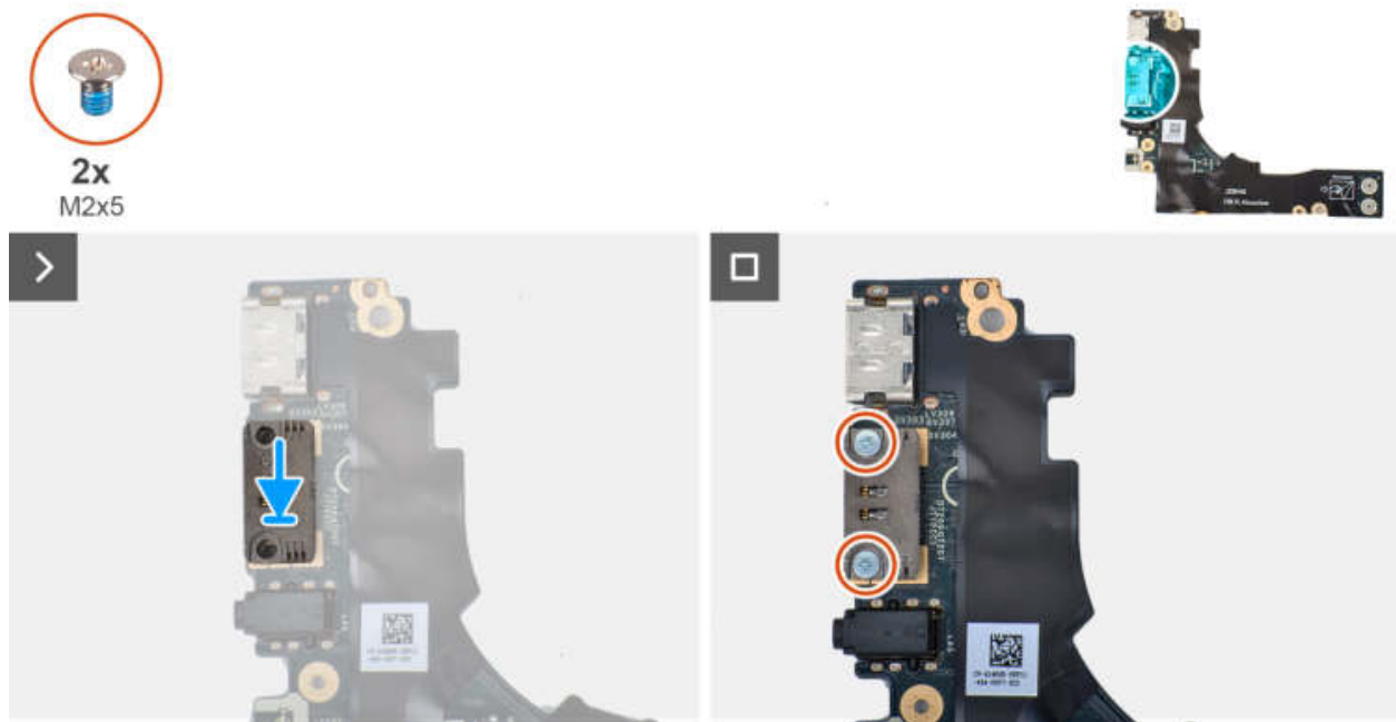
Abbildung 55. Entfernen des optionalen USB Type-C-Moduls
