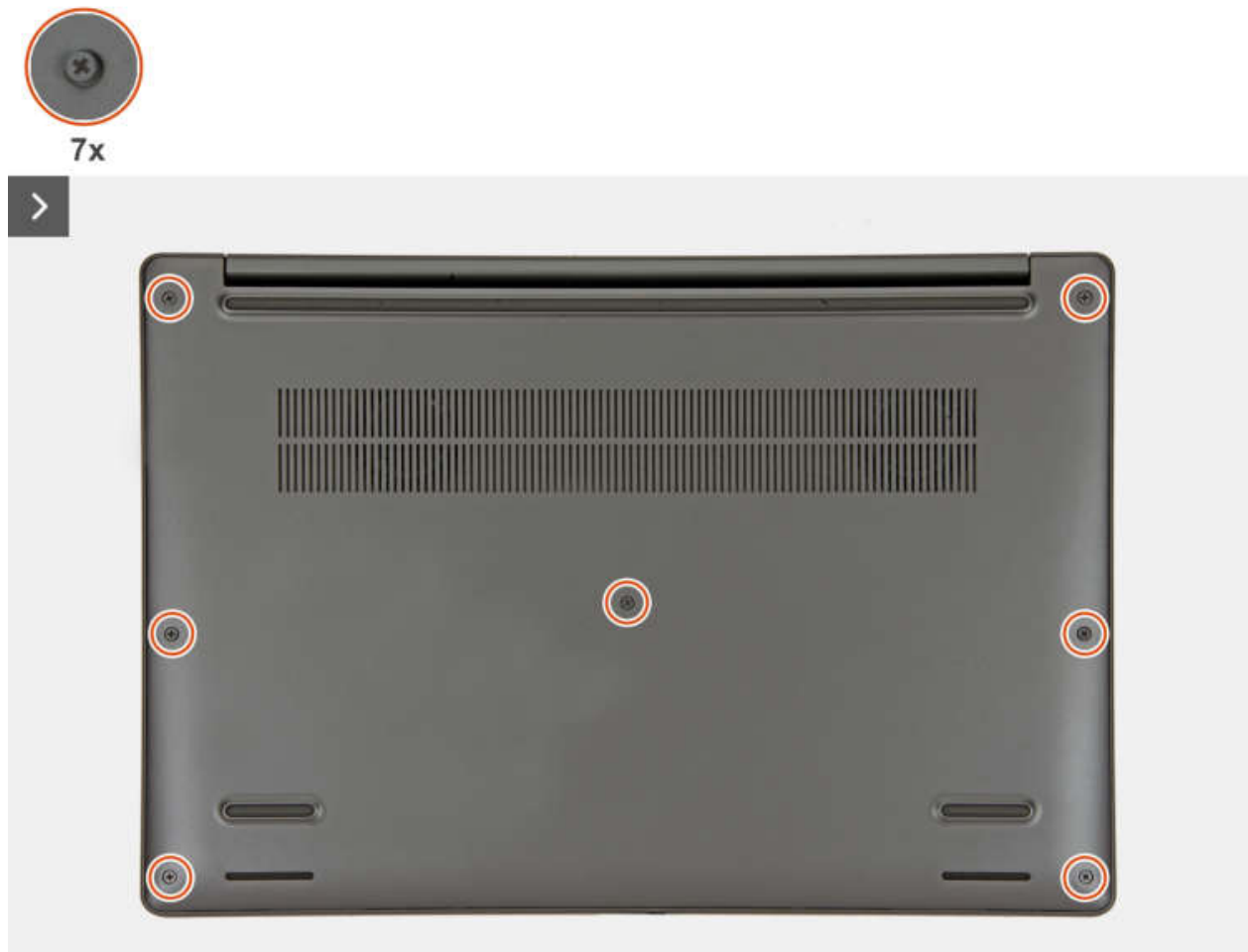
Abbildung 14. Lösen der unverlierbaren Schrauben
