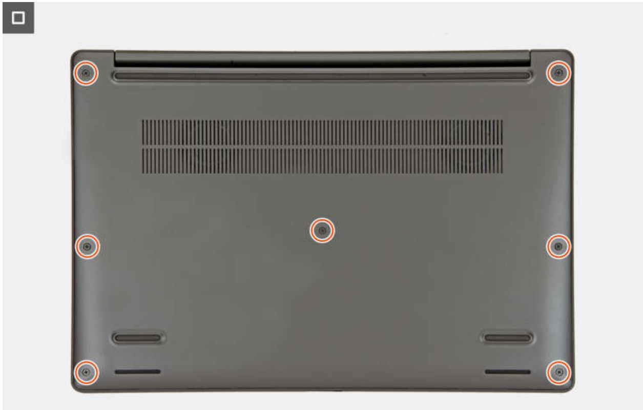
Abbildung 19. Festziehen der unverlierbaren Schrauben
