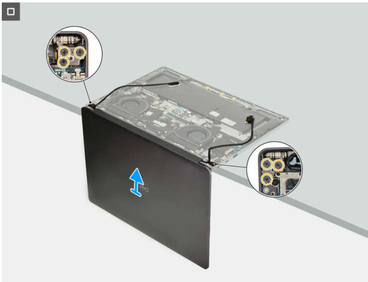
Abbildung 60. Entfernen der Bildschirmbaugruppe
