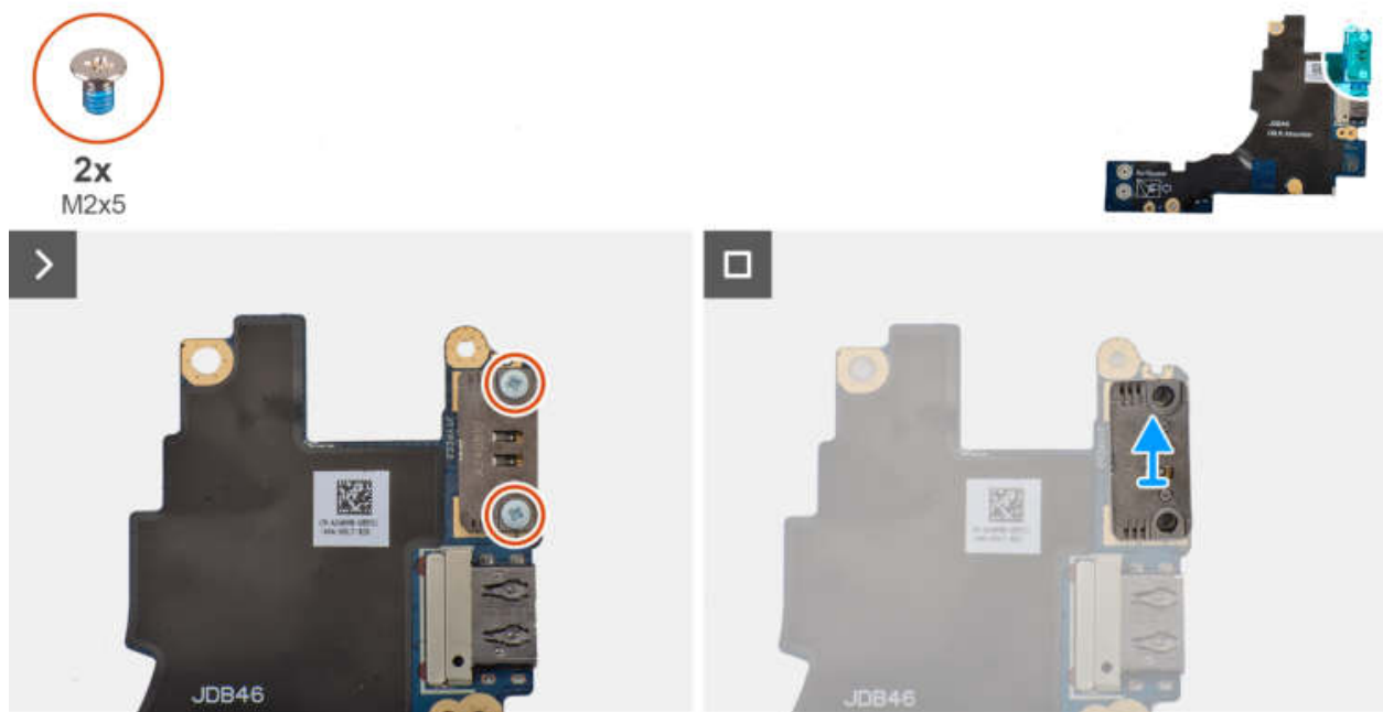
Abbildung 53. Entfernen des linken USB Typ-C-Moduls
