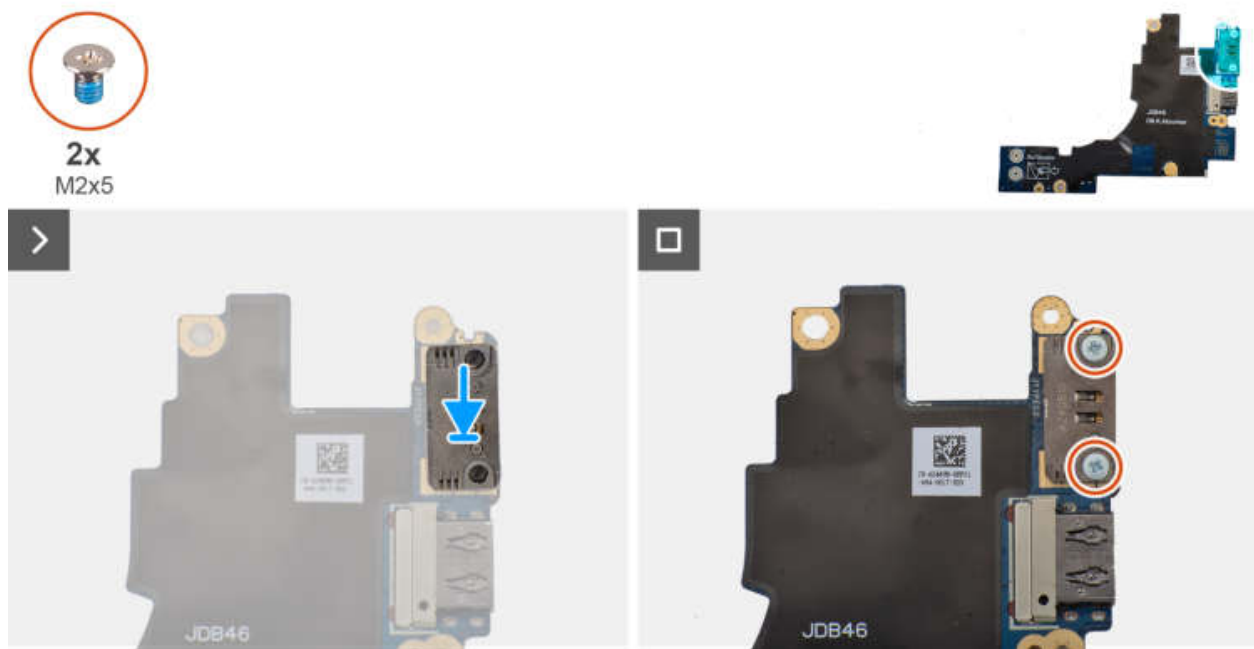
Abbildung 54. Installieren des linken USB Typ-C-Moduls
