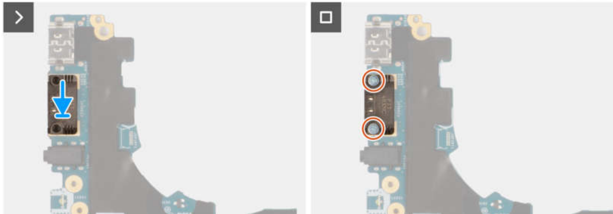
Abbildung 53. Installieren des rechten USB Typ-C-Moduls
