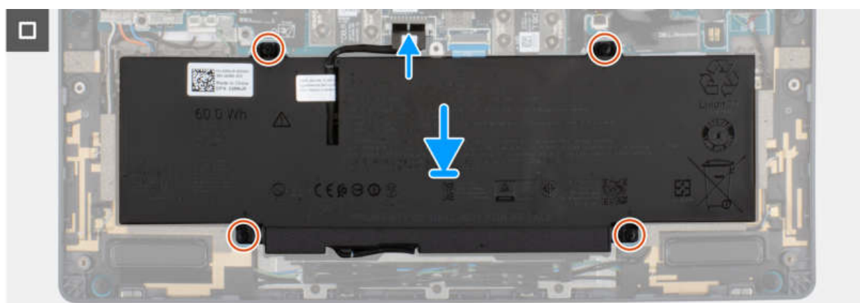
Abbildung 23. Einsetzen des Akkus
