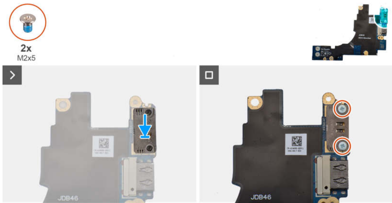
Abbildung 51. Installieren des linken USB Typ-C-Moduls
