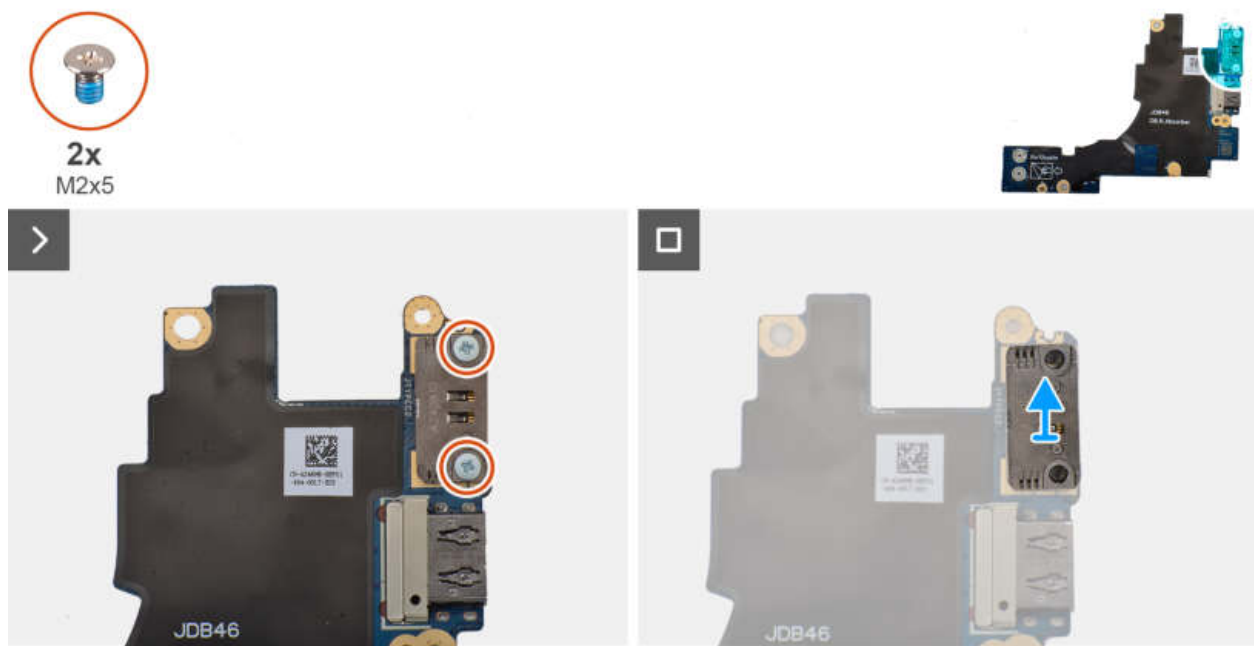
Abbildung 50. Entfernen des linken USB-Typ-C-Moduls
