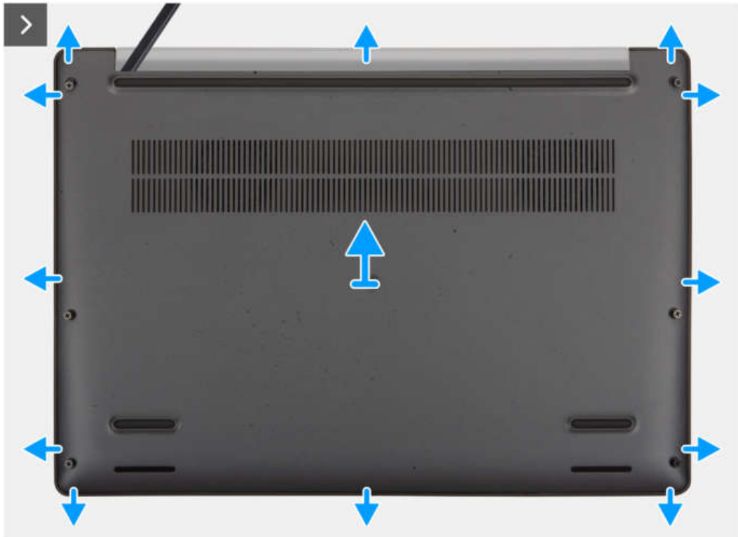
Abbildung 15. Entfernen der Bodenabdeckung
