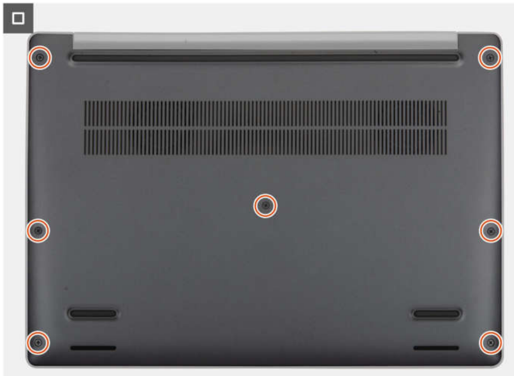
Abbildung 19. Festziehen der unverlierbaren Schrauben
