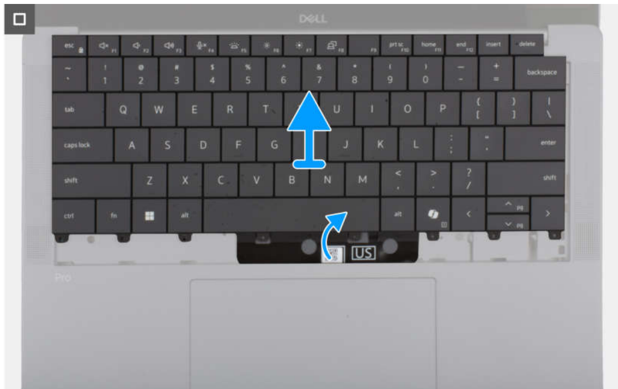
Abbildung 72. Entfernen der Tastaturbaugruppe
