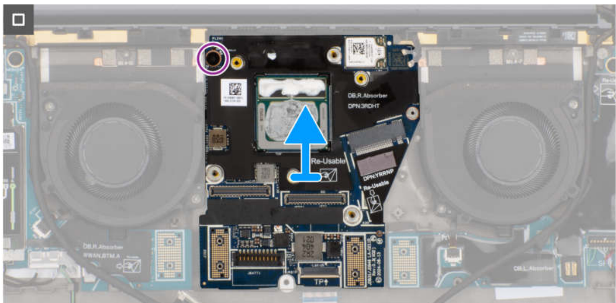
Abbildung 64. Entfernen der Systemplatine
