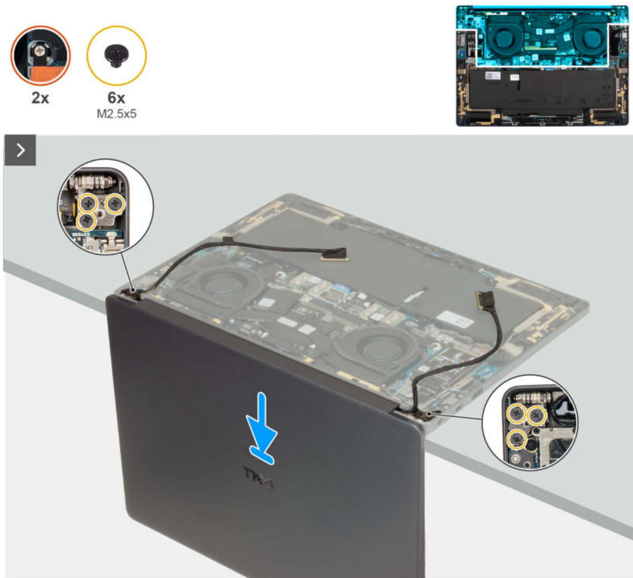
Abbildung 59. Einbauen der Displaybaugruppe
