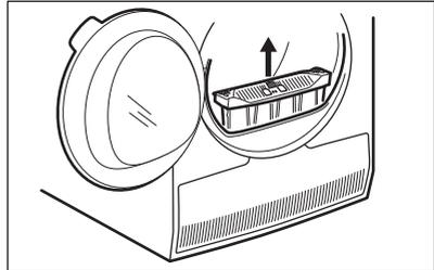
2. Öffnen Sie die Kondensatorabdeckung.
