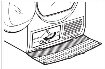
4. Klappen Sie den Kondensatordeckel nach unten.
