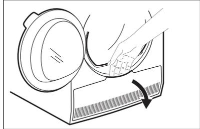
3. Drehen Sie den Hebel, um den Kondensatordeckel zu entriegeln.
