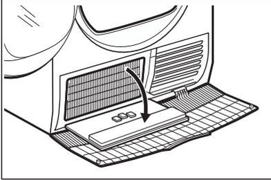
5. Entfernen Sie nach Bedarf die Flusen aus dem Kondensator und seinem Fach. Sie können einen Staubsauger mit dem Bürstenaufsatz verwenden.
