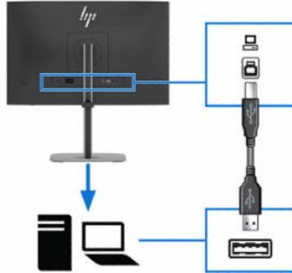
**HINWEIS:** Dieser Schritt ist erforderlich, um die USB-Anschlüsse (Downstream) zu aktivieren. Die Verbindung des USB Type-B-auf-USB Type-A-Kabels vom Quellgerät zum USB Type-B-Anschluss (Upstream) an der Rückseite des Monitors dient als USB-Hub für Maus, Tastaturen, Telefone, externe Festplatten und alles, was sonst über einen USB-Anschluss angeschlossen ist.
