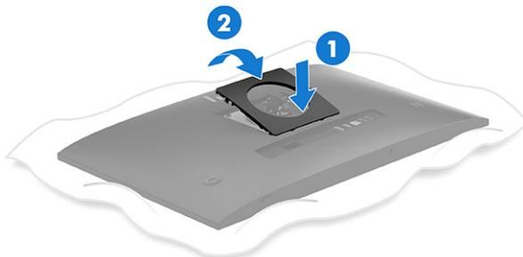
3. Entfernen Sie die vier Schrauben aus den VESA Bohrungen auf der Rückseite des Monitorkopfs (1) und entfernen Sie dann den Monitorständeranschluss (2).
