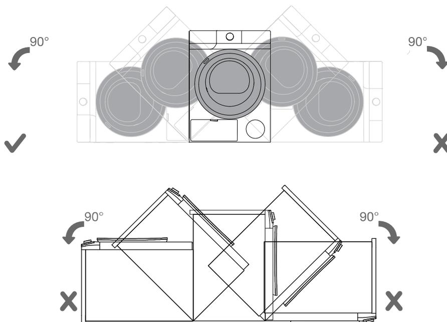
⚠ Warten Sie nach der Installation 24 Stunden, ohne das Gerät zu bewegen, bevor Sie es zum ersten Mal verwenden. Wenn der Trockner während des Transports oder der Wartung auf einer der Seiten abgelegt werden muss, legen Sie ihn mit der linken Seite, von der Vorderseite des Geräts aus gesehen, nach unten.
