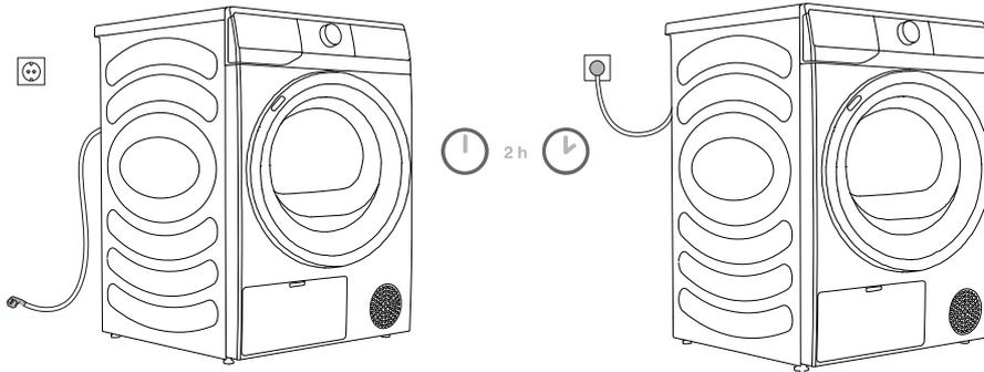
**⚠ Nach der Installation sollte der Trockner zwei Stunden lang stillstehen, bevor er an das Stromnetz angeschlossen wird. Dadurch kann sich der Trockner stabilisieren.**
