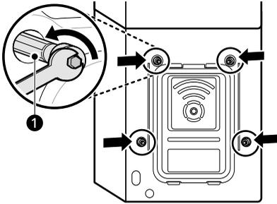
**2** Entfernen Sie die Schrauben, indem Sie vorsichtig daran wackeln, während Sie sie herausziehen.
