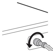
**2** Entfernen Sie den Wasserzulauffilter mit einer kleinen Zange und reinigen Sie den Filter mit einer Zahnbürste mit mittleren Borsten.
