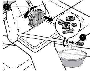
**4** Setzen Sie den Filter nach dem Reinigen des Abfluspumpenfilters vorsichtig wieder ein und schrauben Sie die Ablasskappe vorsichtig im Uhrzeigersinn wieder ein, um Quergewinde und Leckagen zu vermeiden. Stecken Sie die Ablassschraube wieder in den Abflussschlauch und setzen Sie den Schlauch in seine Halterung ein.
