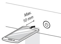
**3** Halten Sie die **Temp.**-Taste mindestens 3 Sekunden lang gedrückt, während Sie das Smartphone an die Taste **An-/Aus** halten, bis die Datenübertragung abgeschlossen ist.
