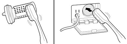
**6** Nach dem Reinigen des Ablaufpumpenfilters setzen Sie den Filter vorsichtig wieder ein und schrauben Sie die Abflusskappe im Uhrzeigersinn vorsichtig wieder ein, um ein Überdrehen des Gewindes und Leckagen zu vermeiden.
