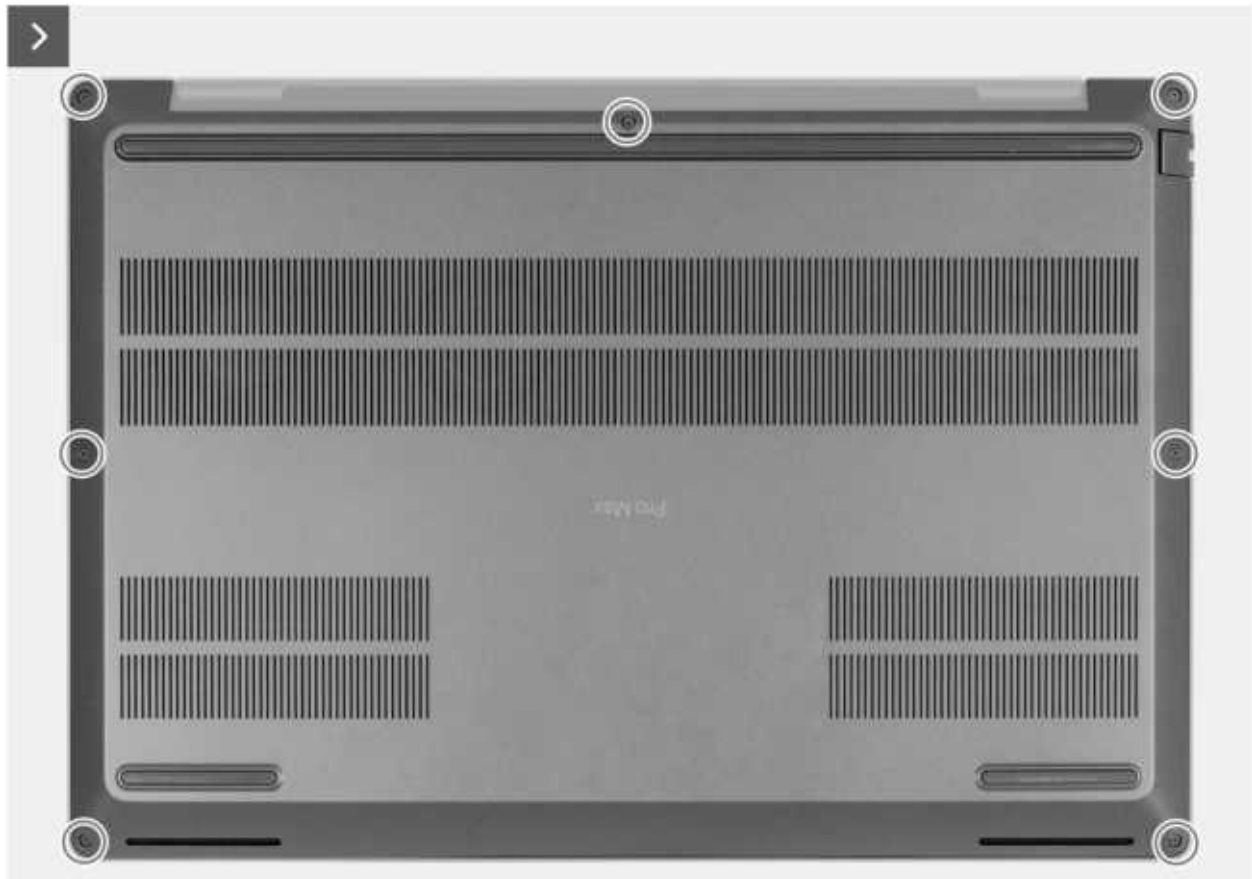
Abbildung 24. Lösen der unverlierbaren Schrauben
