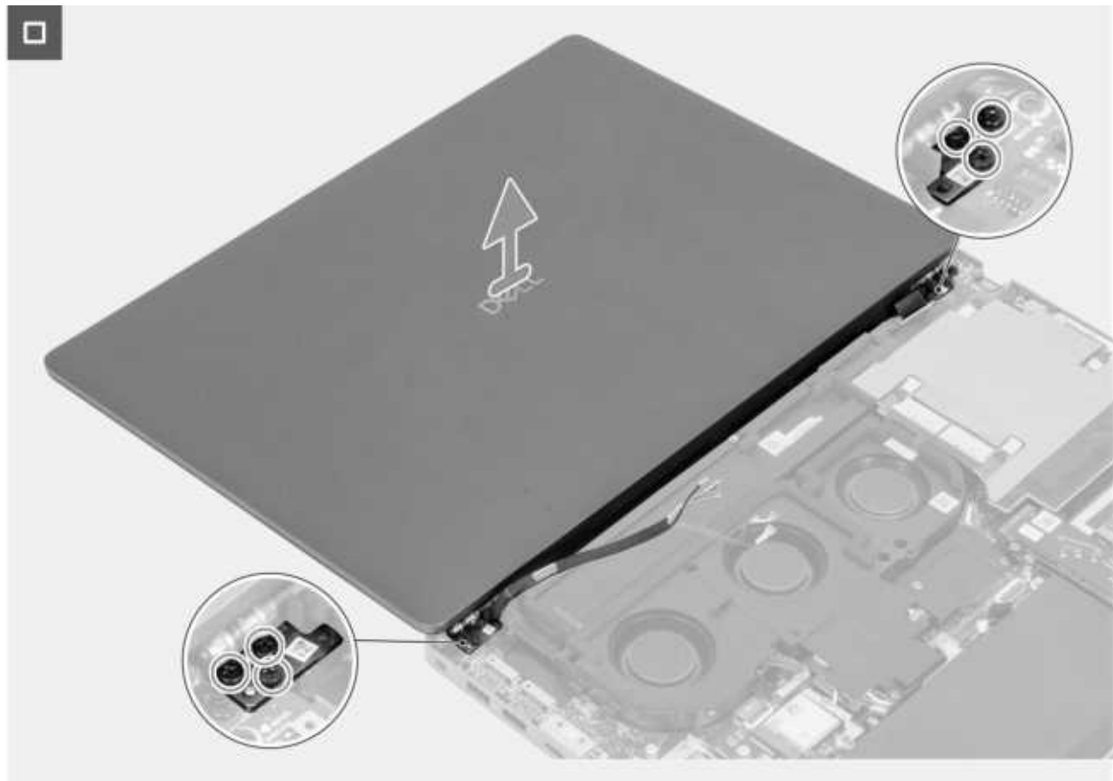
Abbildung 67. Entfernen der Bildschirmbaugruppe
