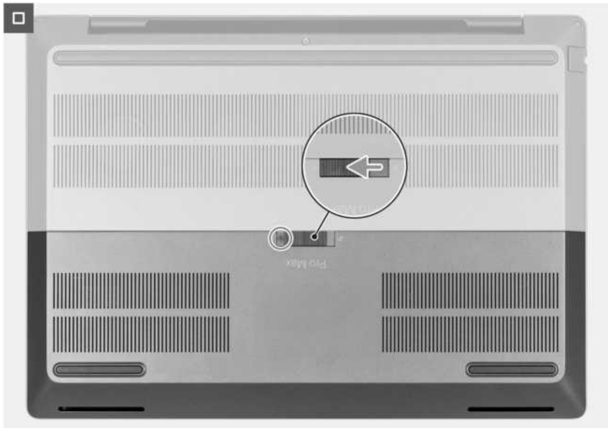
Abbildung 17. Austauschen der Schraube und Schieben des Türschlosses in die Verriegelungsposition
