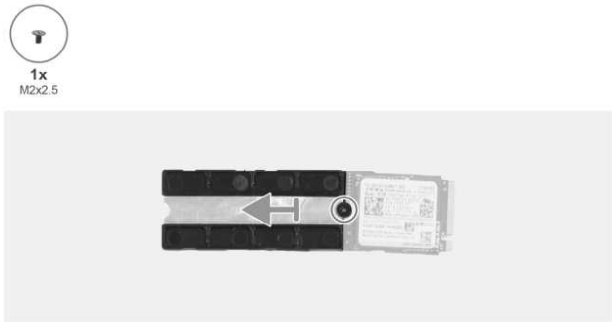
Abbildung 38. Entfernen des M.2-2230-Solid-State-Laufwerks
