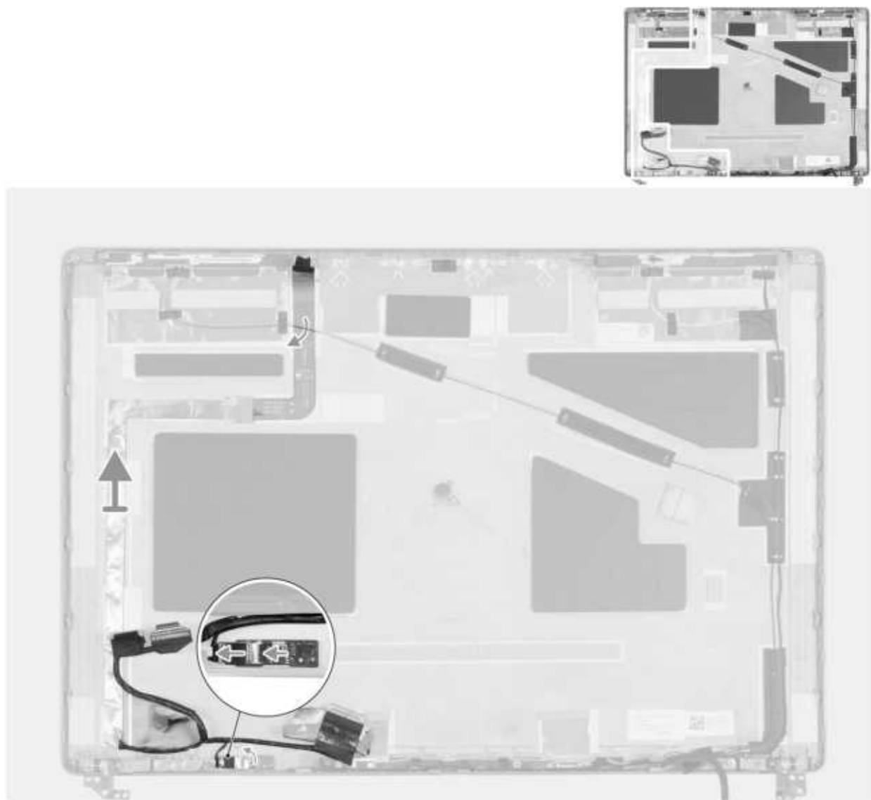
Abbildung 107. Entfernen des Bildschirmkabels
