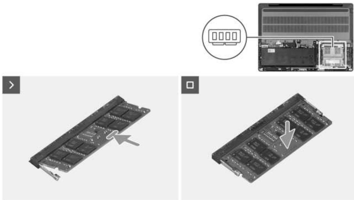
Abbildung 31. Einsetzen des Speichermoduls
