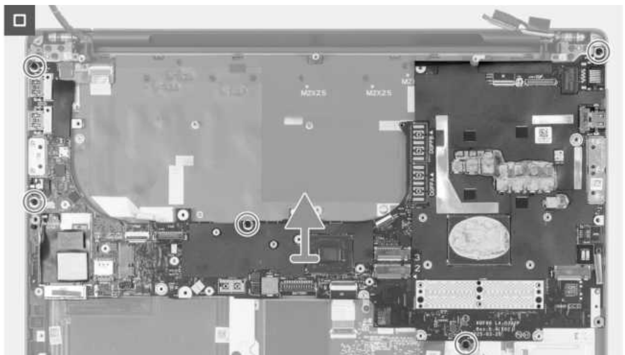
Abbildung 113. Entfernen der Systemplatine
