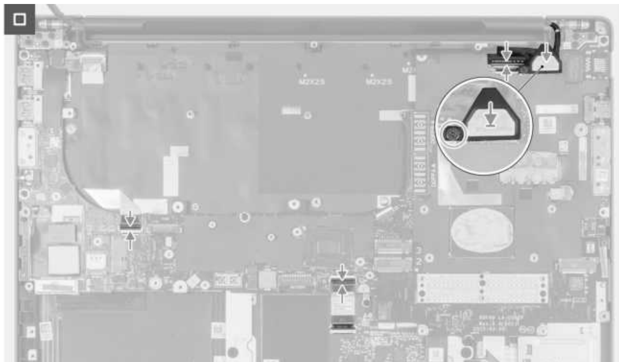
Abbildung 117. Einbauen der Systemplatine
