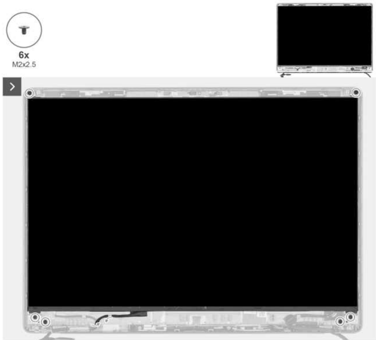
Abbildung 98. Entfernen des Bildschirms bei Bildschirmen ohne Touchscreen
