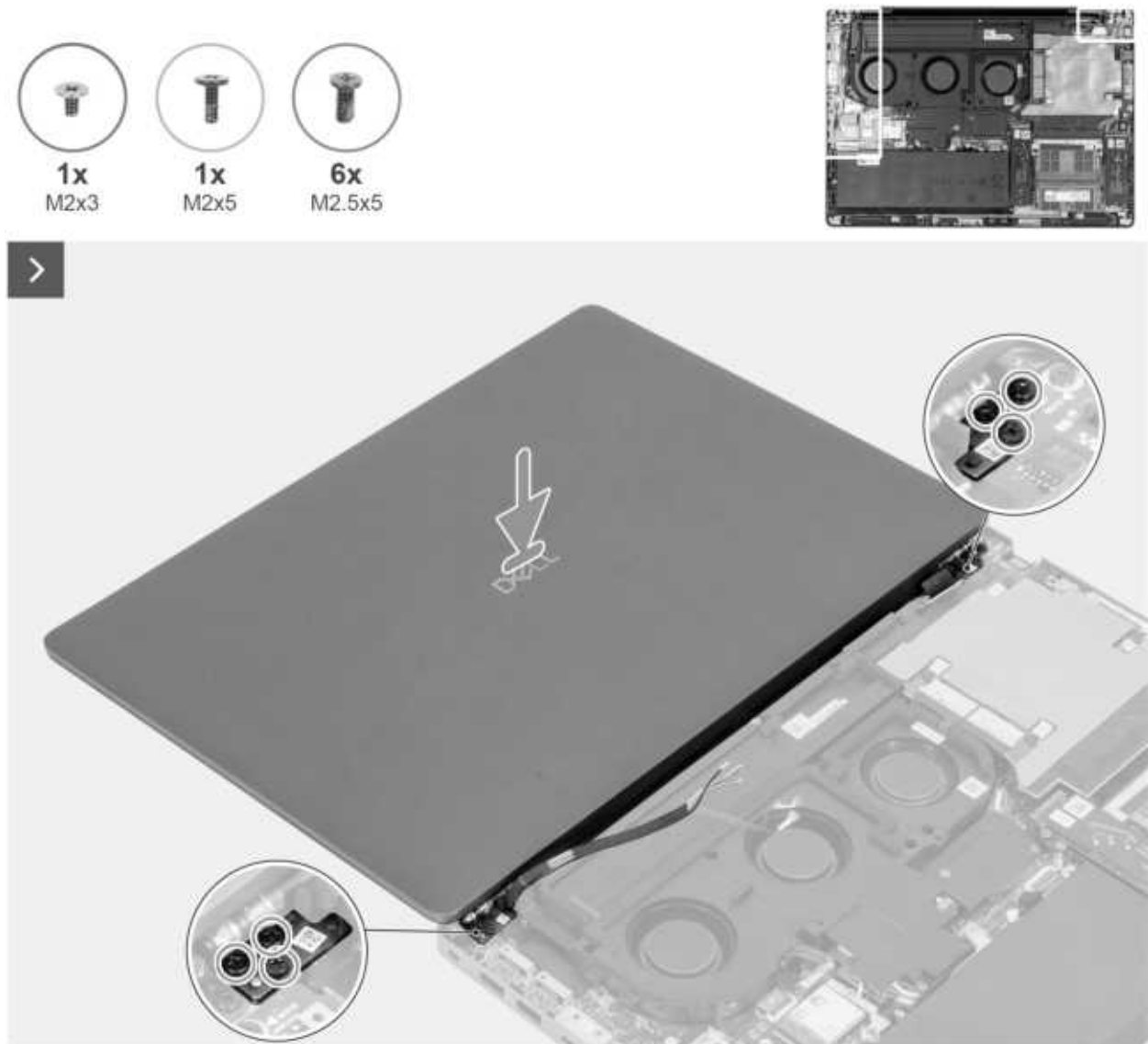
Abbildung 68. Einbauen der Bildschirmbaugruppe
