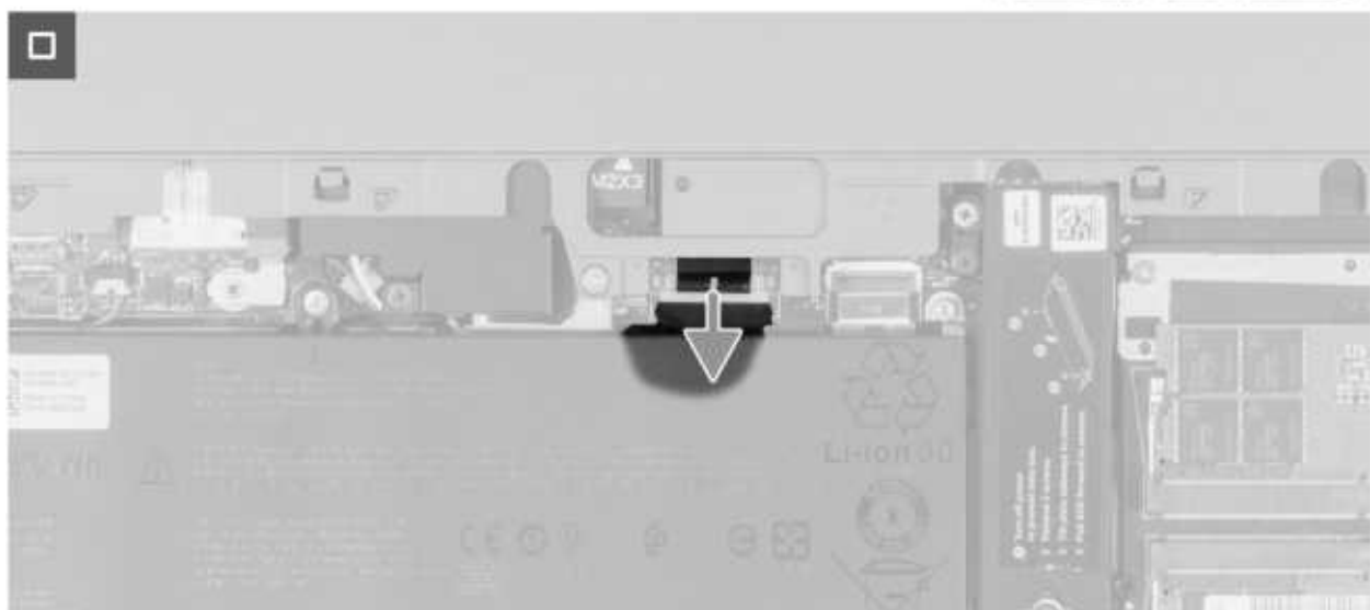
Abbildung 14. Trennen des Akkukabels
