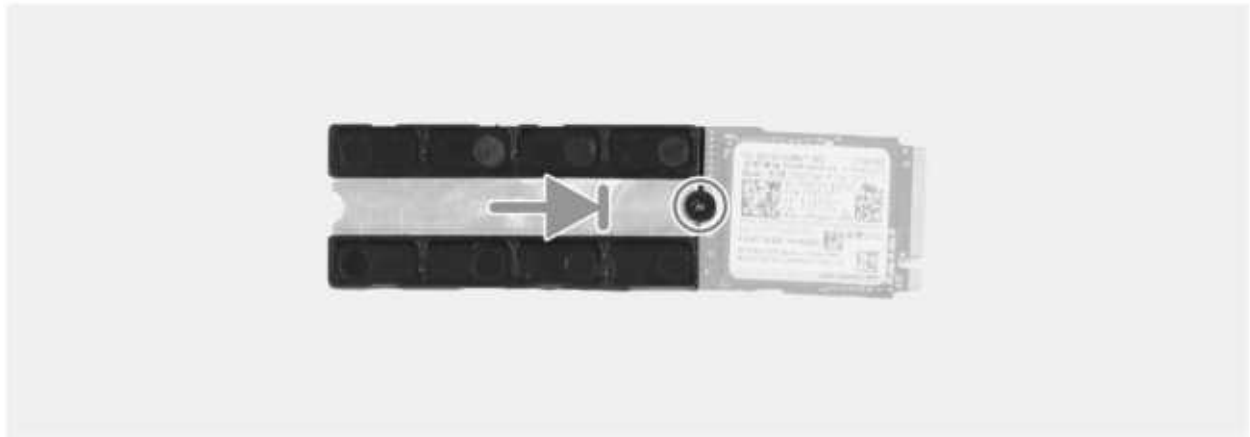
Abbildung 39. Einbauen des M.2-2280-SSD
