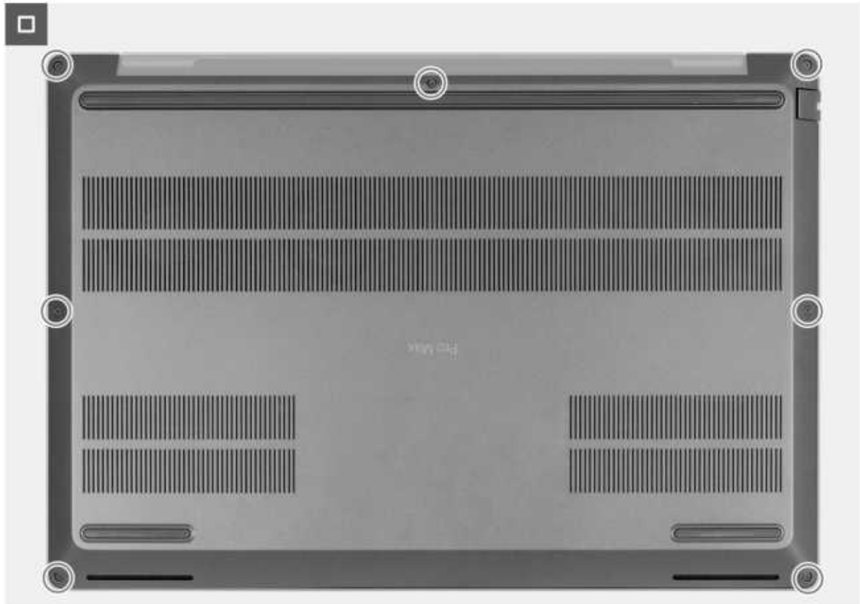
Abbildung 29. Festziehen der unverlierbaren Schrauben
