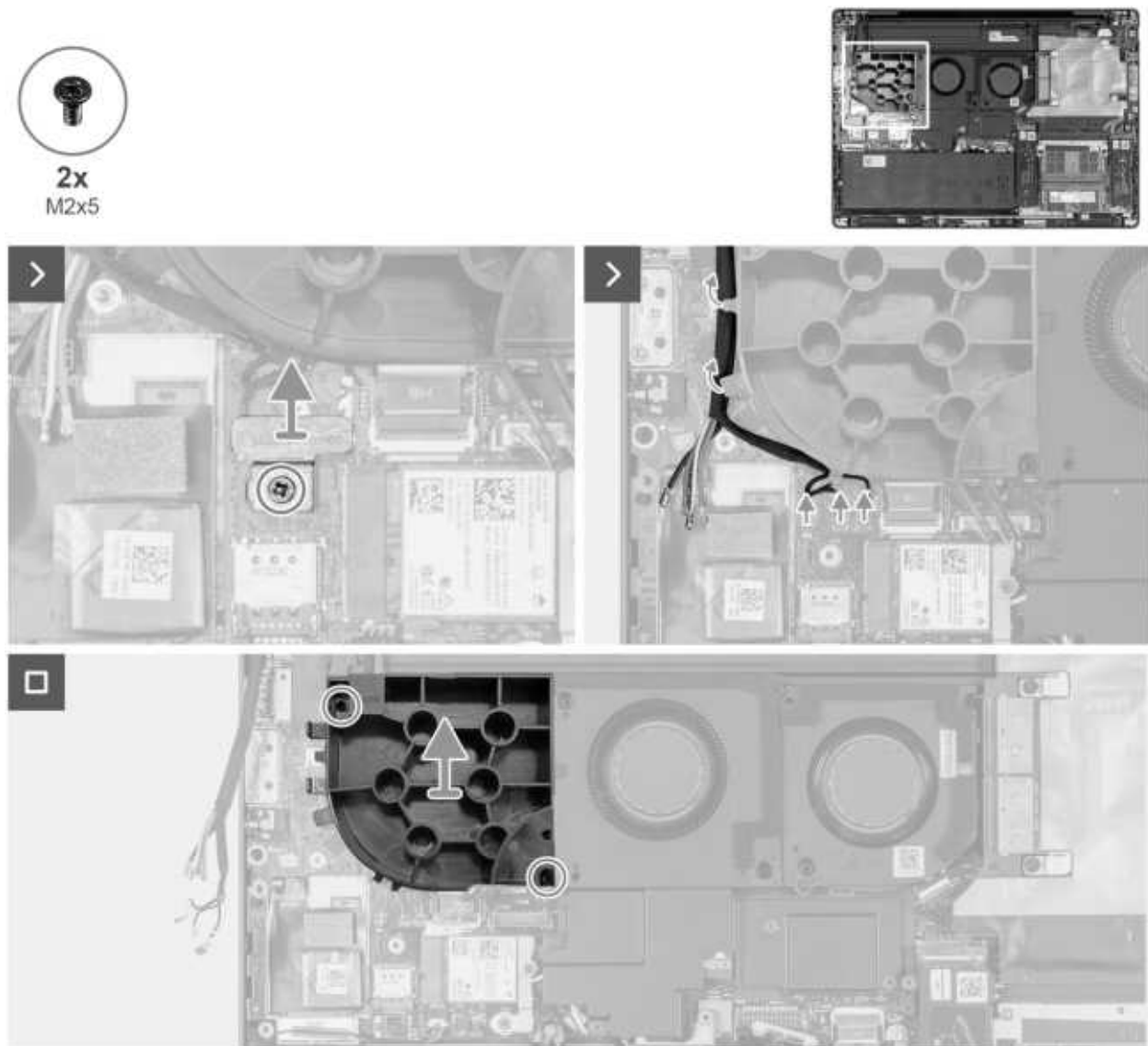
Abbildung 57. Entfernen des Dummy-Lüfters
