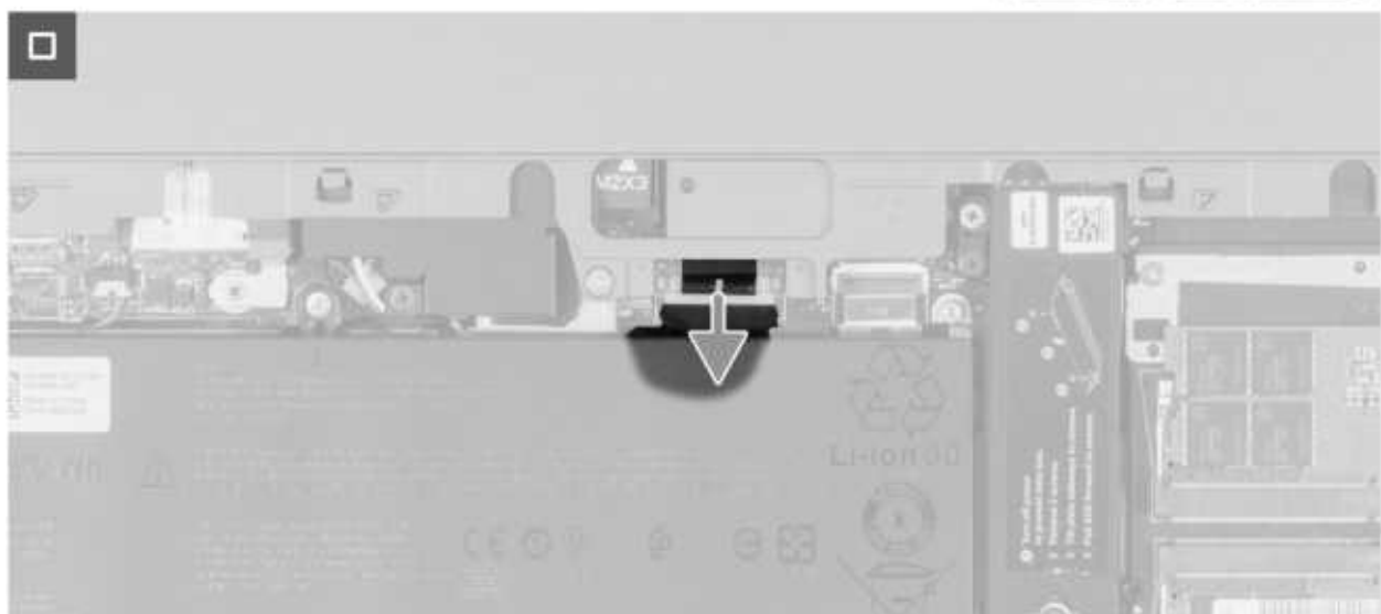
Abbildung 20. Trennen des Akkukabels
