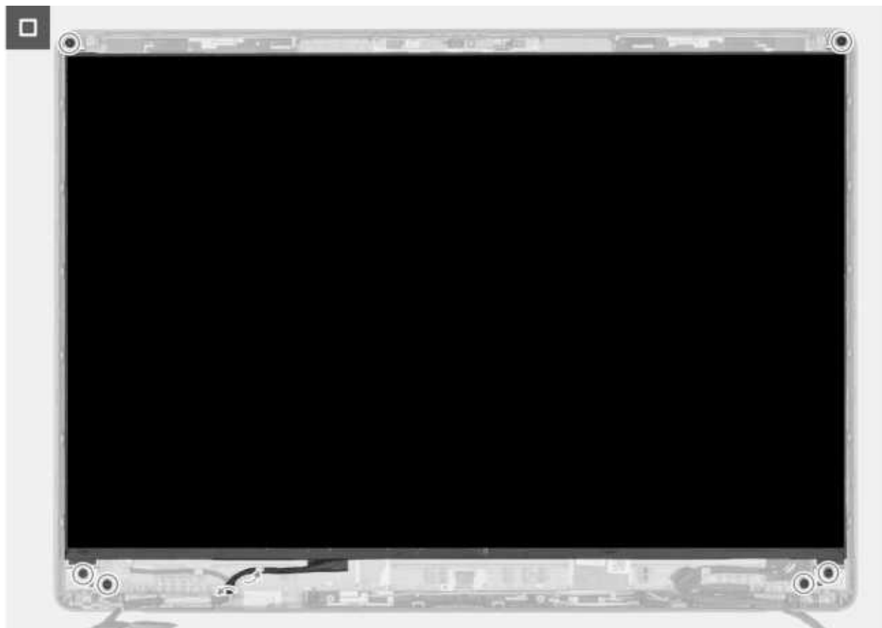
Abbildung 101. Einbauen des Bildschirms bei Bildschirmen ohne Touchscreen
