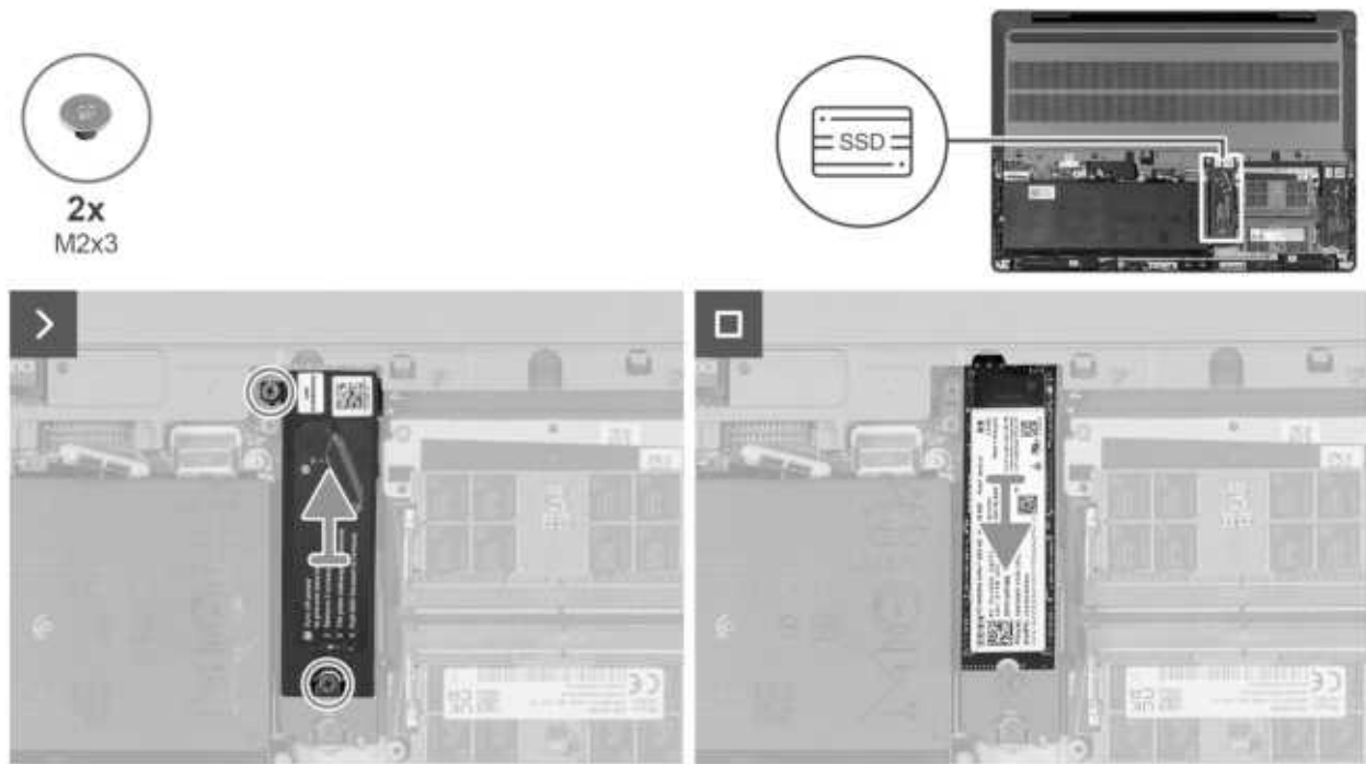
Abbildung 34. Entfernen der M.2-2280-SSD aus Steckplatz 3 (SSD3)
