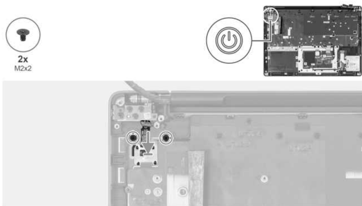
Abbildung 131. Installieren des Netzschalters
