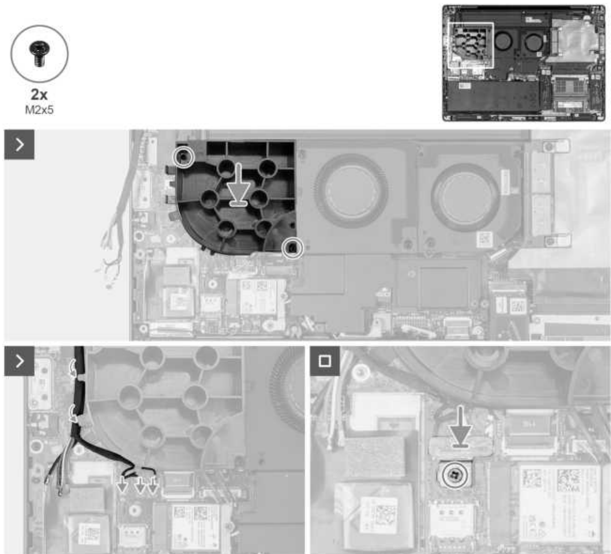
Abbildung 58. Einbauen des Dummy-Lüfters
