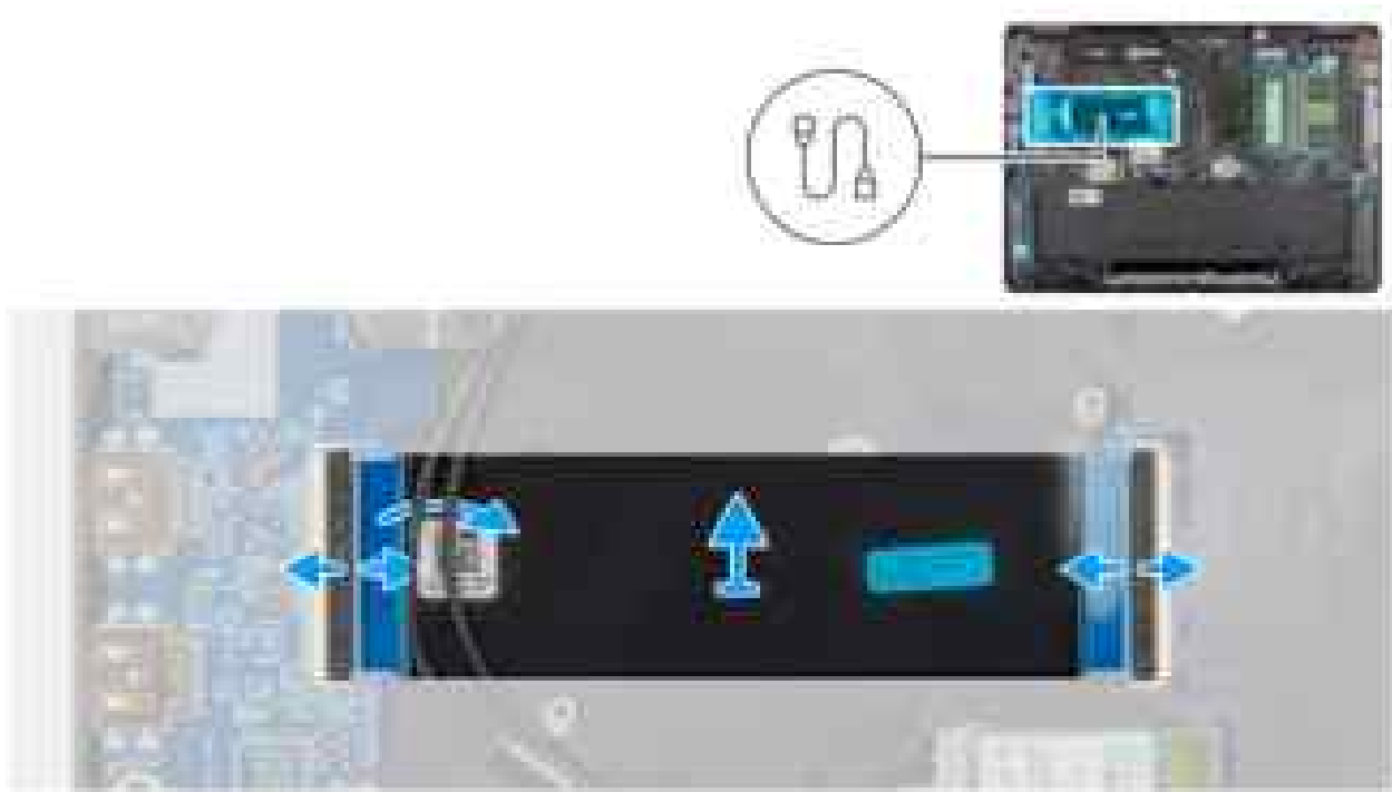
Abbildung 53. Entfernen der FPC der I/O-Platine
