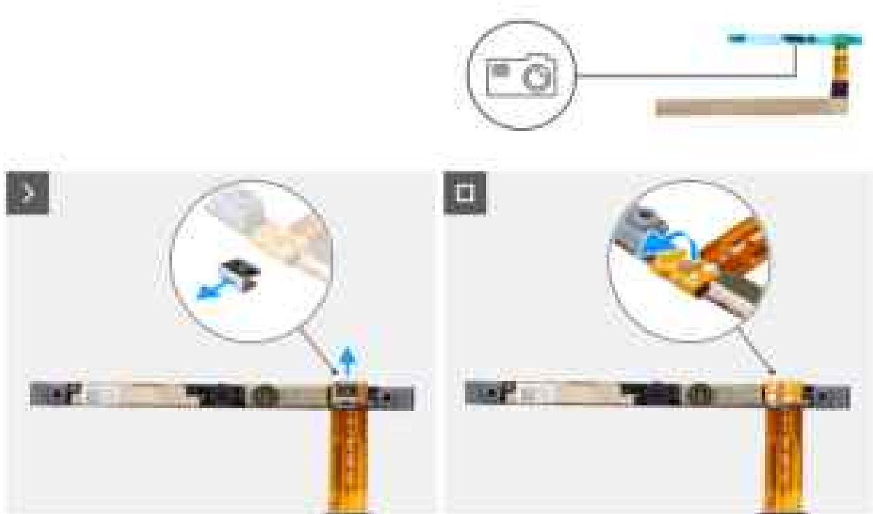
Abbildung 119. Entfernen der Kamera
