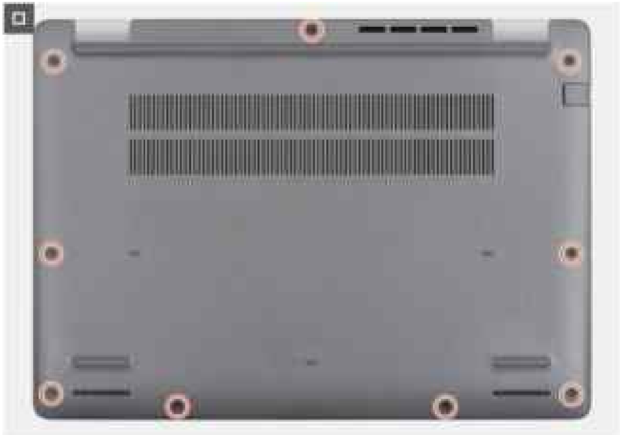
Abbildung 16. Anbringen der Bodenabdeckung
