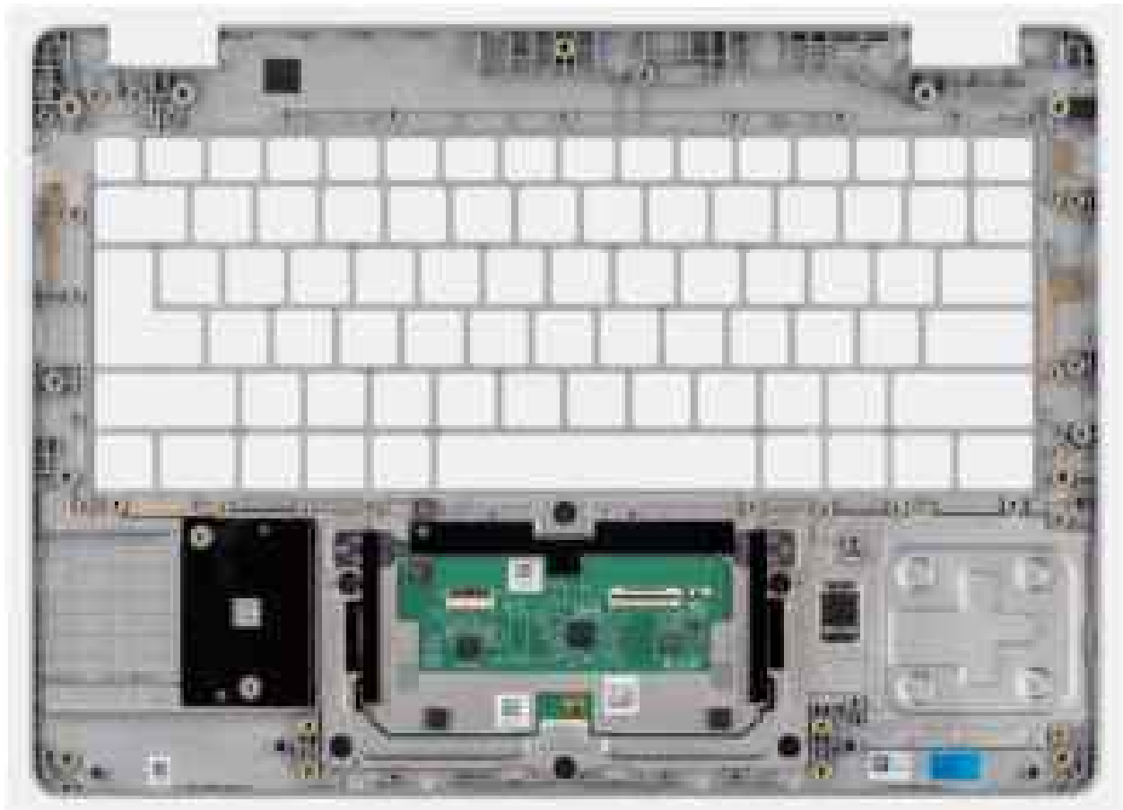
Abbildung 97. Entfernen der Handballenstütze und Baugruppe
