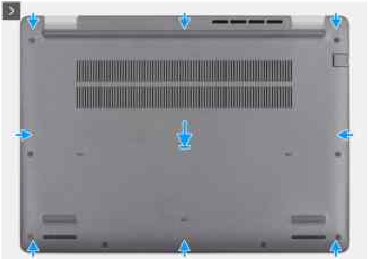
Abbildung 15. Anbringen der Bodenabdeckung
