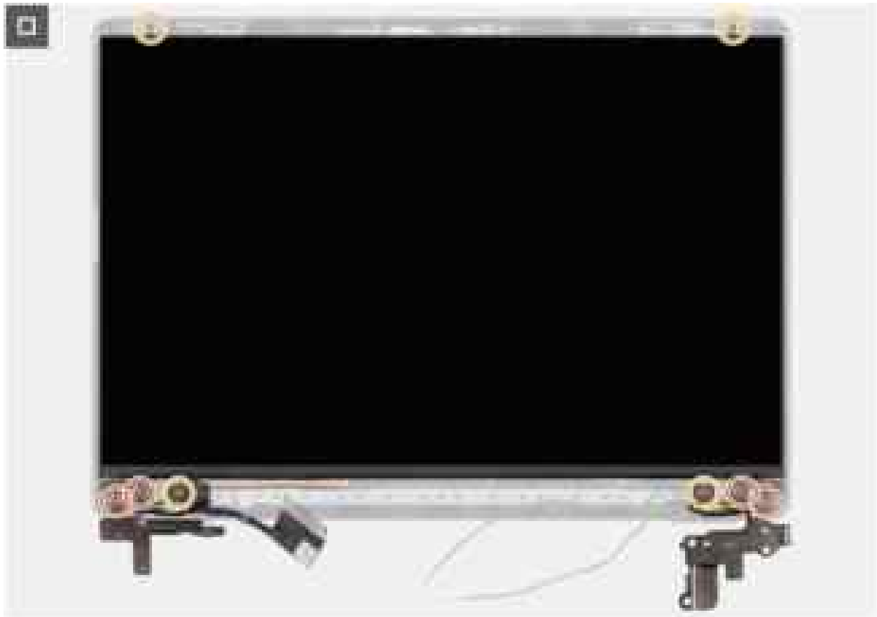
Abbildung 118. Installieren der Bildschirmbaugruppe
