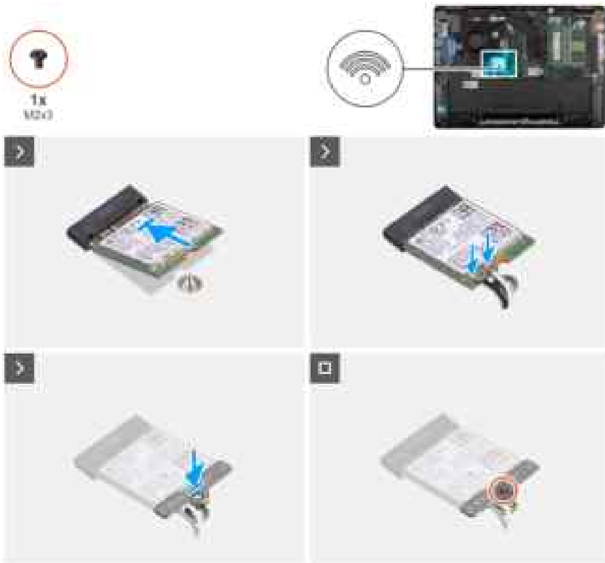
Abbildung 26. Installieren der Wireless-Karte
