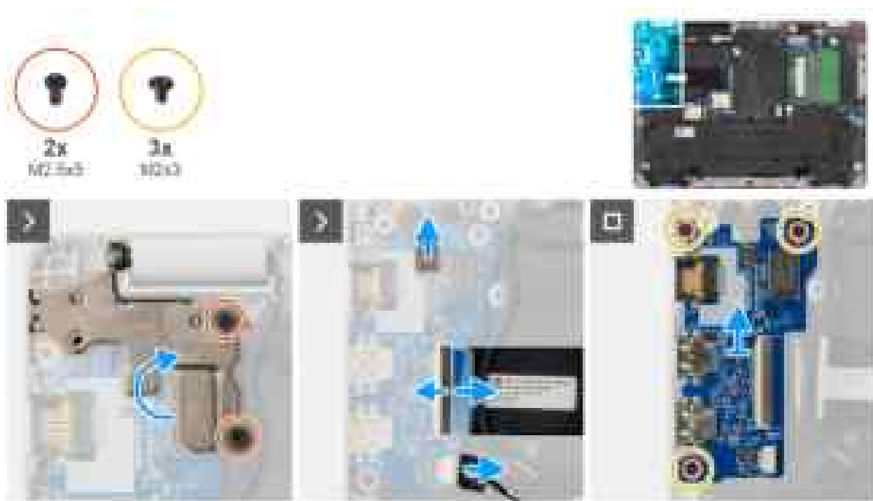
Abbildung 51. Entfernen der E/A-Platine
