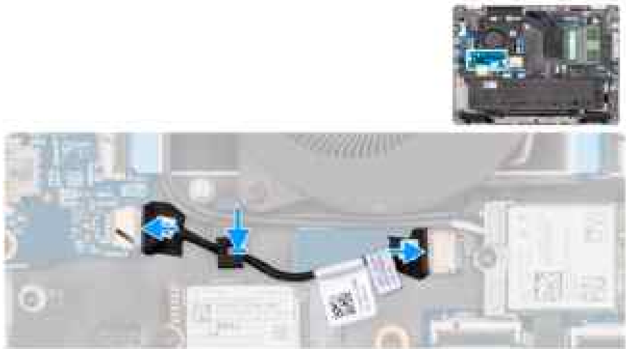
Abbildung 48. Einbauen des vPro-Kabels
