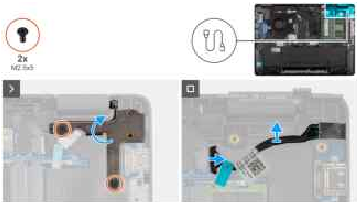
Abbildung 41. Entfernen des Netzadapteranschlusses
