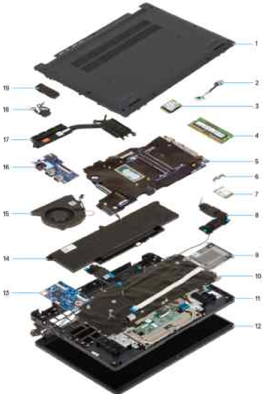
Abbildung 10. Hauptkomponenten des Systems/Explosionsansicht
