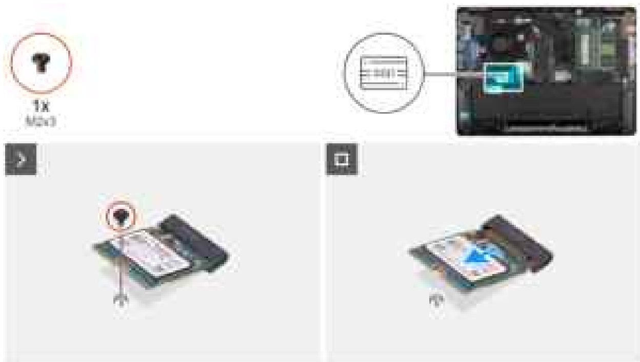
Abbildung 23. Entfernen des SSD
