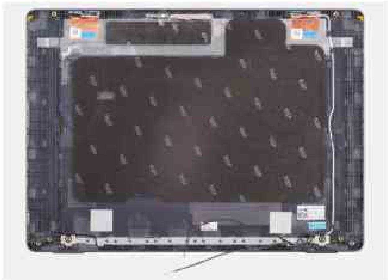
Abbildung 124. Einbauen der Baugruppe der hinteren Bildschirmabdeckung
