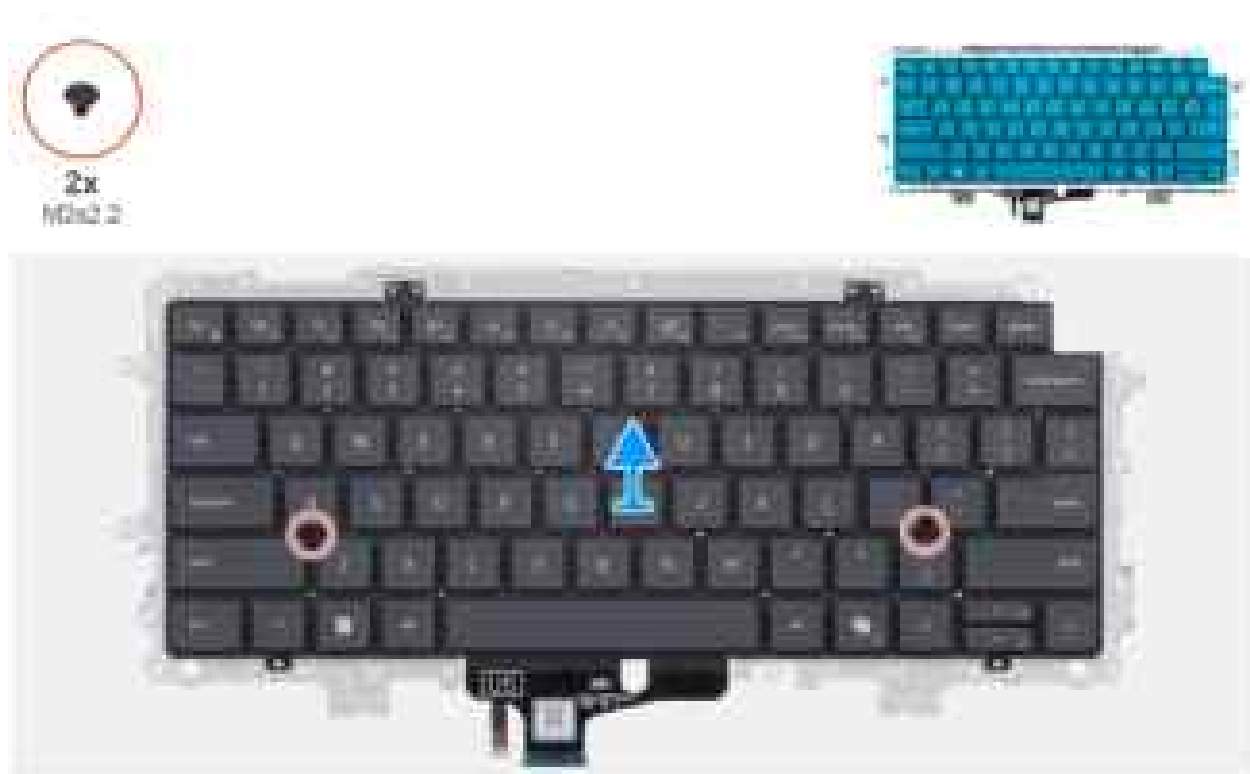
Abbildung 91. Entfernen der Tastaturauflage
