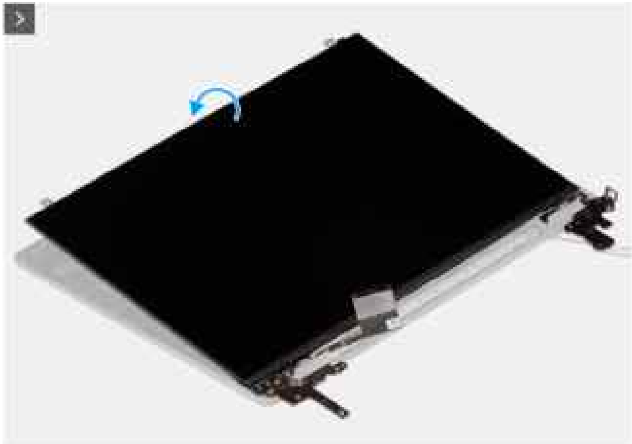
Abbildung 117. Installieren der Bildschirmbaugruppe
