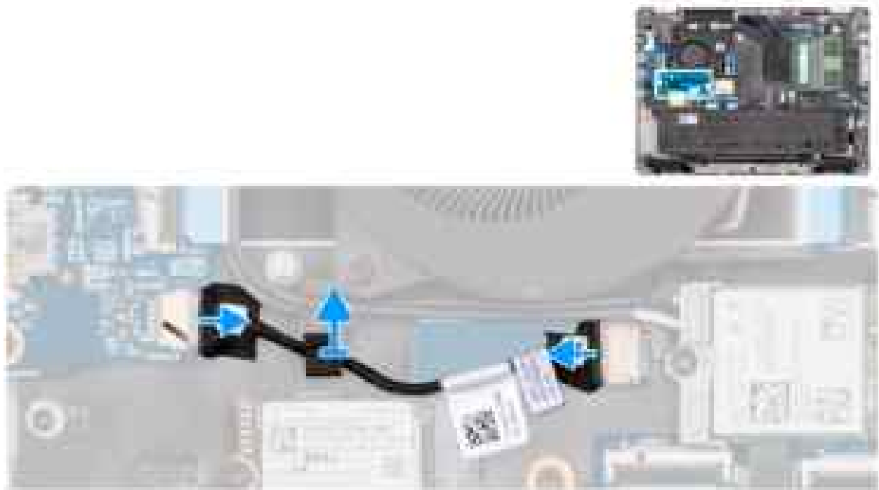
Abbildung 47. Entfernen des vPro-Kabels
