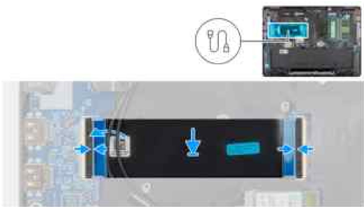
Abbildung 54. Einbauen der FPC der I/O-Platine
