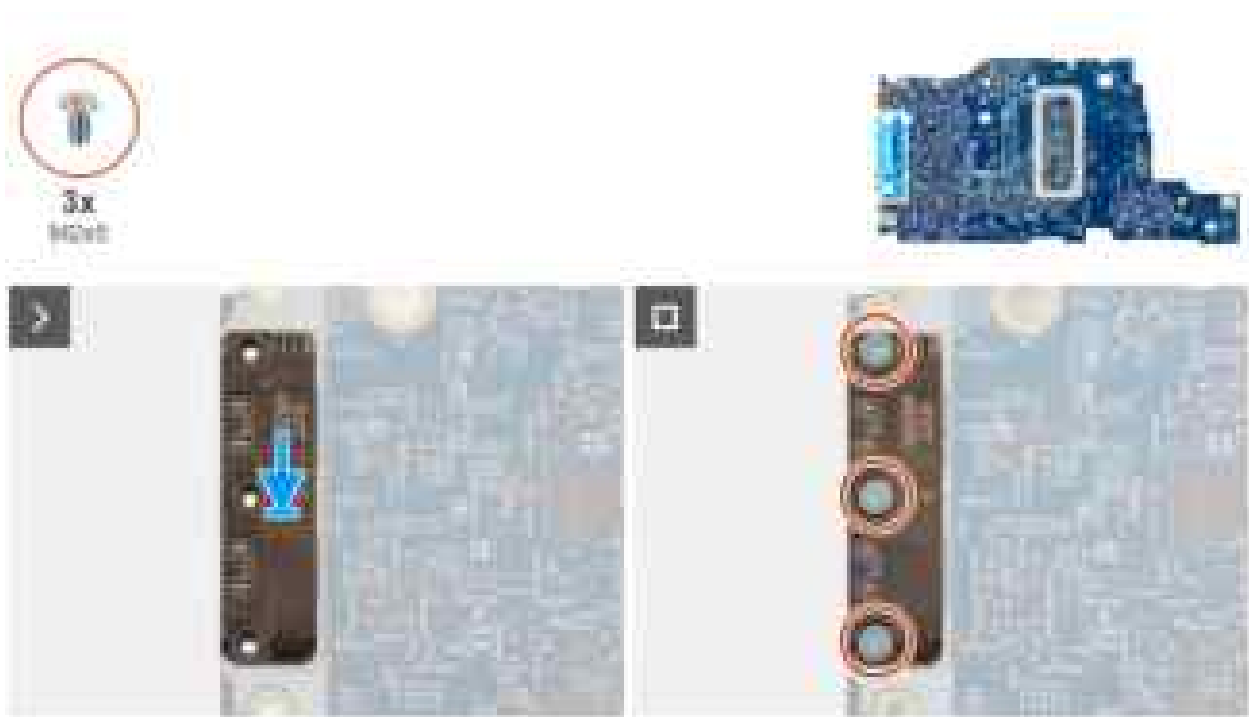
Abbildung 78. Installieren des USB-Typ-C-Moduls
