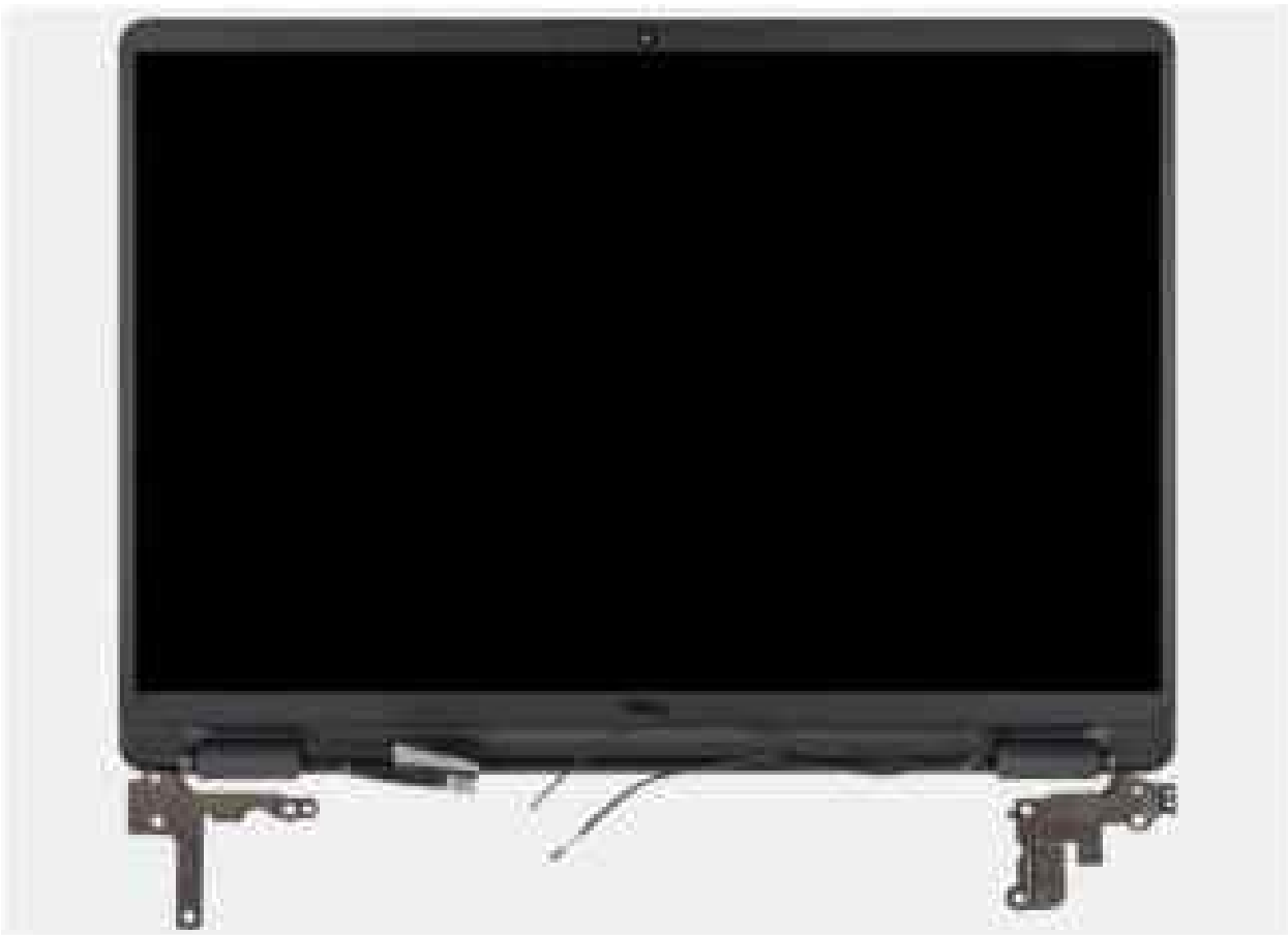
Abbildung 101. Entfernen der Bildschirmbaugruppe
