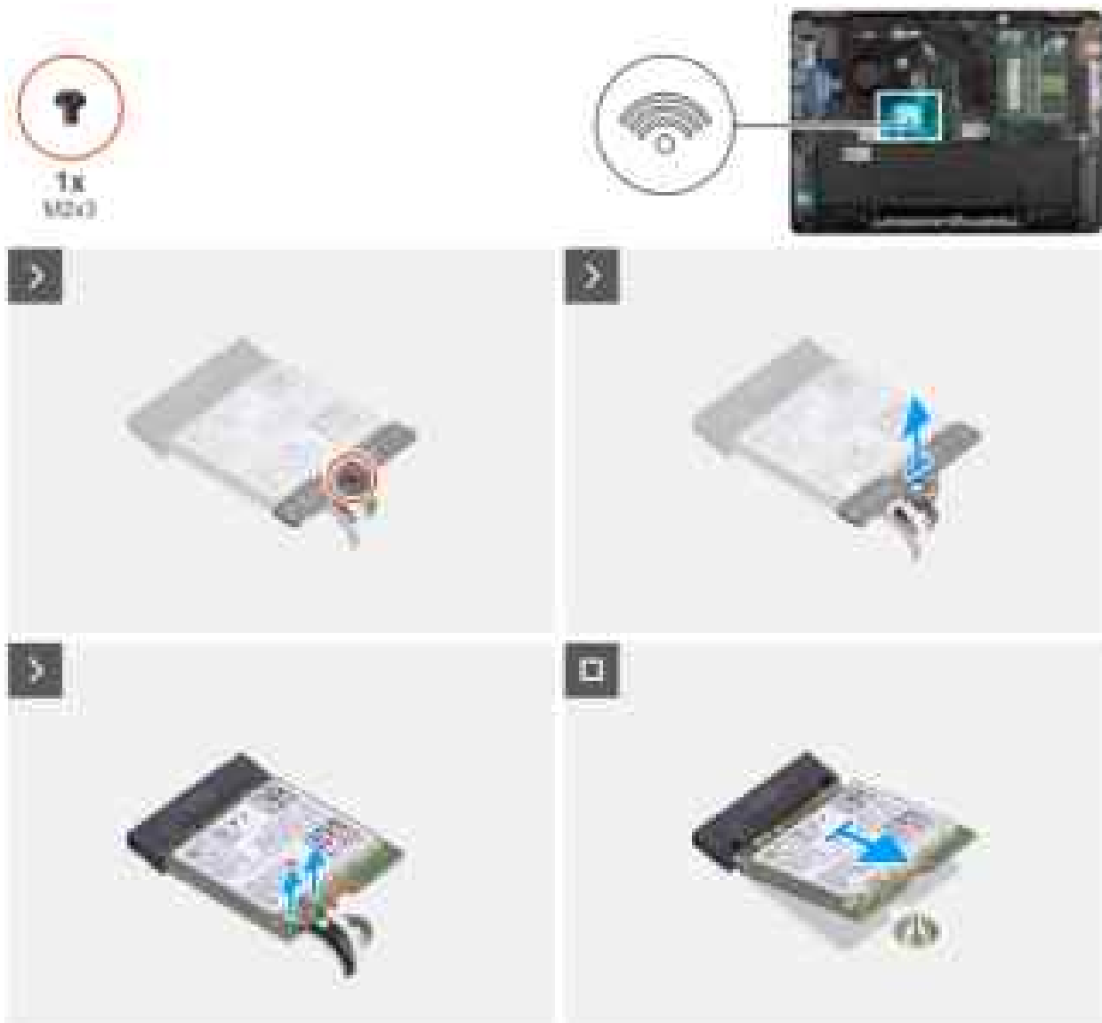
Abbildung 25. Entfernen der Wireless-Karte
