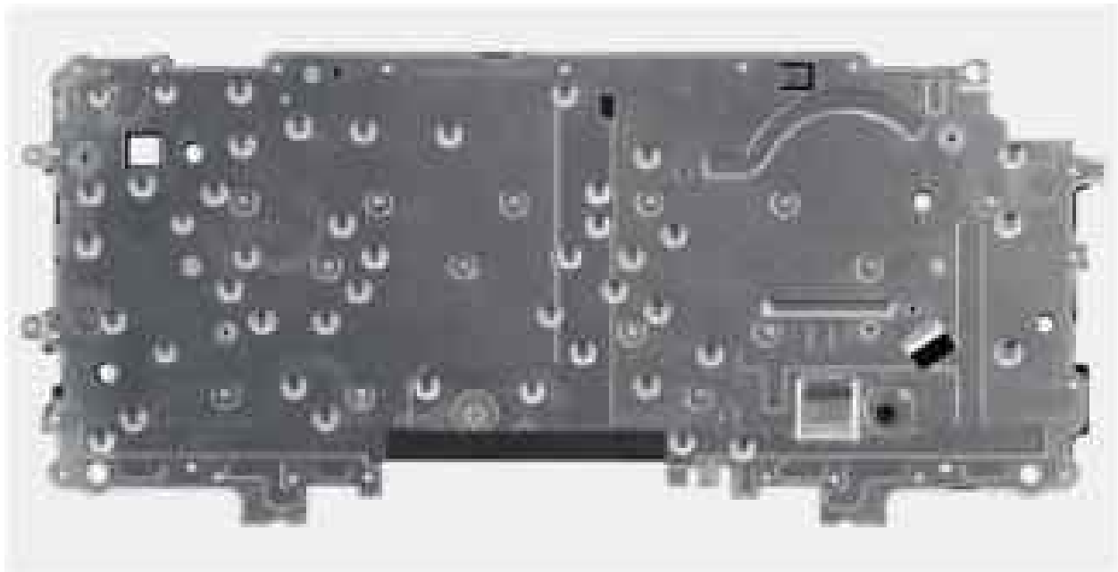
Abbildung 93. Einbauen der Tastaturauflage
