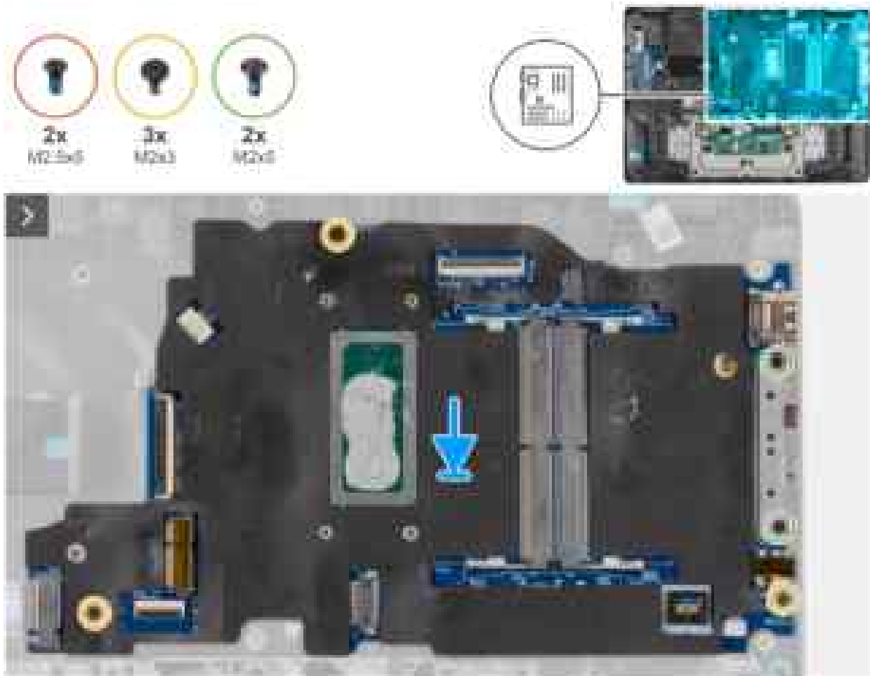
Abbildung 61. Einbauen der Systemplatine
