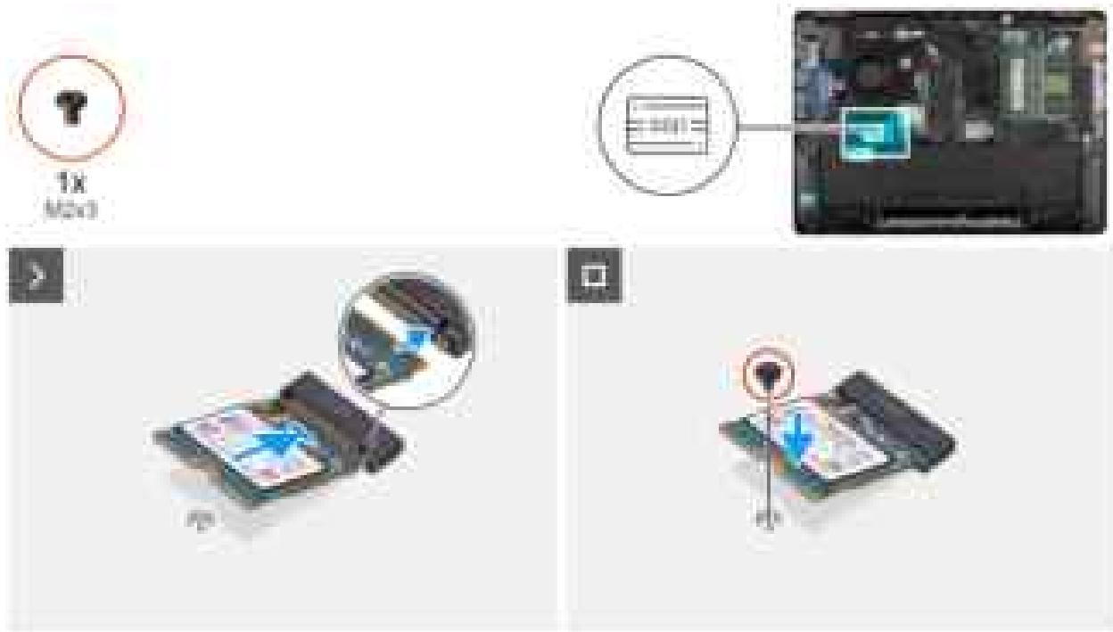
Abbildung 24. Einbauen der SSD-Karte
