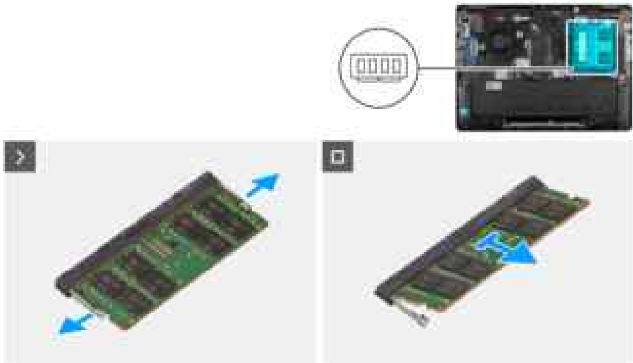
Abbildung 21. Entfernen des Arbeitsspeichermoduls
