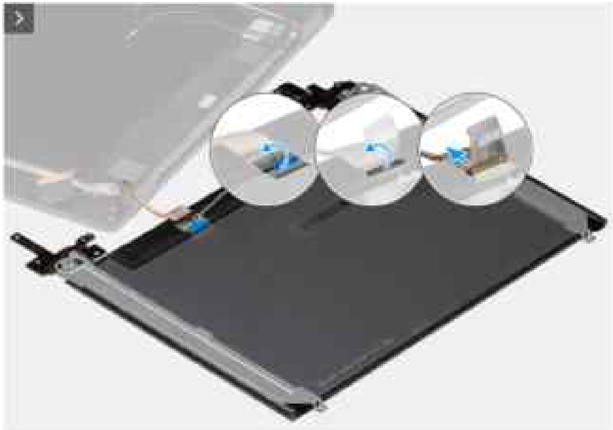
Abbildung 113. Entfernen der Bildschirmbaugruppe
