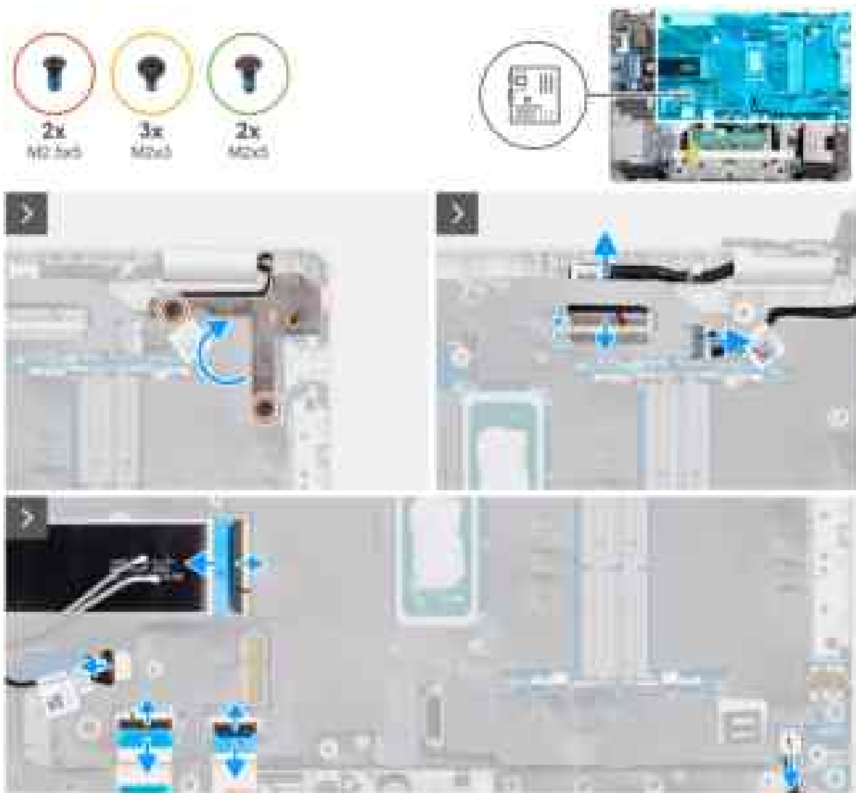
Abbildung 70. Entfernen der Systemplatine
