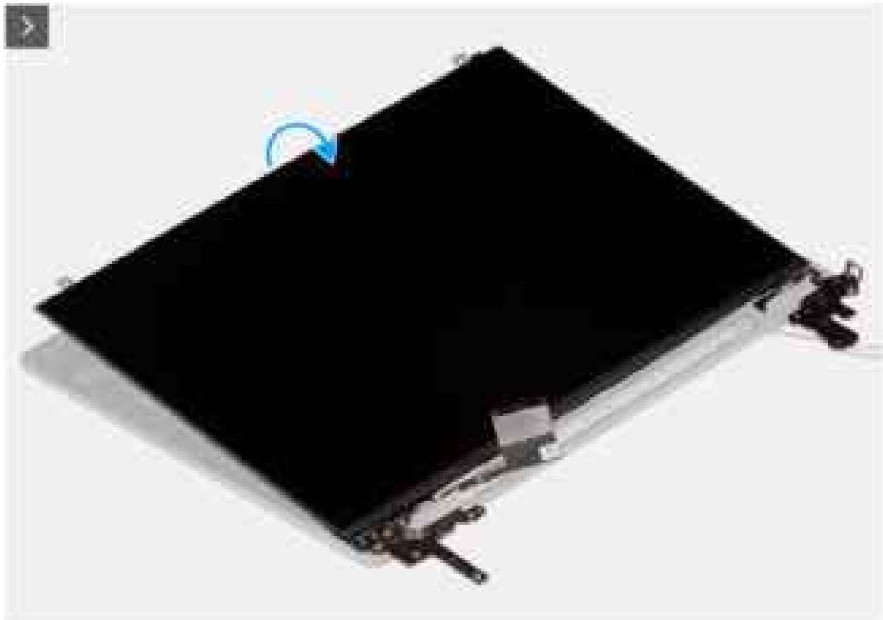
Abbildung 112. Entfernen der Bildschirmbaugruppe
