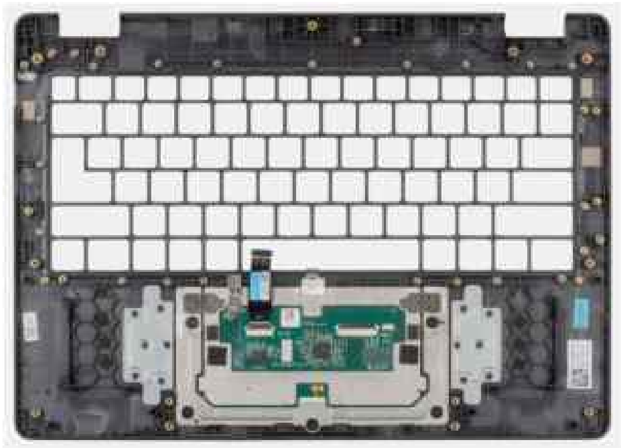
Abbildung 95. Entfernen der Handballenstütze und Baugruppe
