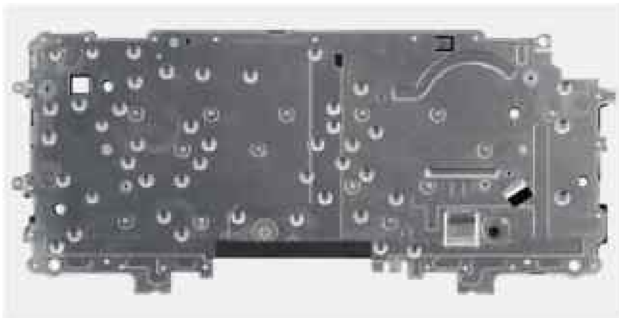
Abbildung 92. Entfernen der Tastaturauflage
