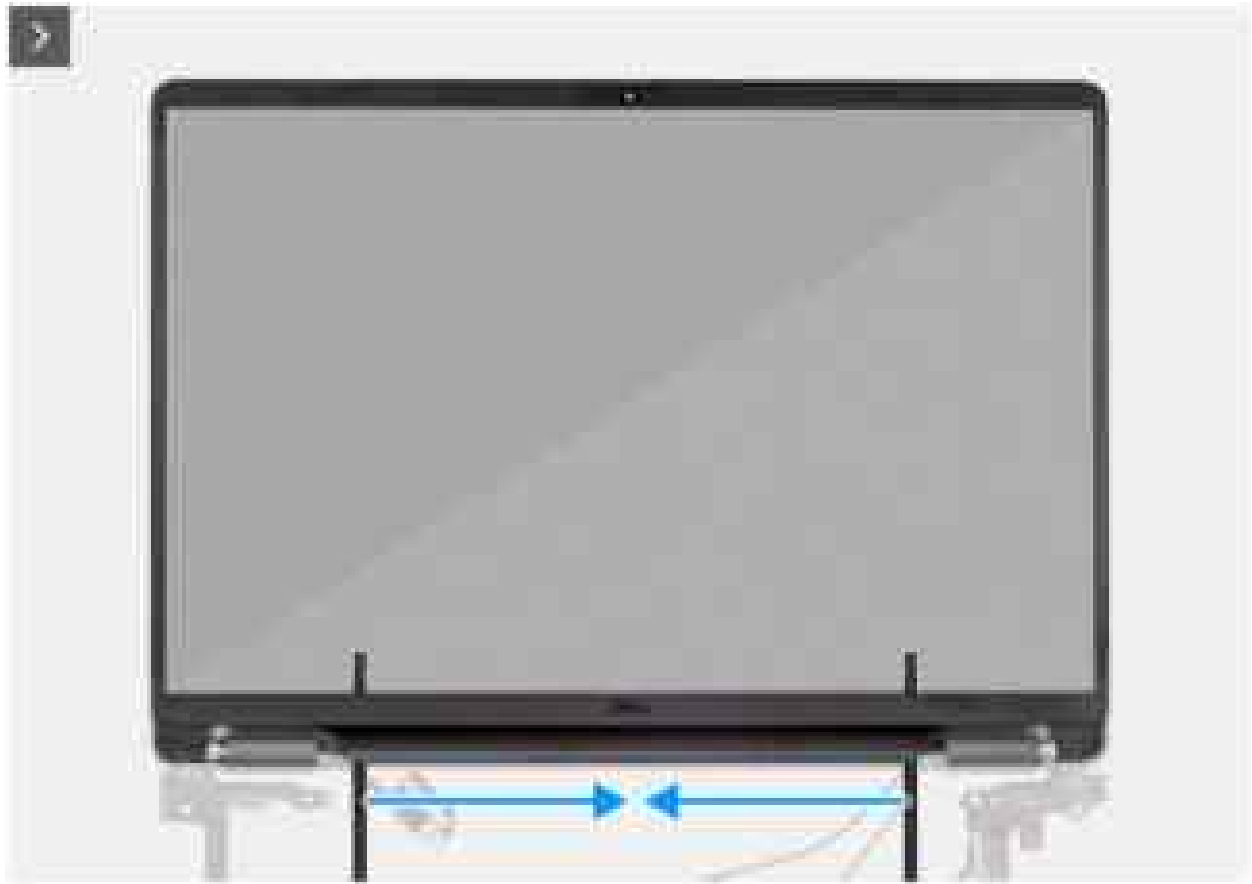
Abbildung 105. Entfernen der Bildschirmblende
