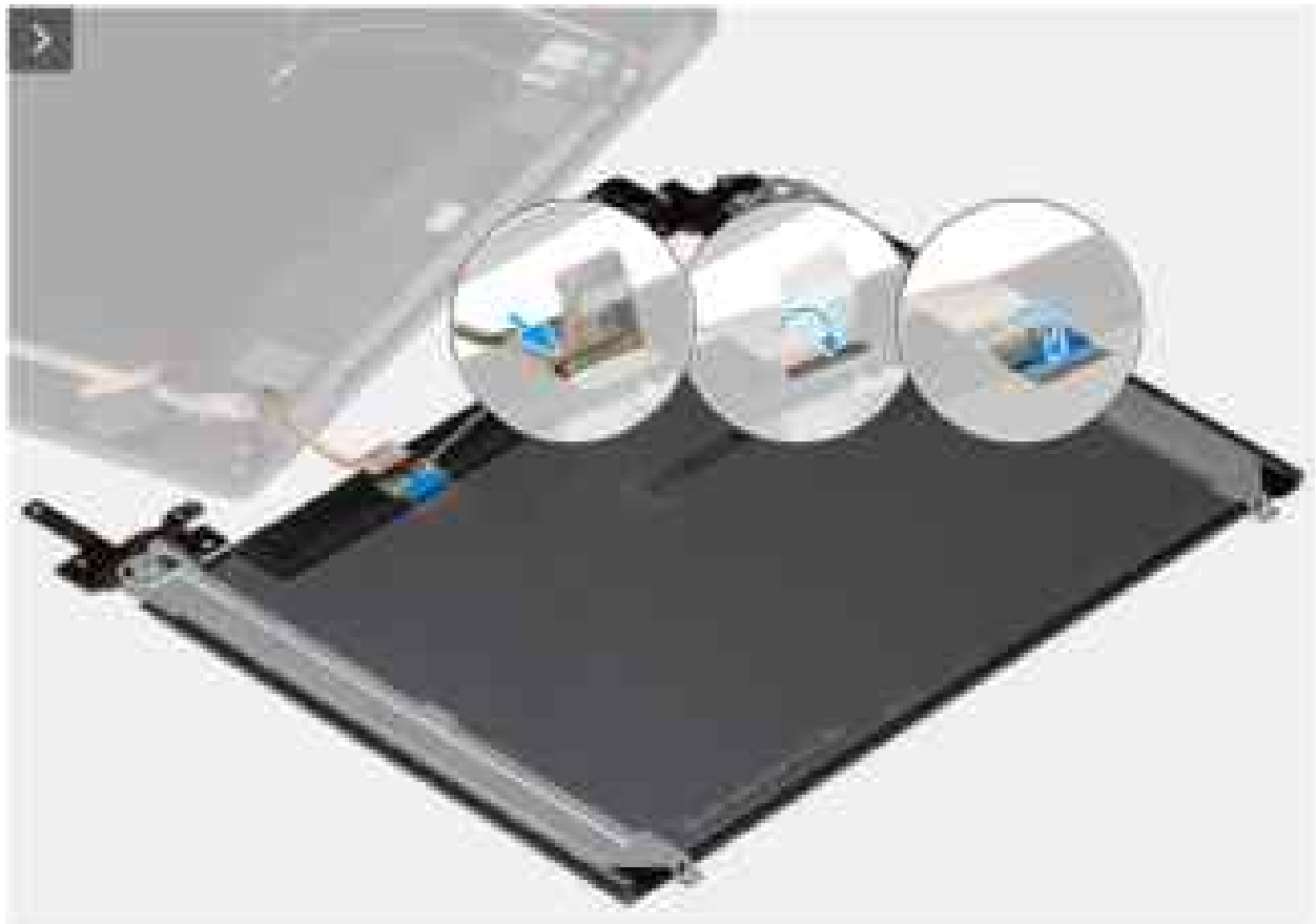
Abbildung 116. Installieren der Bildschirmbaugruppe
