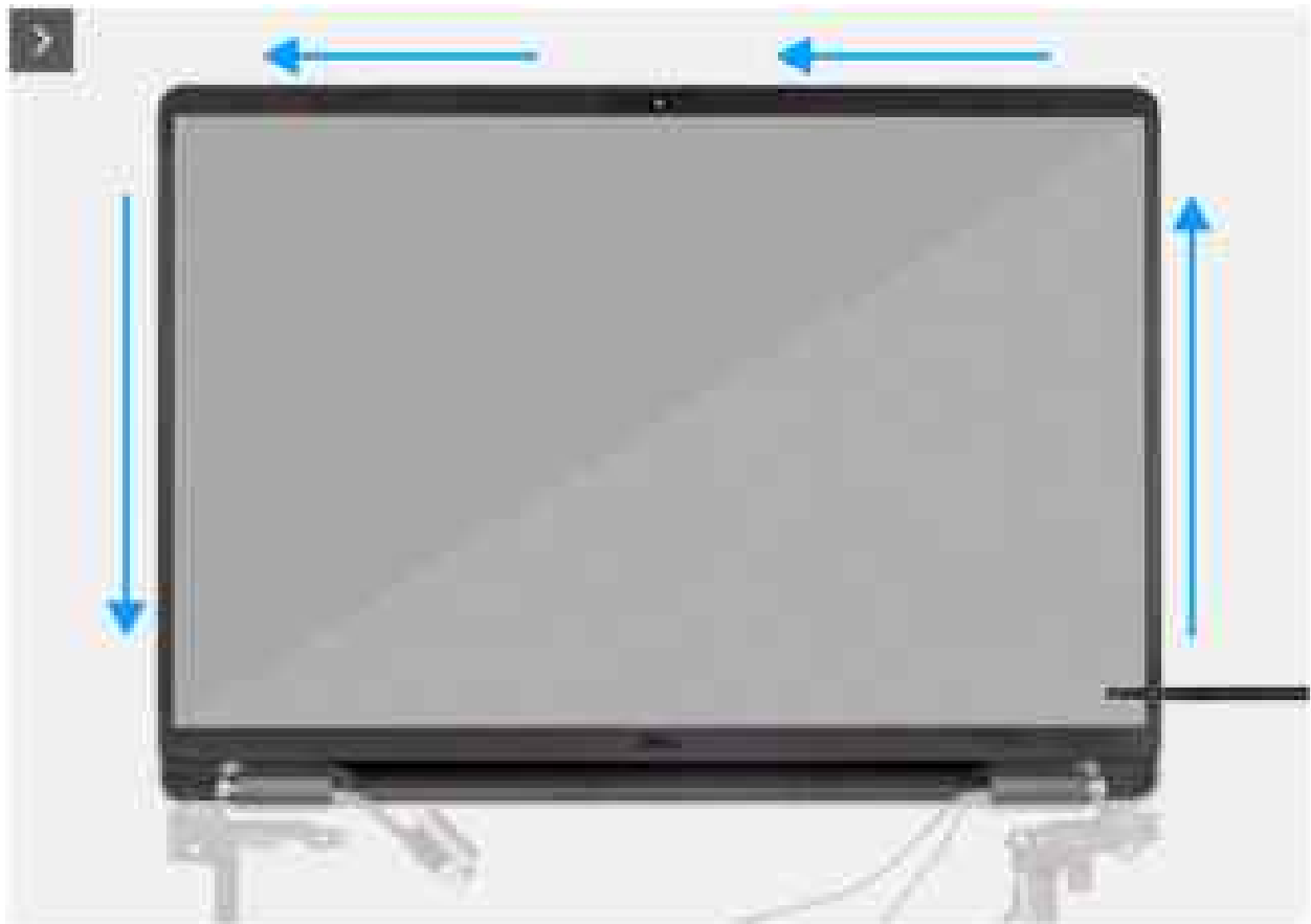
Abbildung 107. Entfernen der Bildschirmblende
