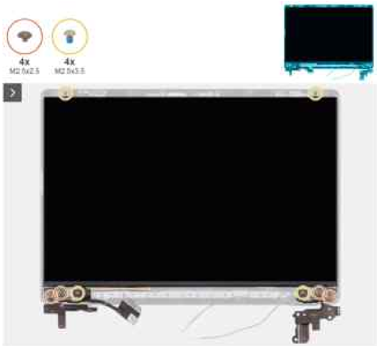
Abbildung 111. Entfernen der Bildschirmbaugruppe
