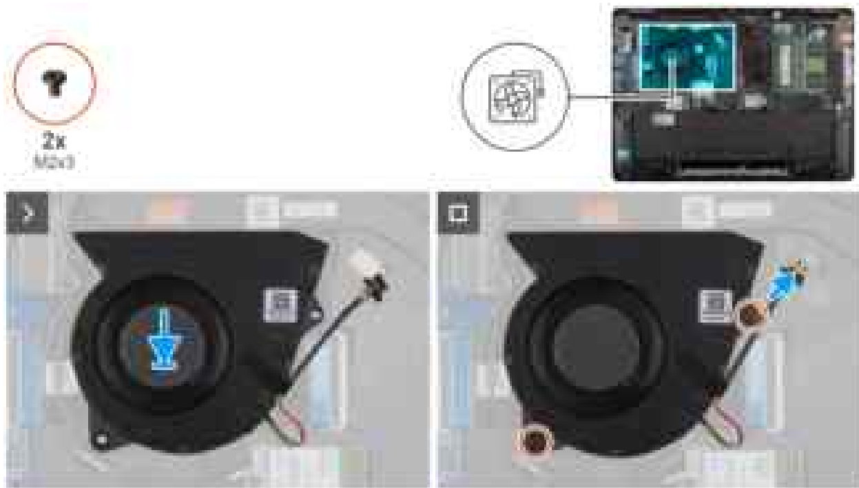
Abbildung 34. Einbauen des Lüfters
