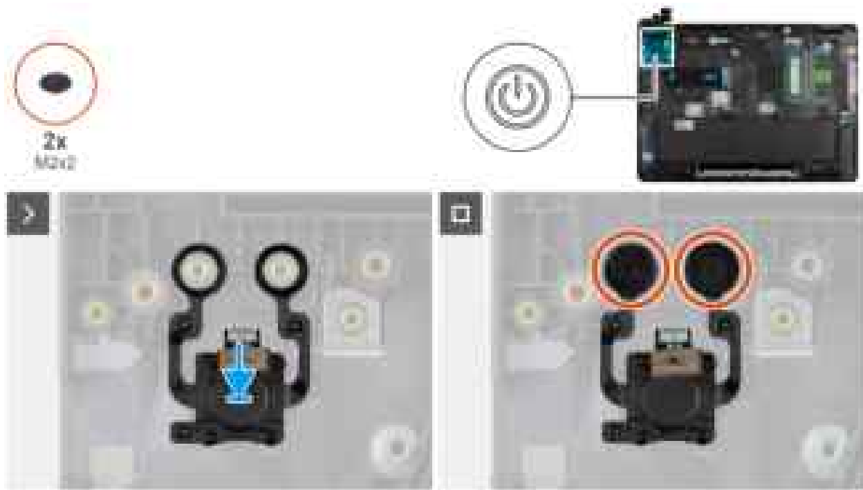
Abbildung 56. Einbauen des Netzschalters mit Fingerabdruck-Lesegerät
