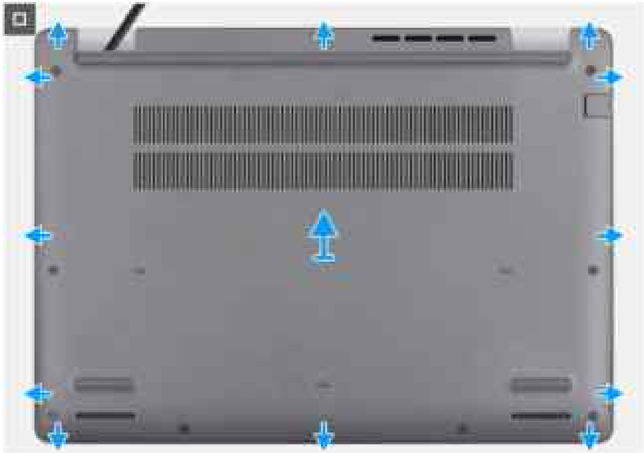
Abbildung 12. Entfernen der Bodenabdeckung
