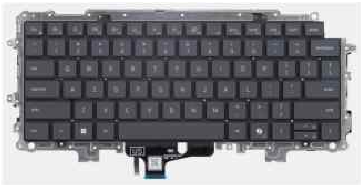
Abbildung 81. Entfernen der Tastatur
