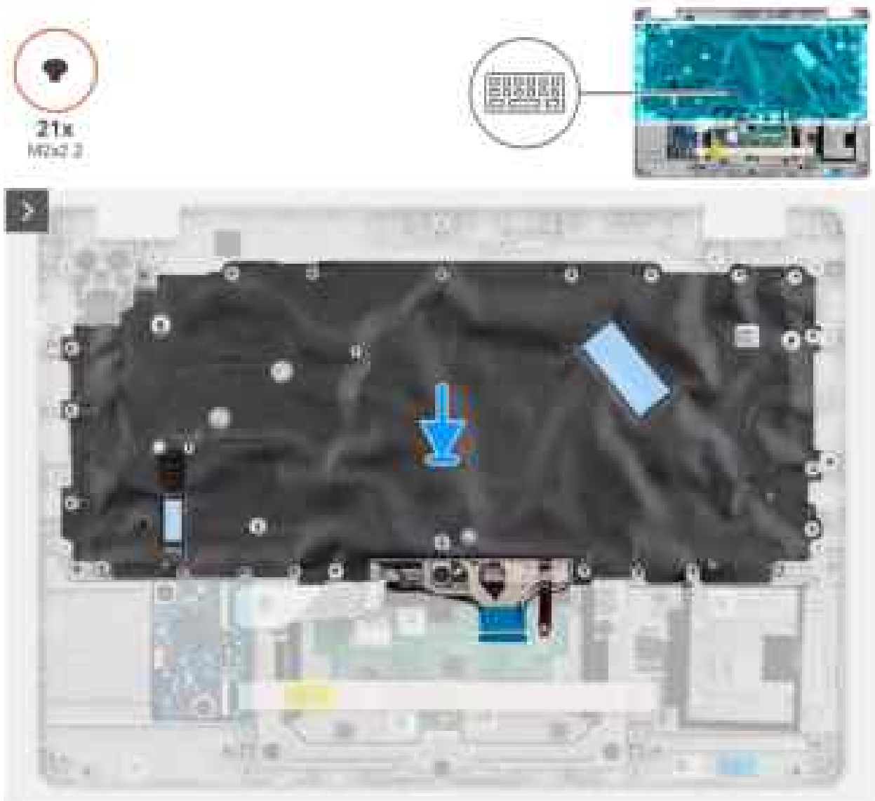
Abbildung 89. Einbauen der Tastatur
