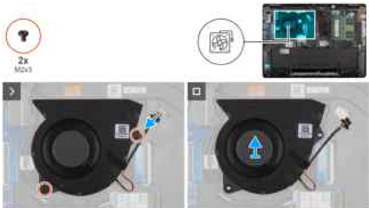
Abbildung 33. Entfernen des Lüfters
