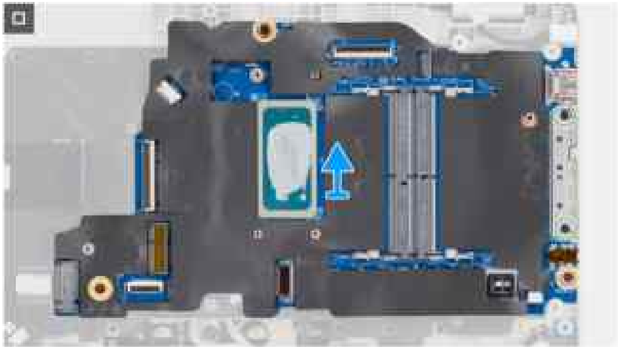
Abbildung 65. Entfernen der Systemplatine
