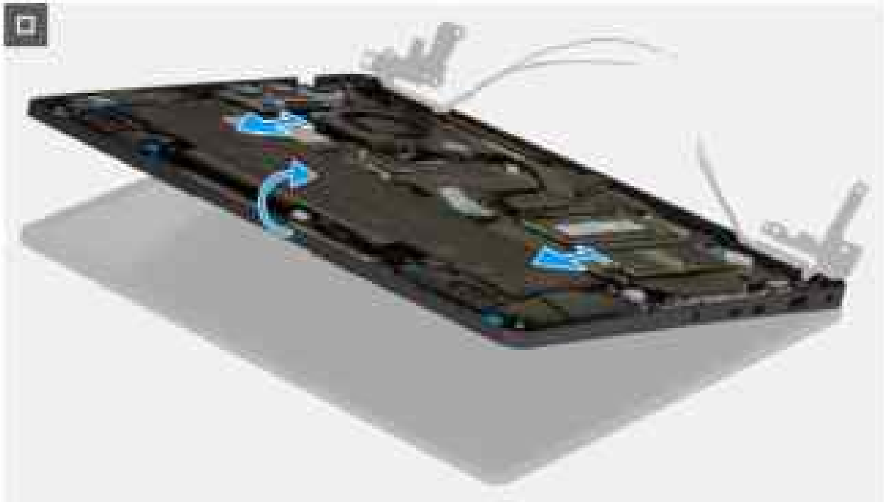
Abbildung 100. Entfernen der Bildschirmbaugruppe
