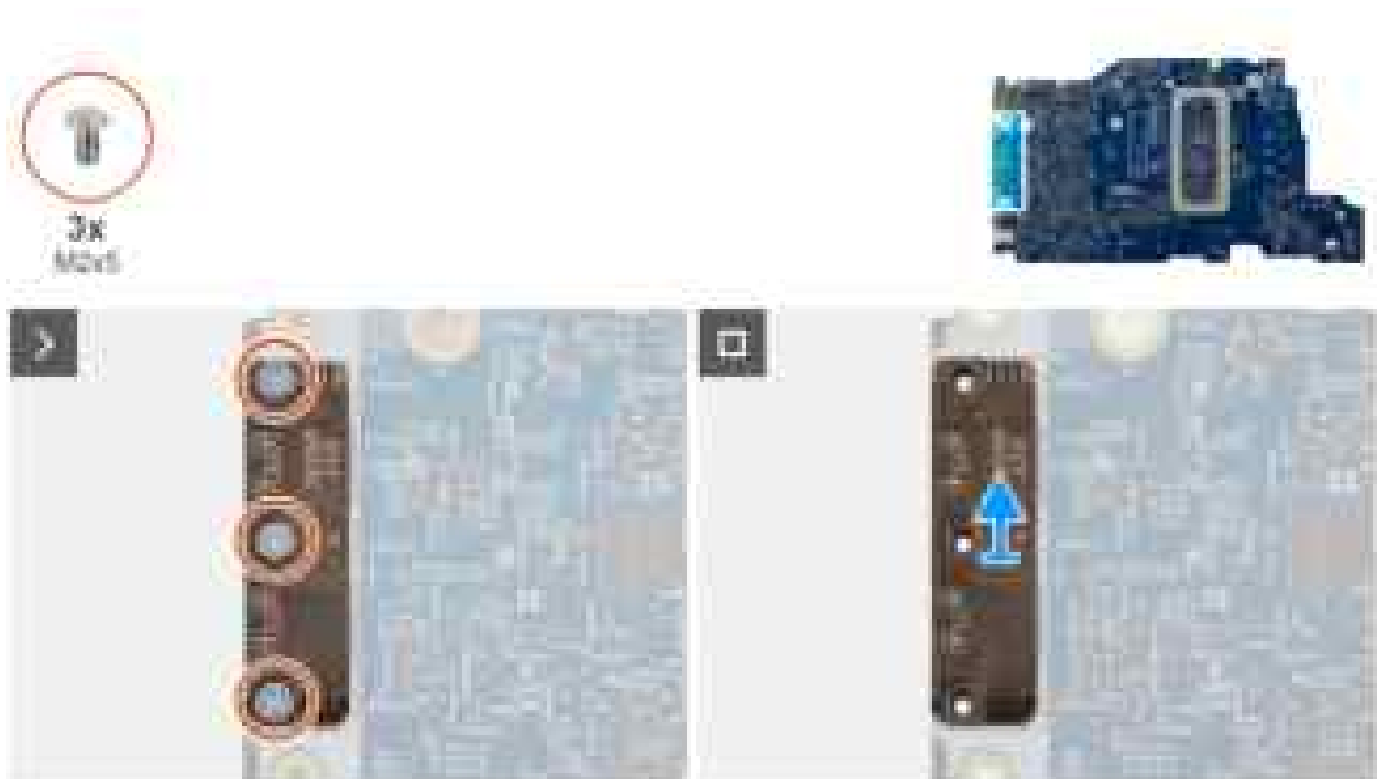
Abbildung 75. Entfernen des USB-Typ-C-Moduls
