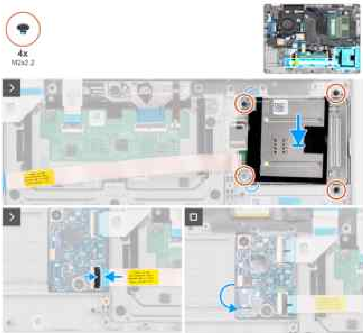
Abbildung 40. Installieren des Smartcardlesegeräts
