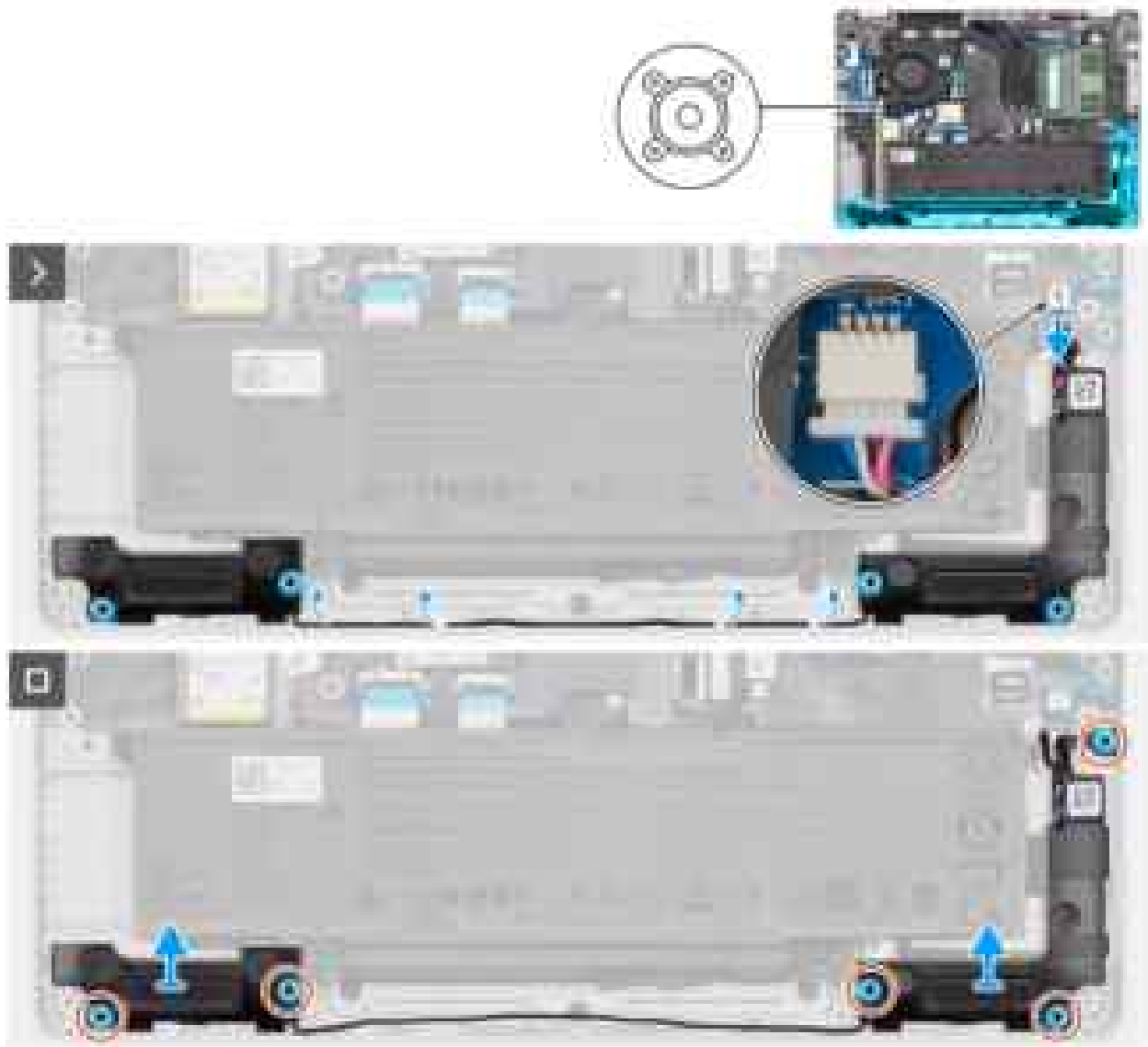
Abbildung 30. Entfernen der Lautsprecher
