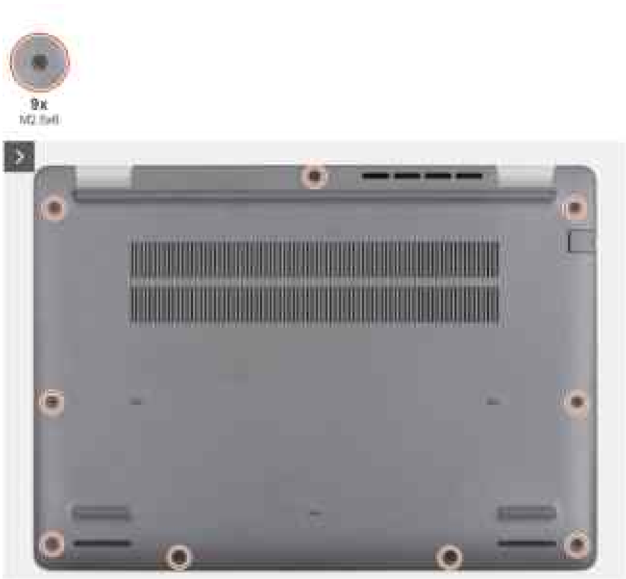
Abbildung 11. Entfernen der Bodenabdeckung
