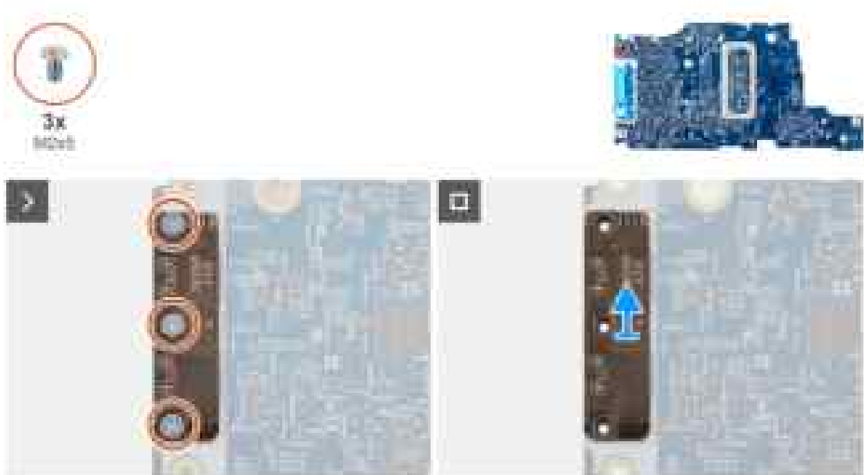
Abbildung 77. Entfernen des USB-Typ-C-Moduls
