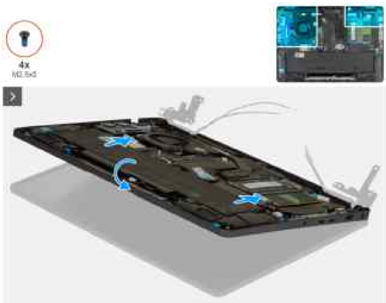
Abbildung 102. Einbauen der Displaybaugruppe
