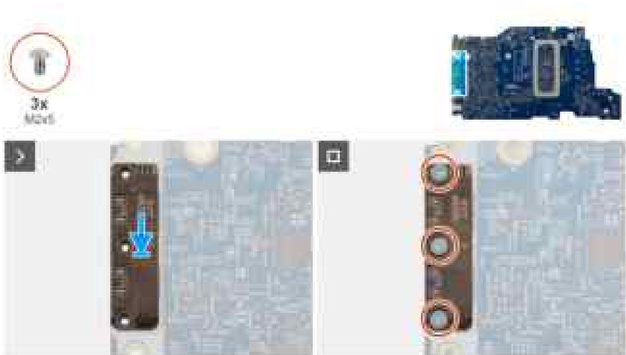
Abbildung 76. Installieren des USB-Typ-C-Moduls
