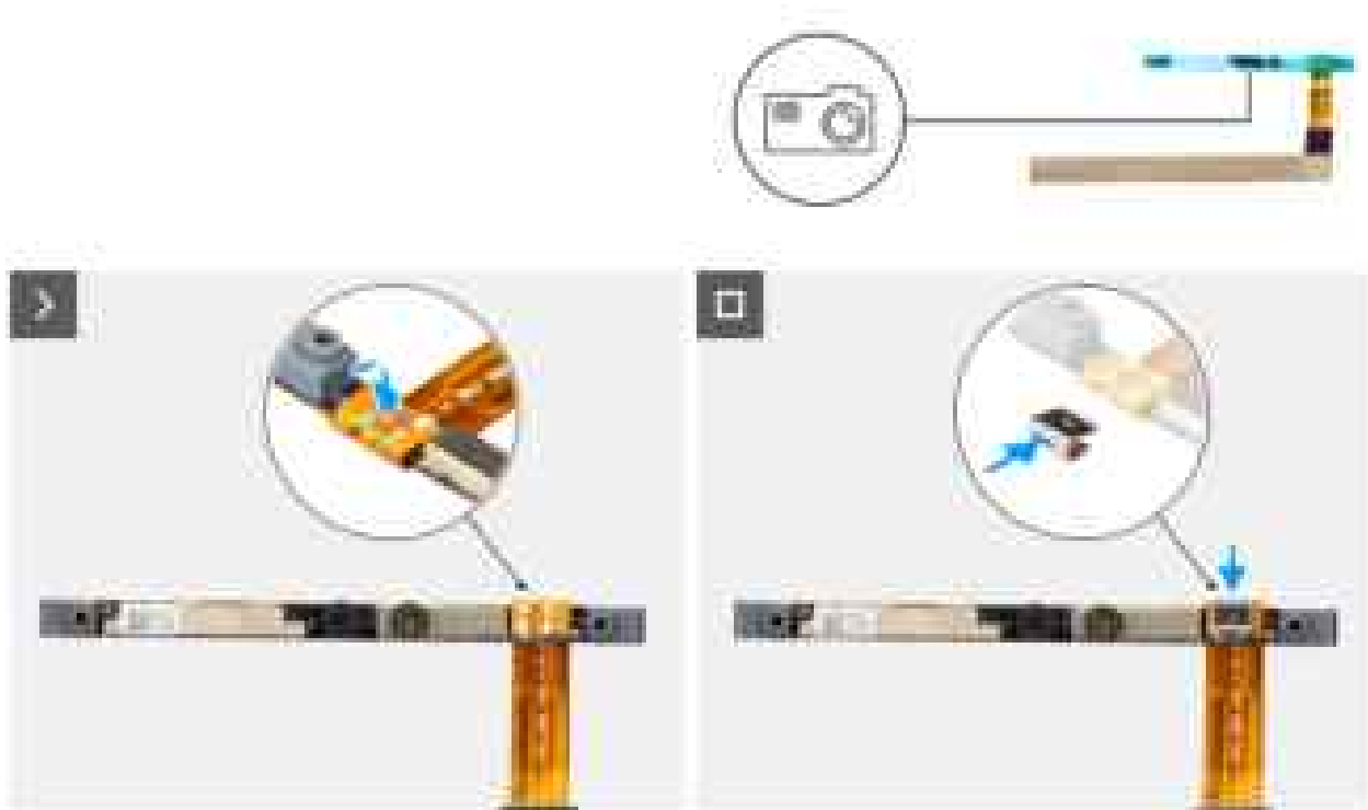
Abbildung 120. Installieren der Kamera
