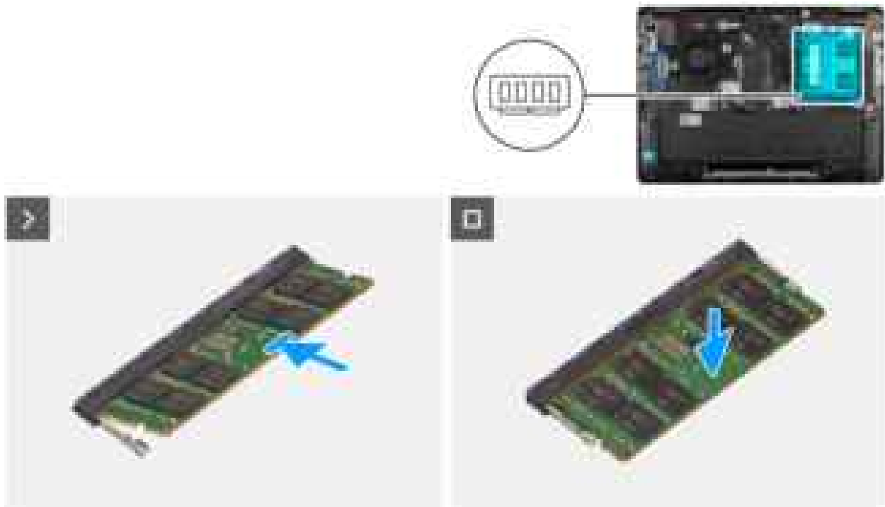
Abbildung 22. Installieren der Speichermodule
