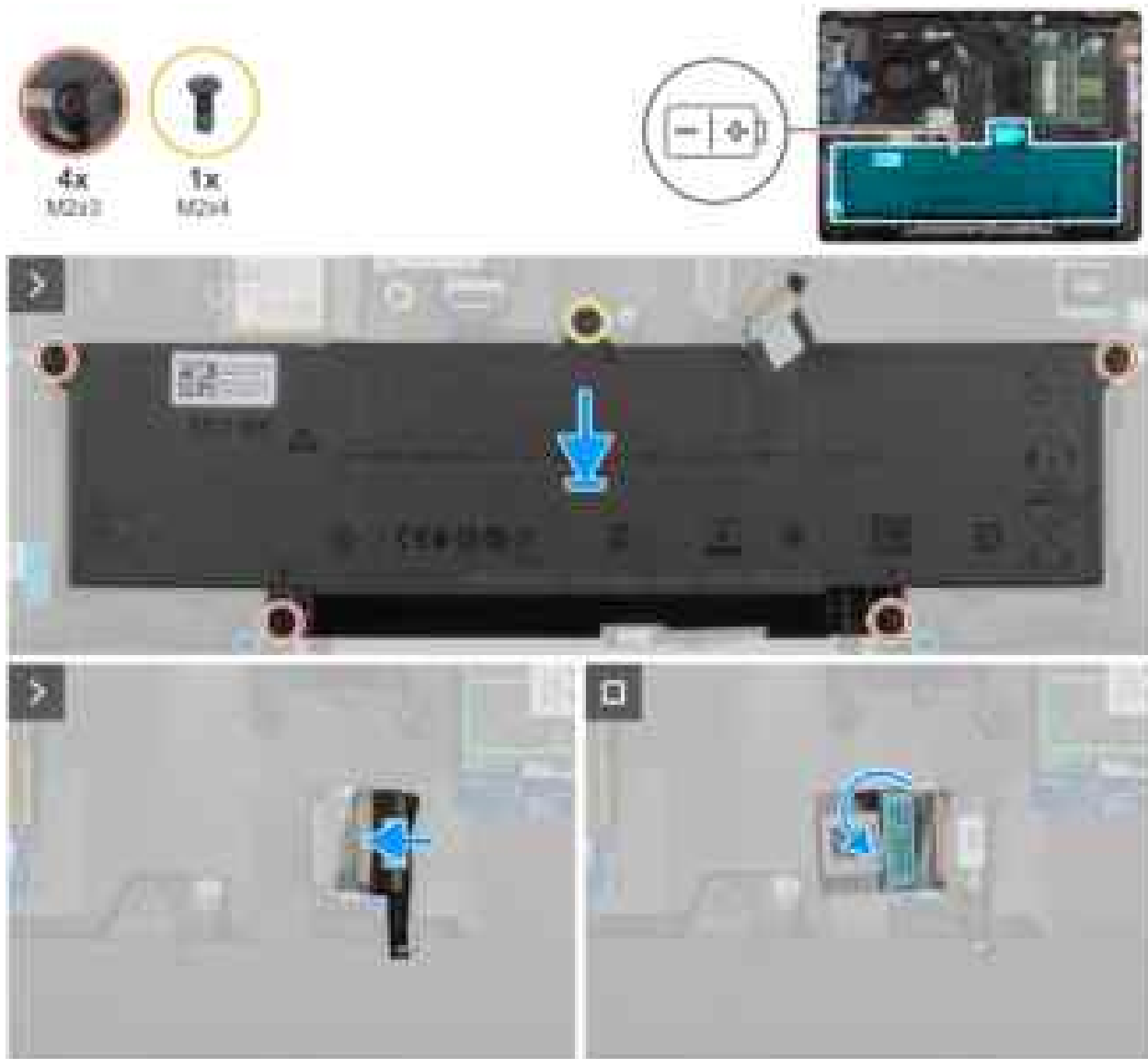
Abbildung 18. Einsetzen des Akkus
