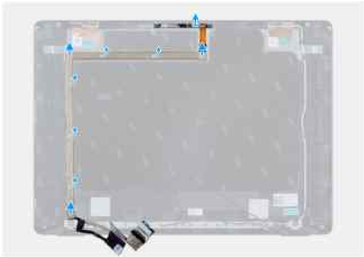
Abbildung 121. Entfernen des eDP-Kabels
