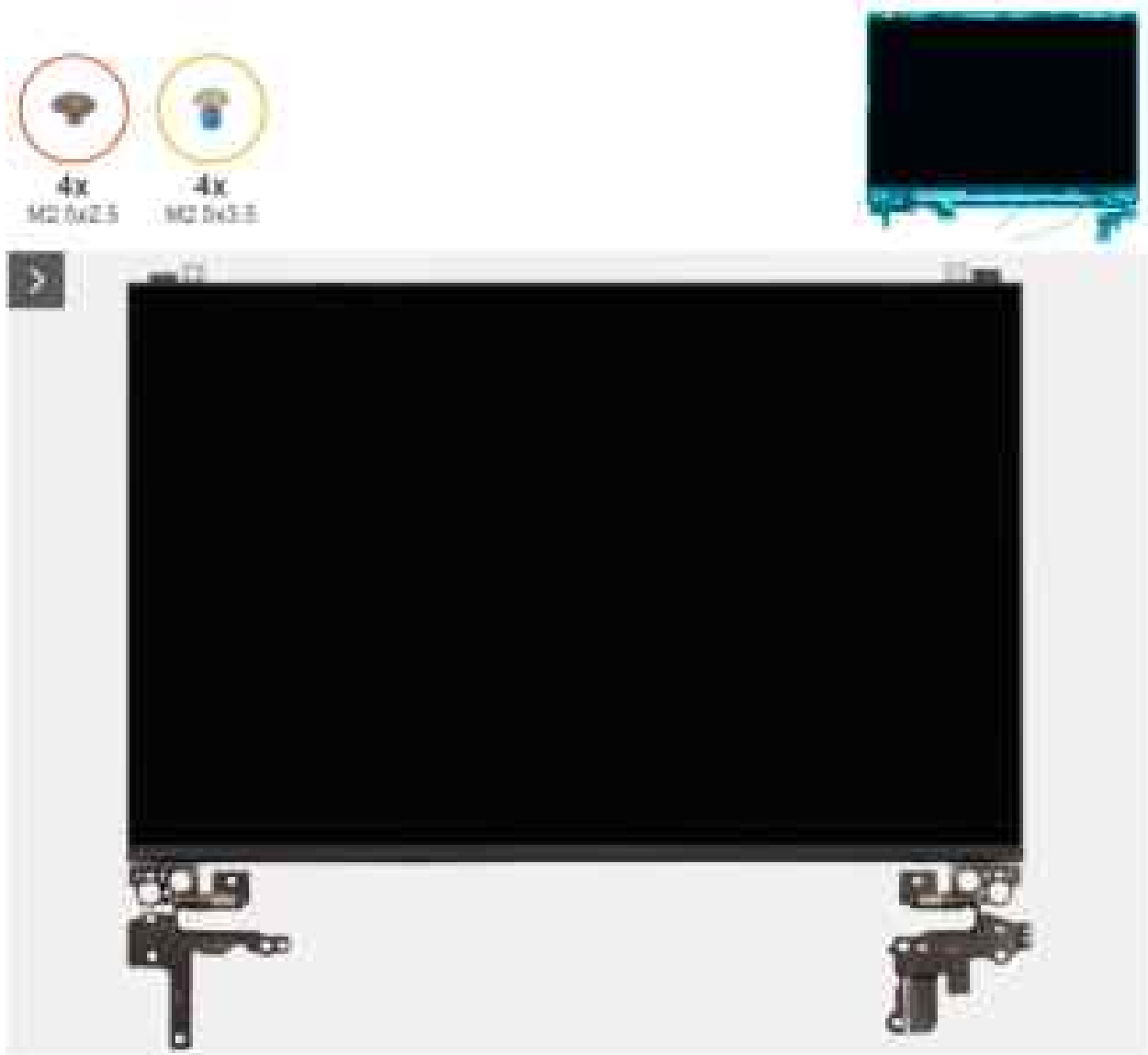
Abbildung 115. Installieren der Bildschirmbaugruppe
