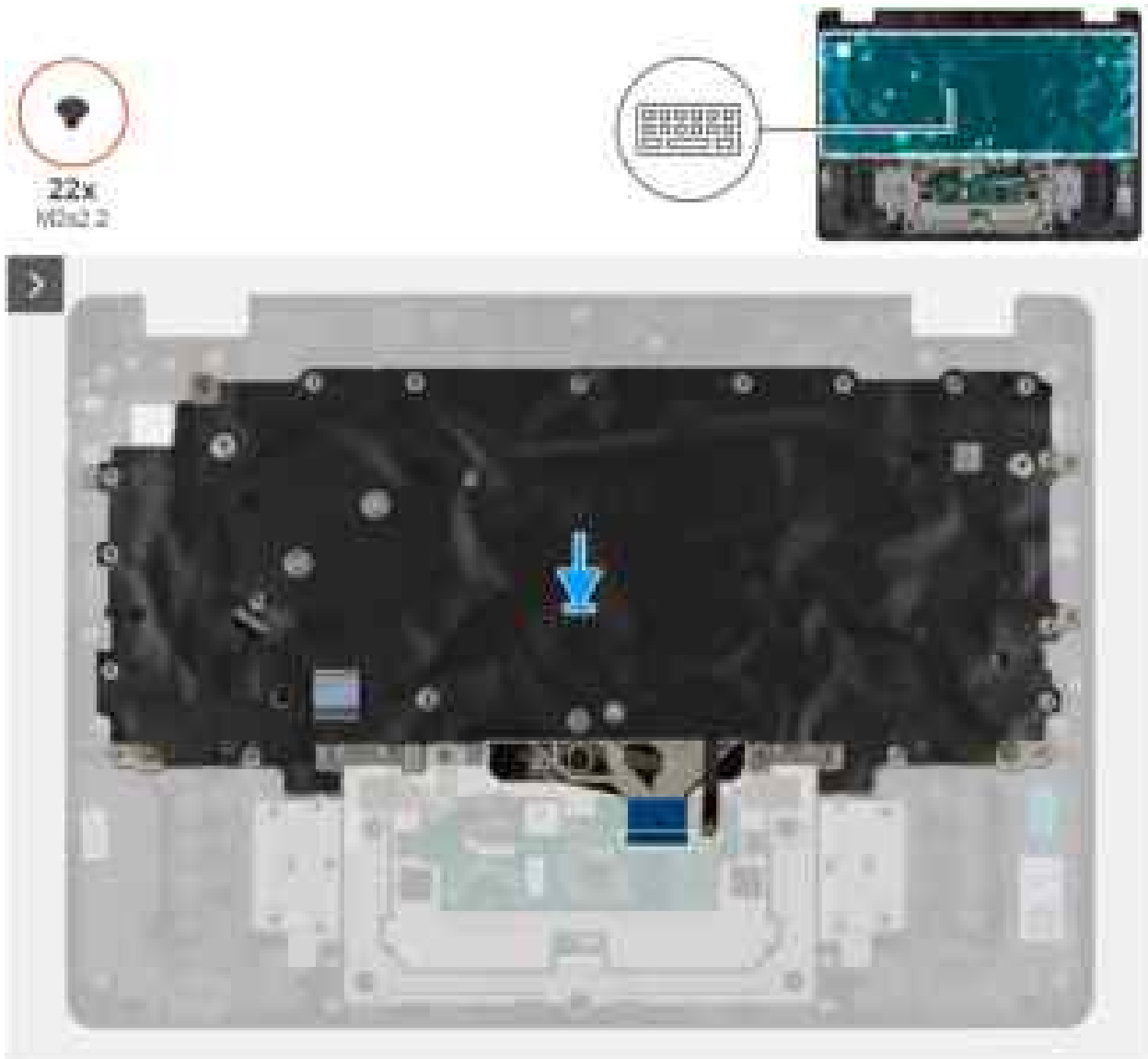
Abbildung 83. Einbauen der Tastatur
