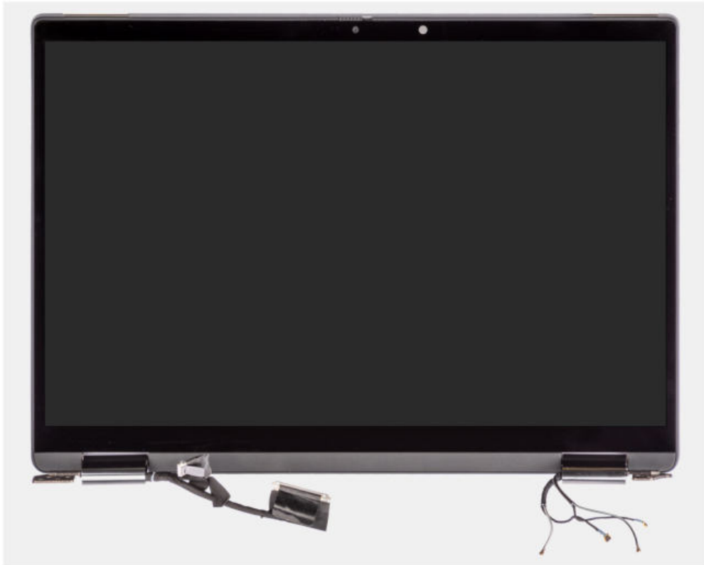
Abbildung 43. Bildschirmbaugruppe ohne WWAN-Antennenkabel
