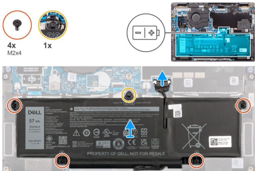
Abbildung 31. Entfernen des 4-Zellen-Akkus
