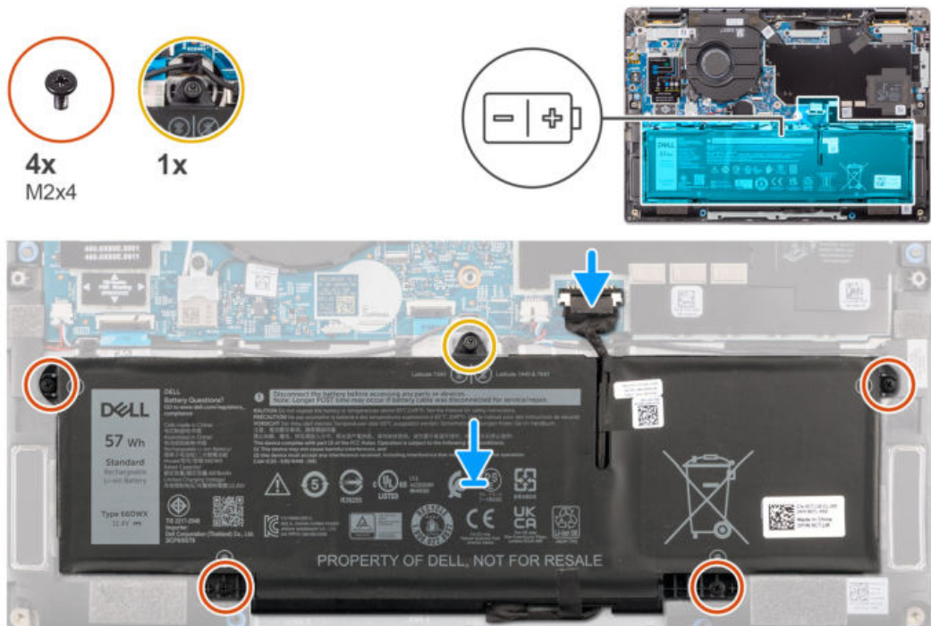
Abbildung 32. Einsetzen des 4-Zellen-Akkus
