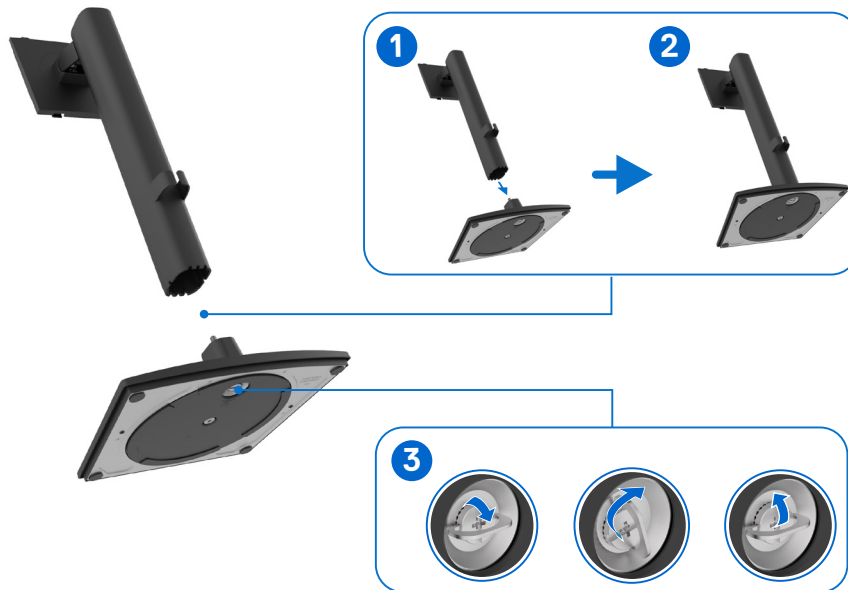
Abbildung 17. Montieren des Monitorständers
