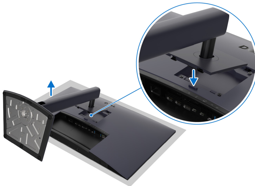
Abbildung 64. Entfernen des Monitorständers
