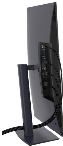
Abbildung 31. Kabel in der höchsten, am meisten gedrehten Position anschließen
