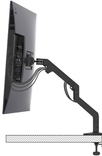
Abbildung 66. Kabel in der höchsten, am meisten gedrehten Position anschließen
