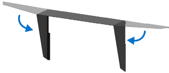
Abbildung 23. Entfalten der Monitorblende
