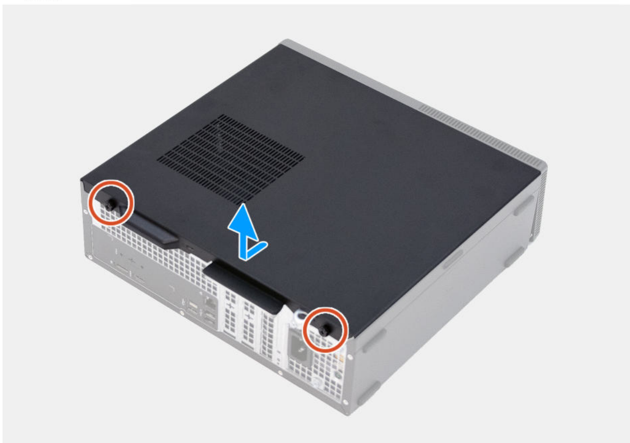
Abbildung 10. Entfernen der linken Abdeckung
