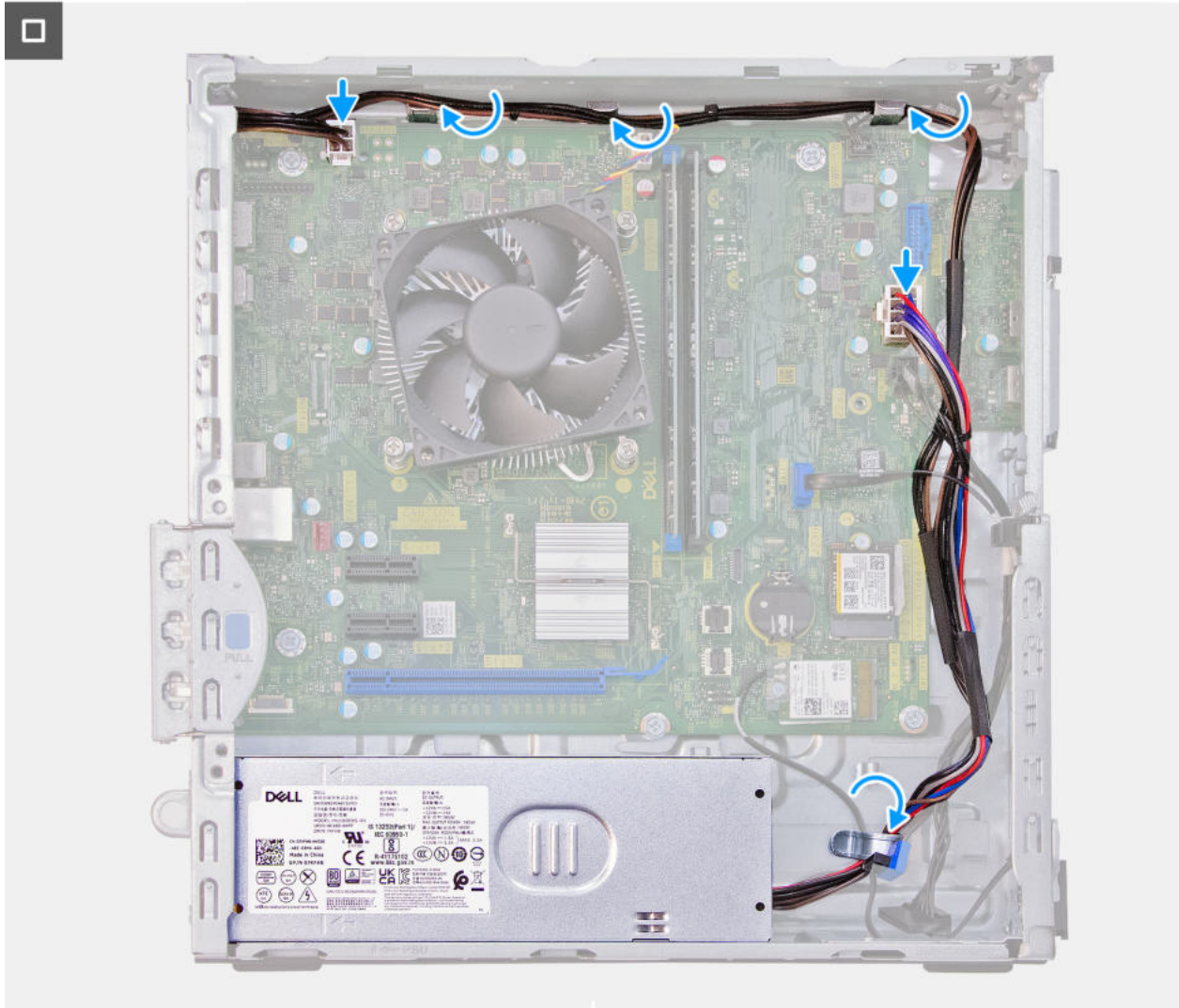
Abbildung 36. Installieren der Stromversorgungseinheit
