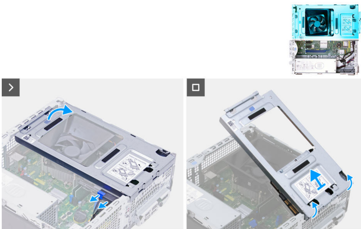
Abbildung 18. Entfernen des Laufwerksschachts
