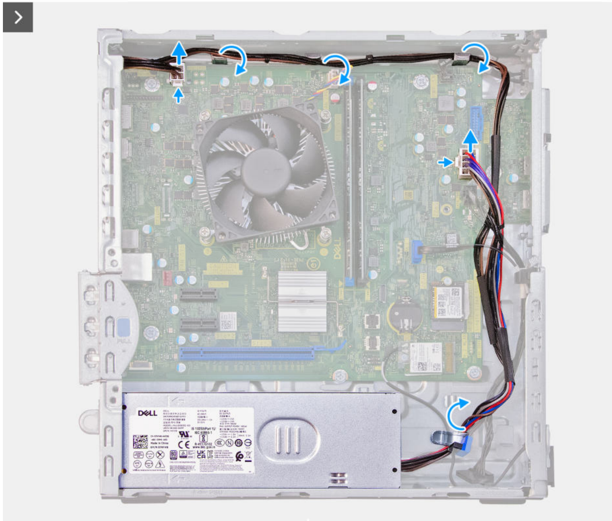
Abbildung 33. Entfernen der Stromversorgungseinheit
