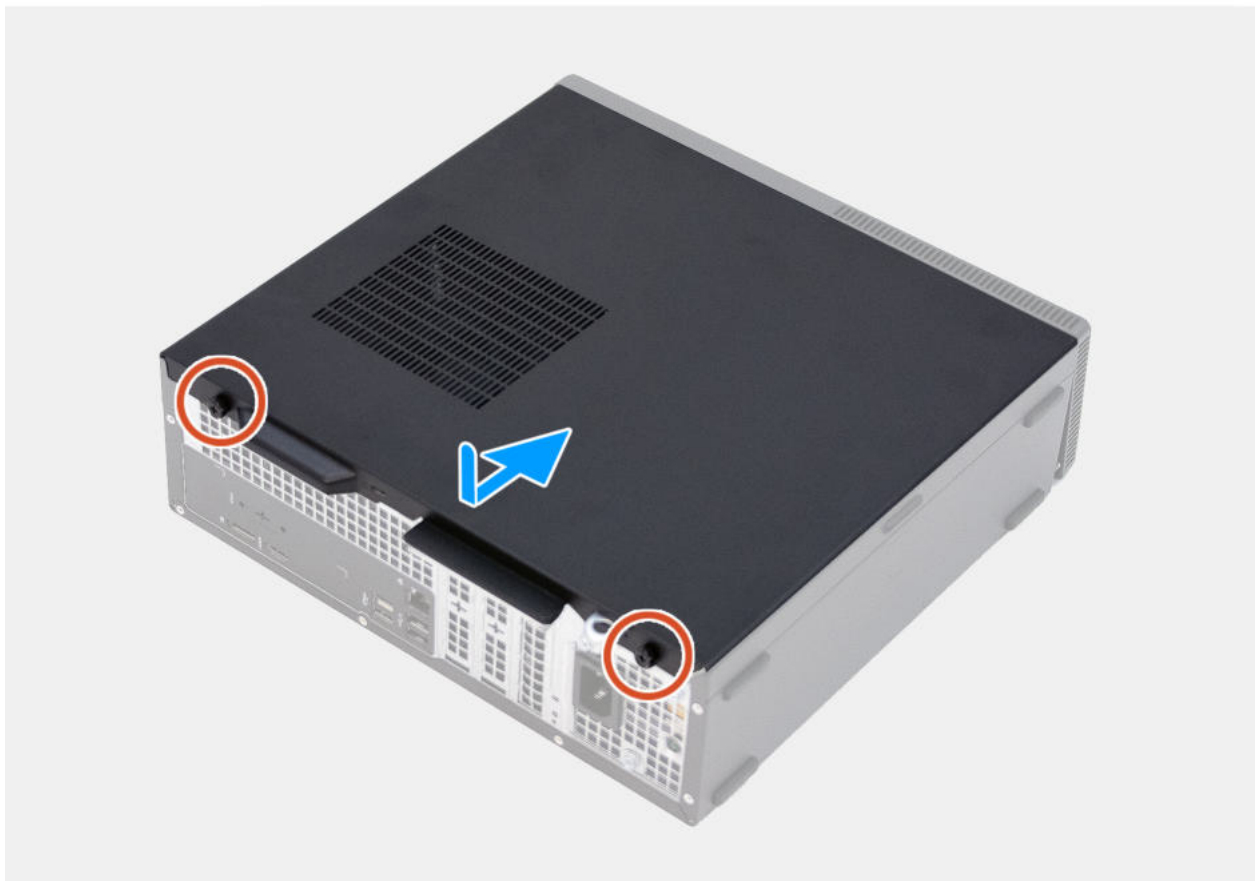
Abbildung 11. Installieren der linken Abdeckung
