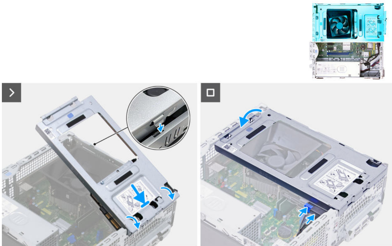
Abbildung 20. Einbauen des Laufwerkschachts
