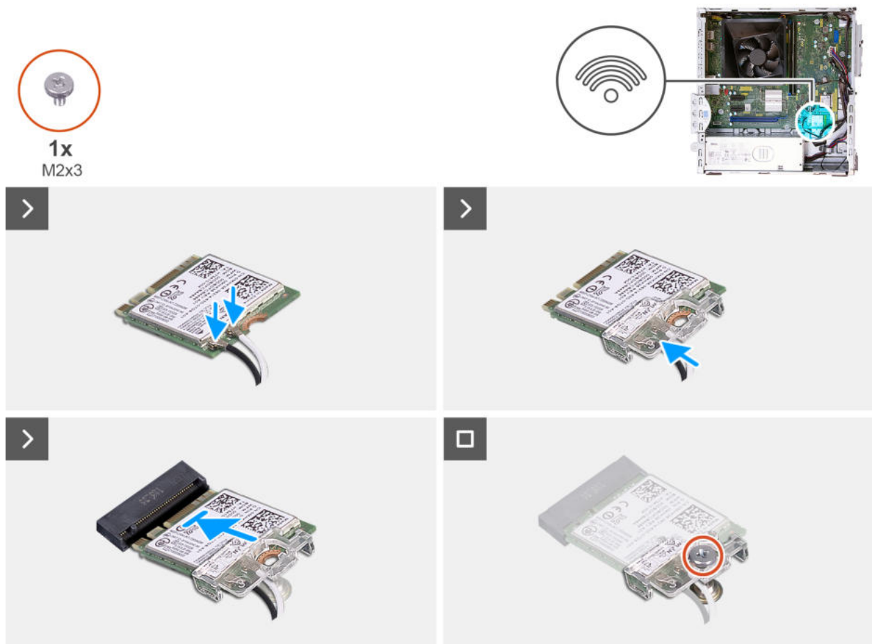
Abbildung 28. Installieren der Wireless-Karte
