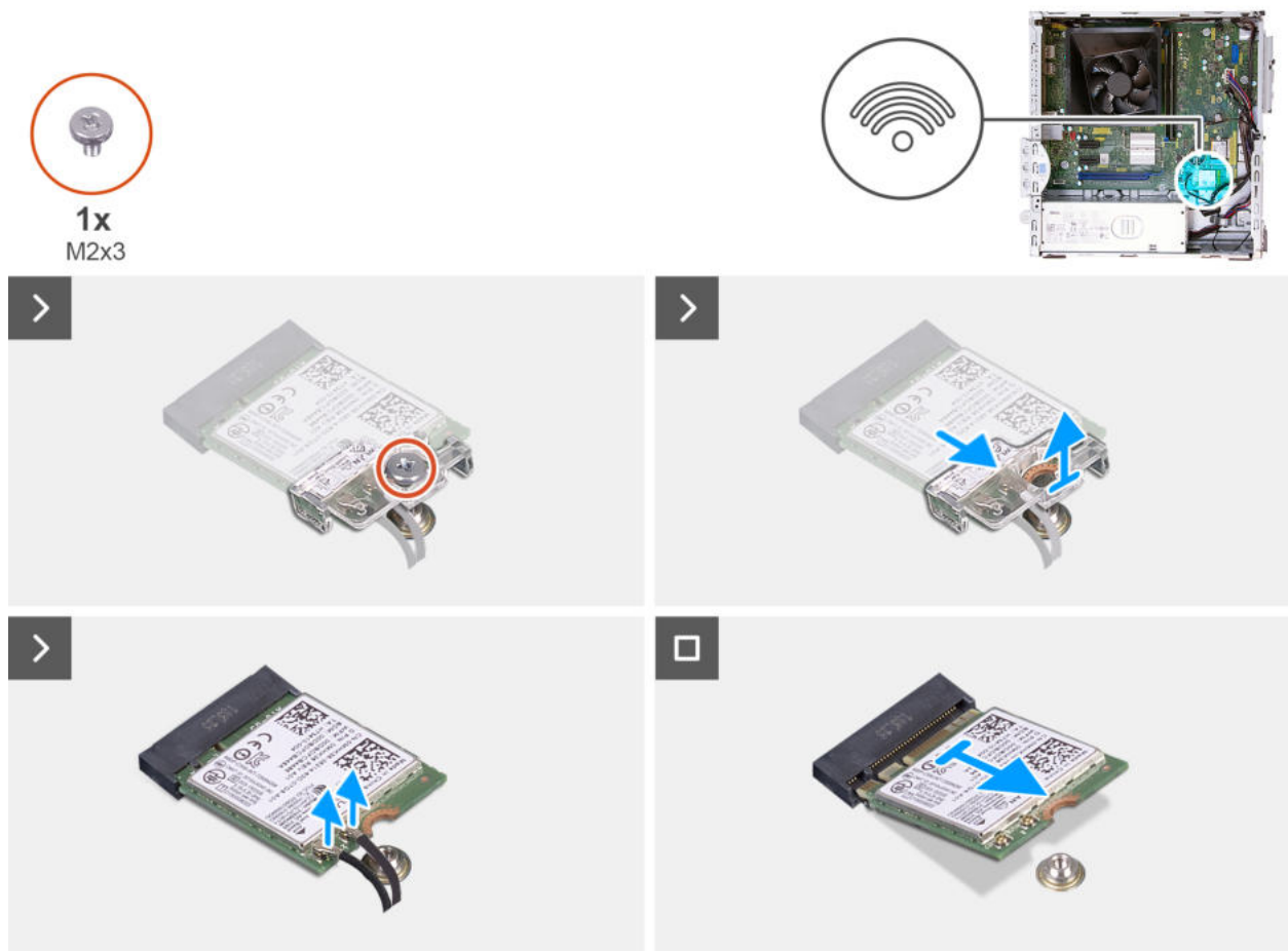
Abbildung 27. Entfernen der Wireless-Karte
