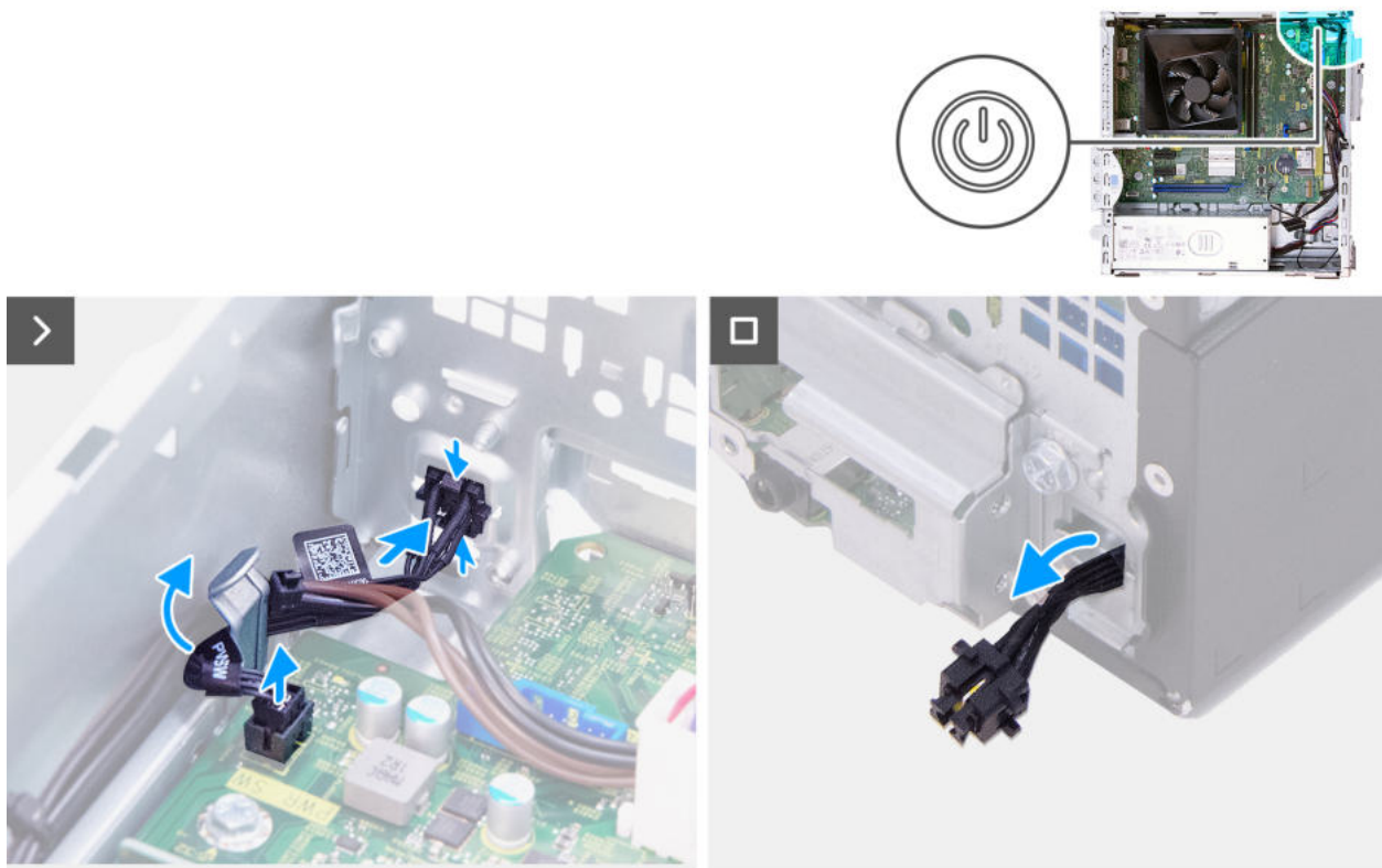
Abbildung 43. Entfernen des Netzschalters
