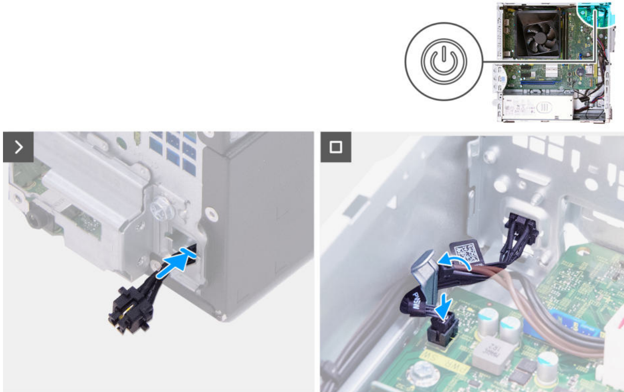
Abbildung 44. Installieren des Netzschalters
