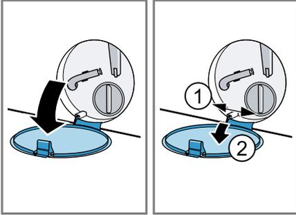
5. Ein passendes Gefäß zum Ablassen der Waschlauge unter die Öffnung schieben.
