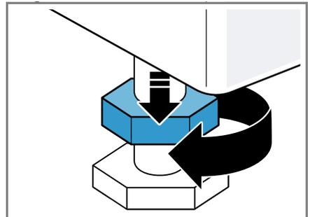
2. Um das Gerät auszurichten, die Gerätefüße drehen. Die Ausrich-
