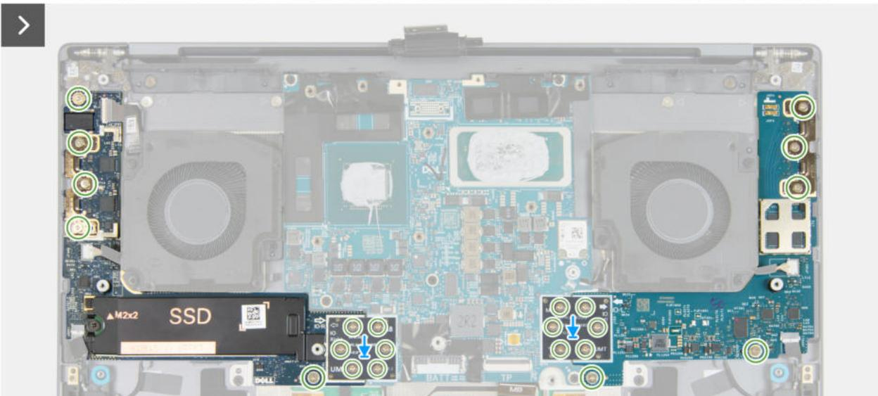
Abbildung 63. Einbauen der Hauptplatine (separate Grafikkarte)
