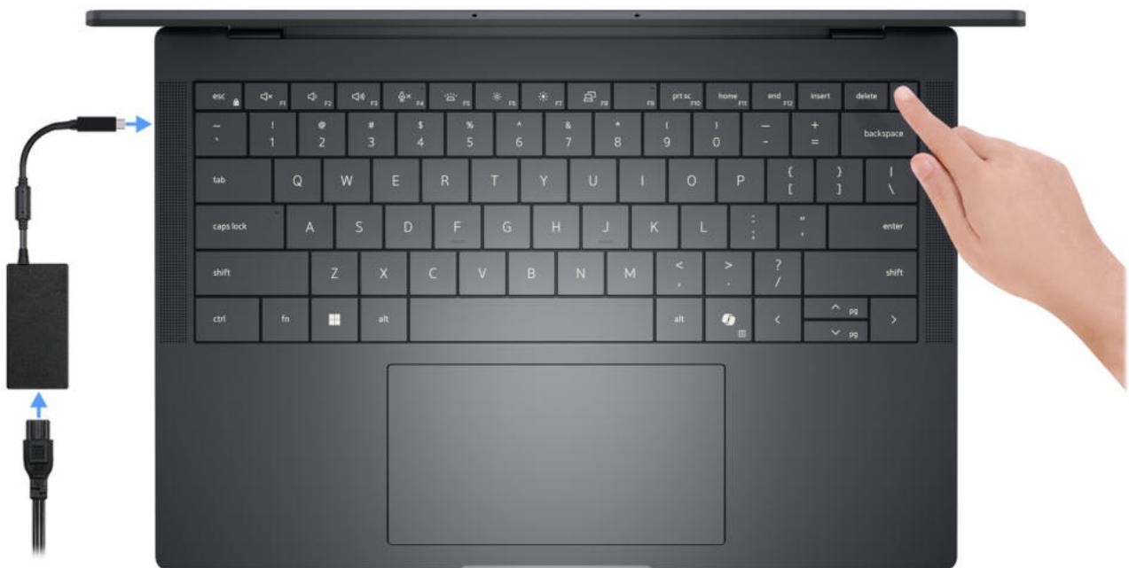
**Abbildung 8. Anschließen des Netzteils und Drücken des Netzschalters**
