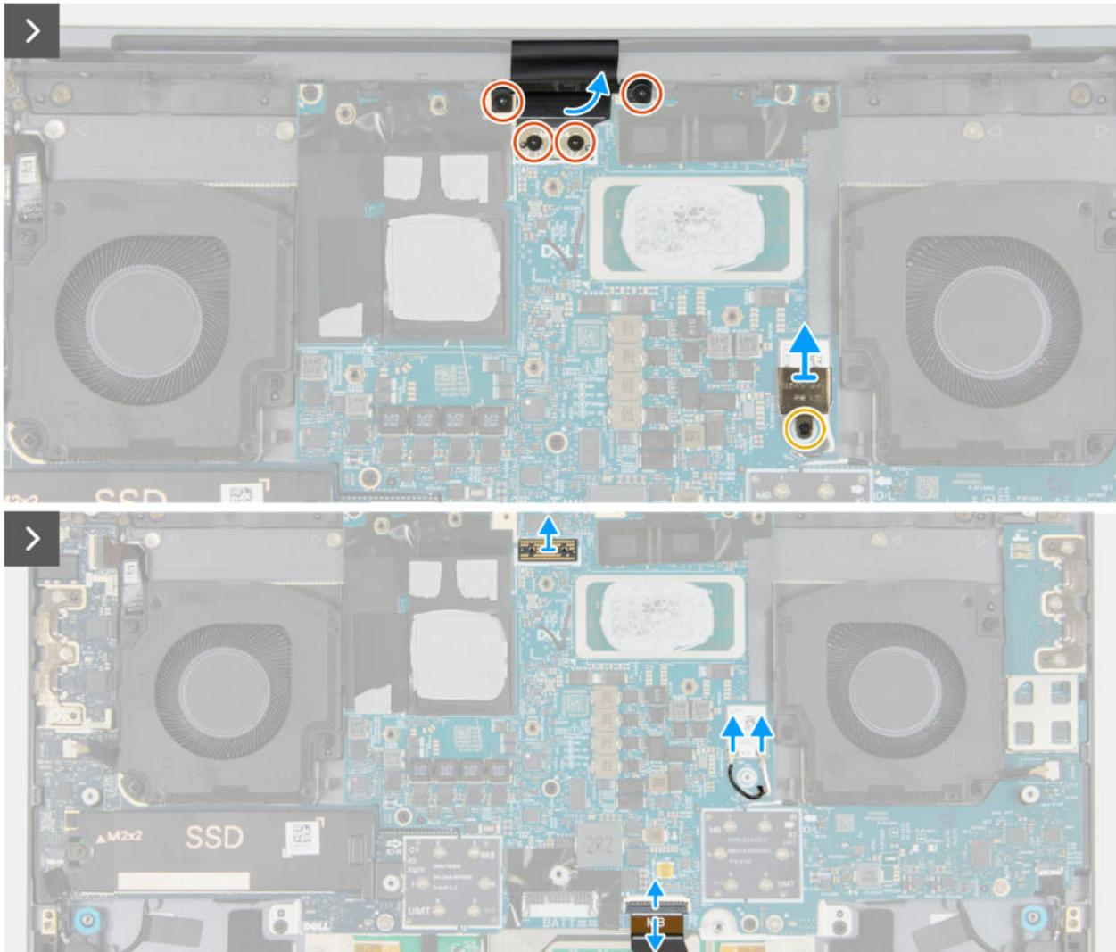
Abbildung 50. Entfernen der Hauptplatine (integrierte Grafikkarte)
