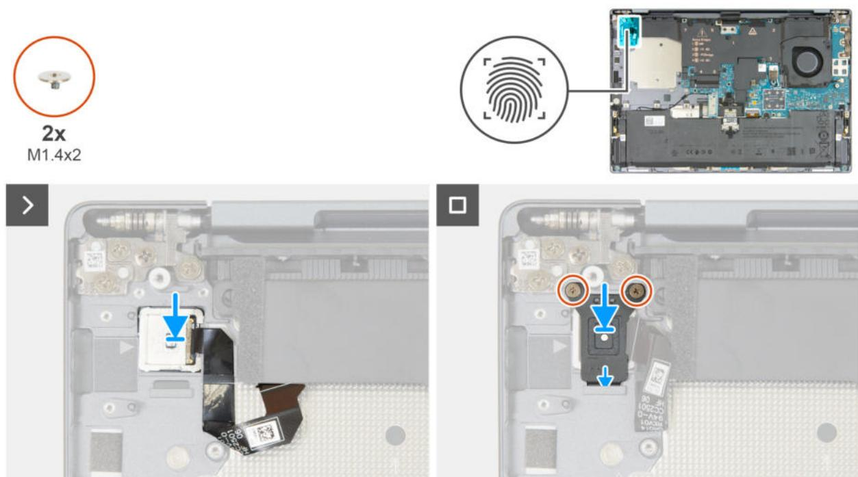
Abbildung 68. Einbauen des Netzschalters oder Fingerabdrucklesers
