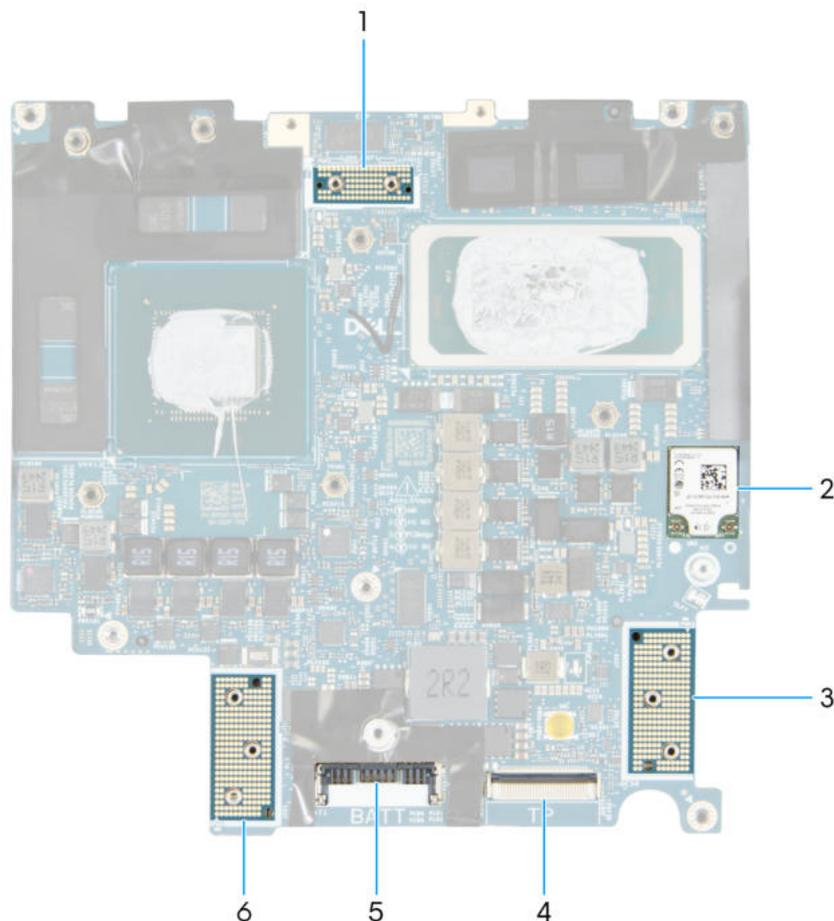
**Abbildung 58. Anschlüsse auf der Hauptplatine**
