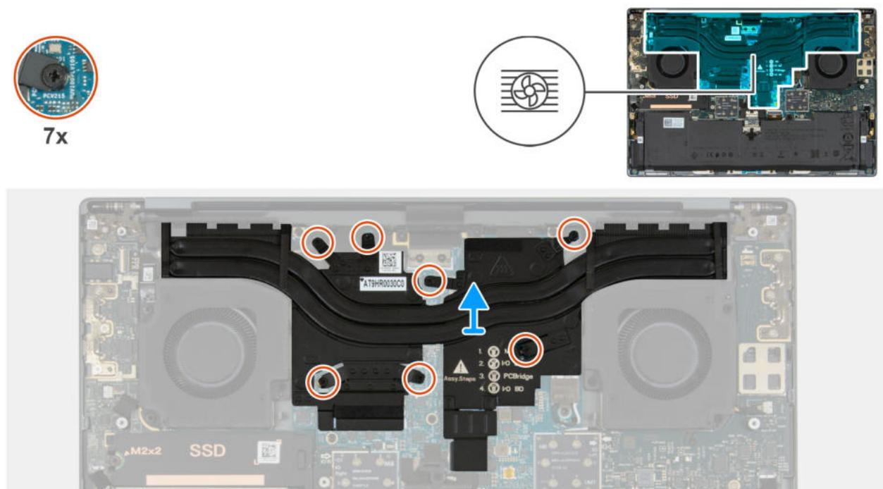
Abbildung 41. Kühlkörper entfernen
