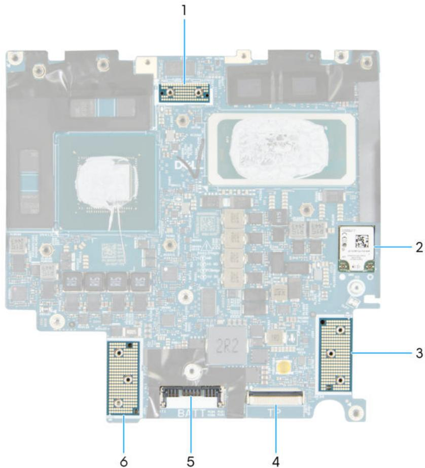
**Abbildung 62. Anschlüsse auf der Hauptplatine**
