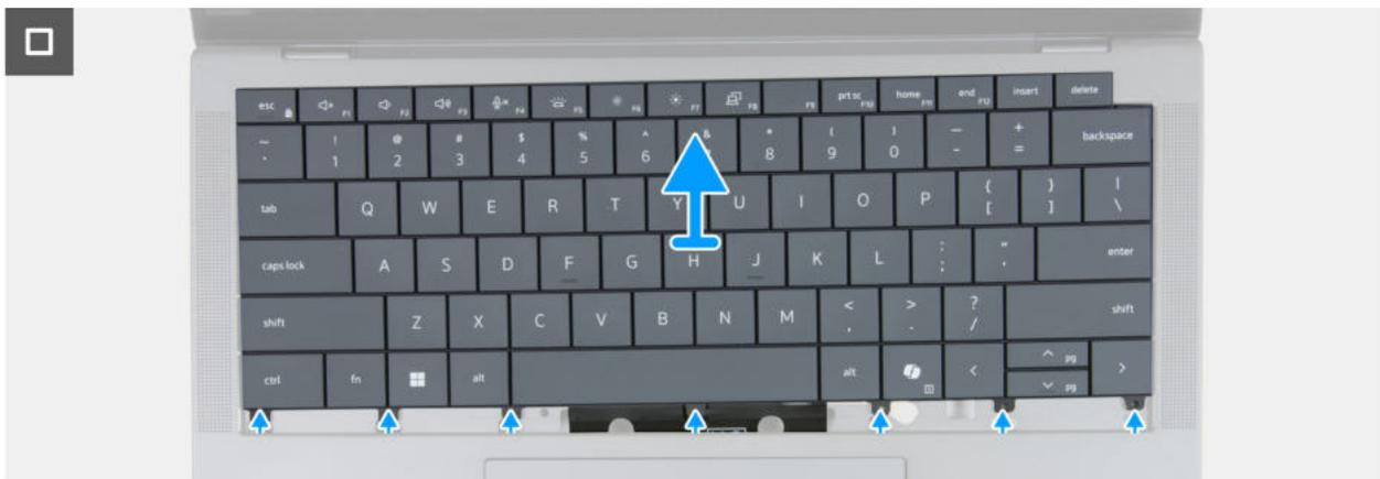
Abbildung 72. Entfernen der Tastatur
