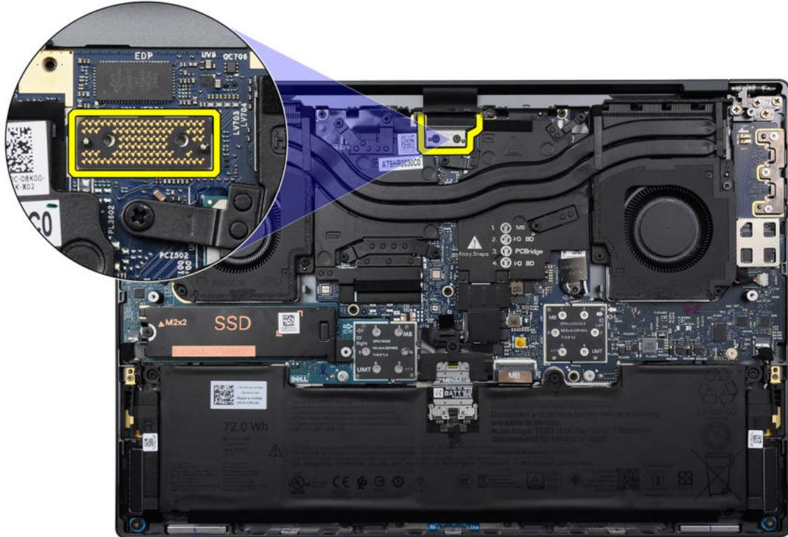
Abbildung 35. Kabelzwischenplatine der Bildschirmbaugruppe
