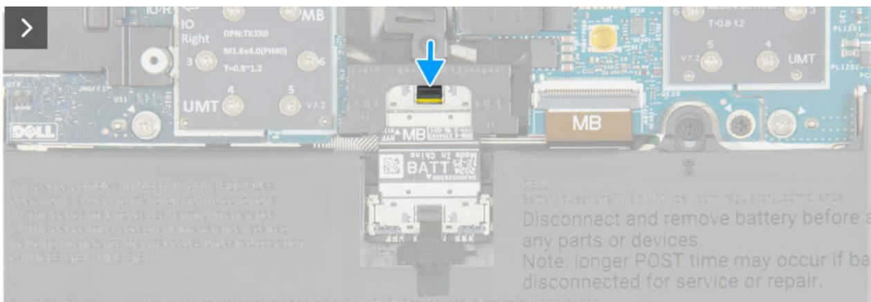
Abbildung 16. Wiederherstellung der Stromversorgung über den Akku
