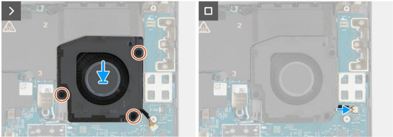
Abbildung 28. Installieren des linken Lüfters
