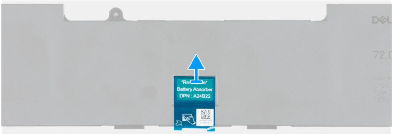
Abbildung 18. Entfernen des Batterieabsorbers
