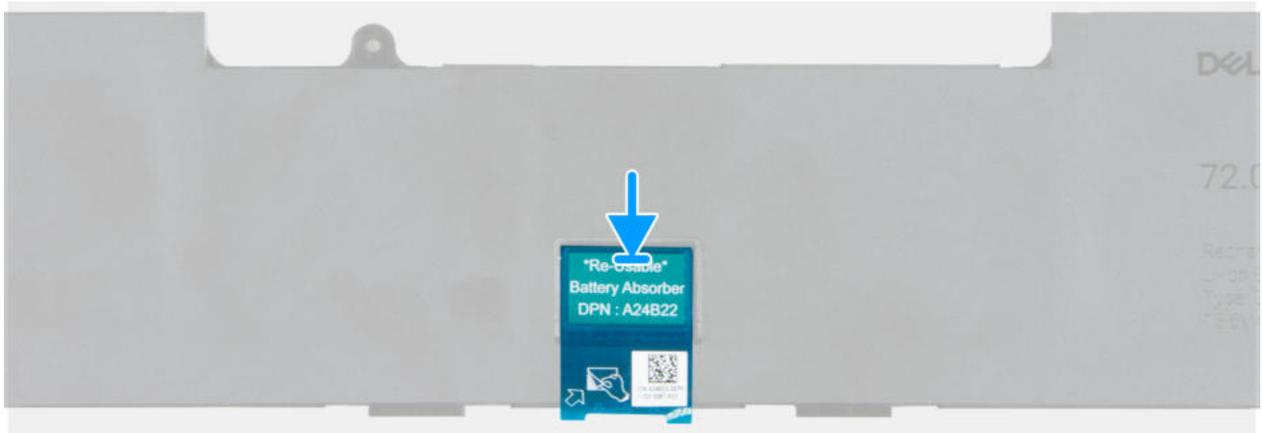
Abbildung 20. Einbauen des Batterieabsorbers
