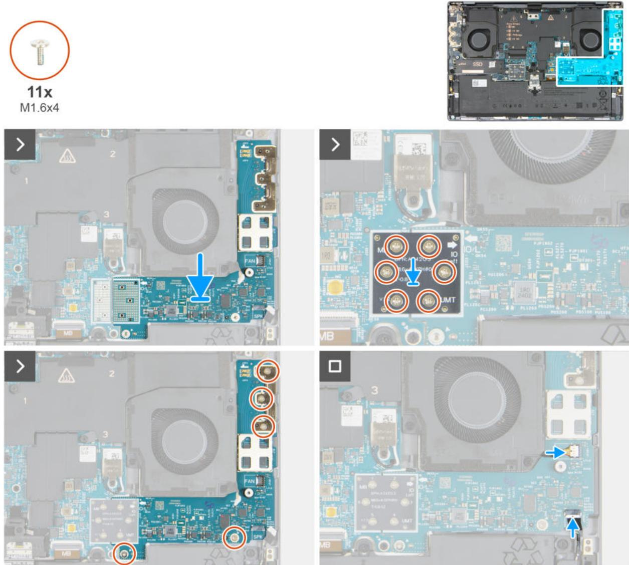
Abbildung 46. Installieren der linken E/A-Platine
