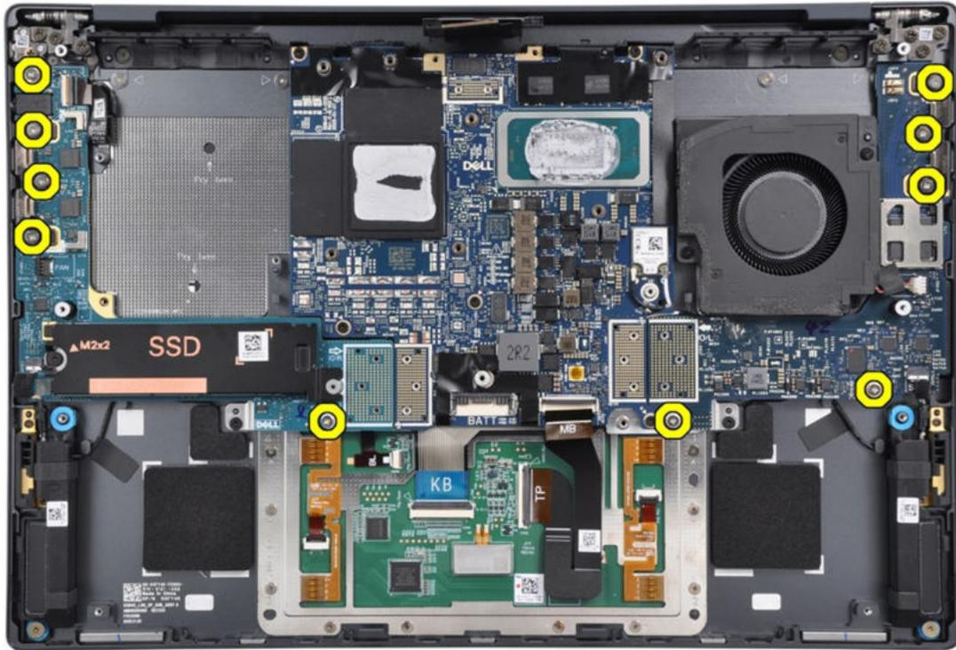
Abbildung 56. Schrauben der I/O-Platinen
