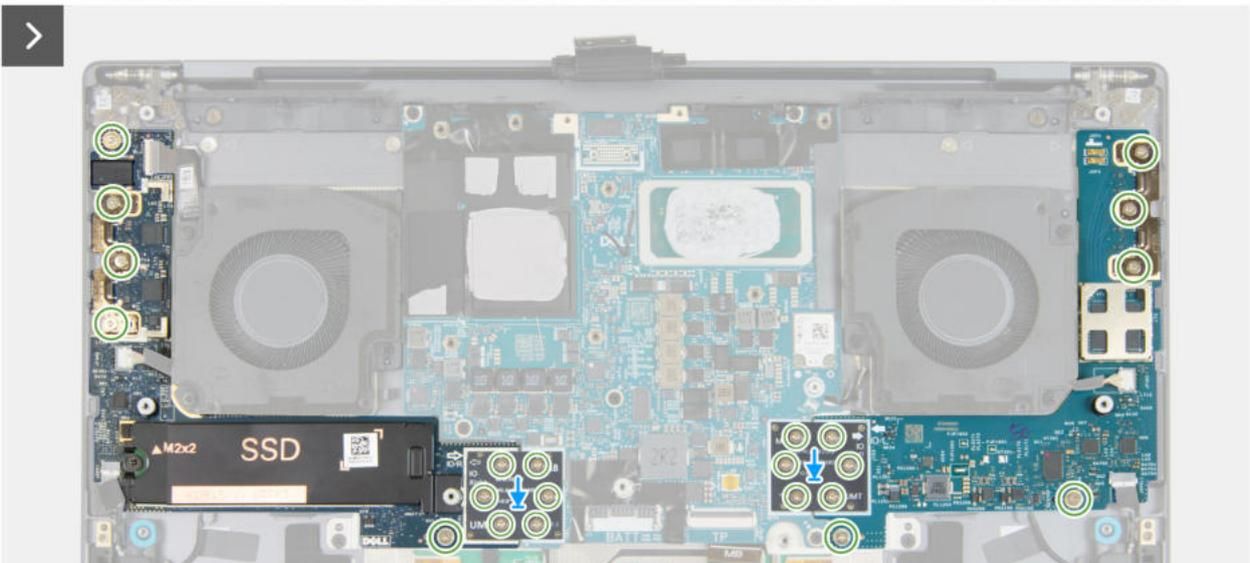
Abbildung 54. Einbauen der Hauptplatine (integrierte Grafikkarte)
