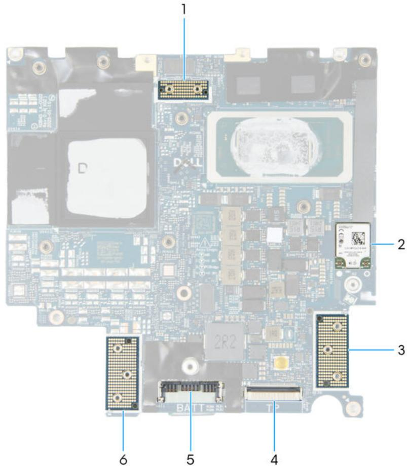
**Abbildung 49. Anschlüsse auf der Hauptplatine**
