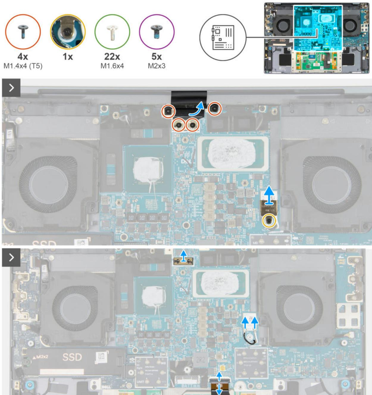
Abbildung 59. Entfernen der Hauptplatine (separate Grafikkarte)
