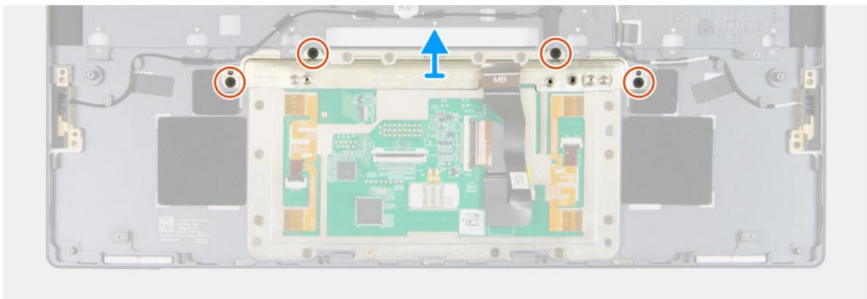
Abbildung 77. Entfernen der Touchpadhalterung
