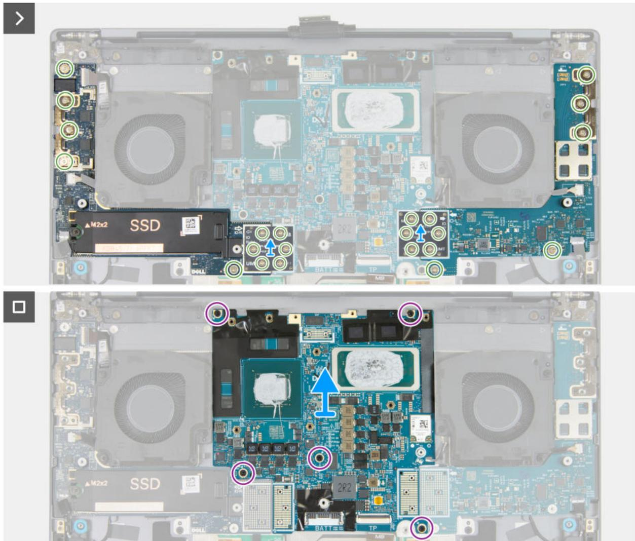
**Abbildung 60. Entfernen der Hauptplatine (separate Grafikkarte)**
