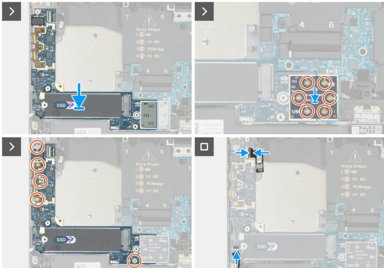
Abbildung 48. Installieren der rechten E/A-Platine
