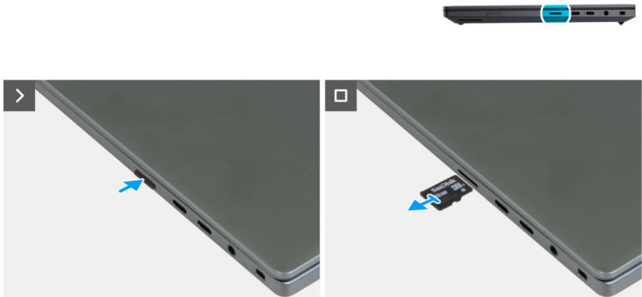
Abbildung 10. Entfernen der Speicherkarte
