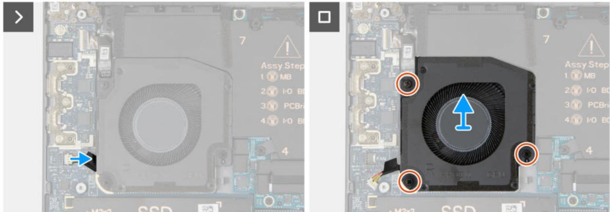
Abbildung 29. Entfernen des rechten Lüfters
