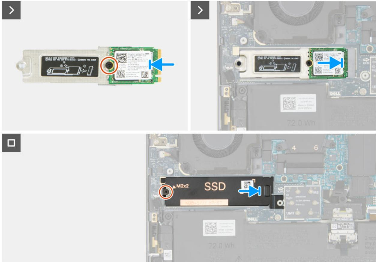
Abbildung 26. Installieren des M.2 2230-Solid-State-Laufwerks
