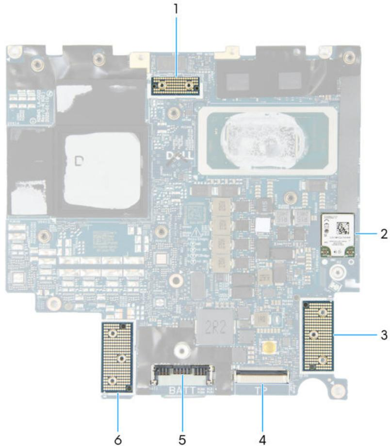
**Abbildung 53. Anschlüsse auf der Hauptplatine**
