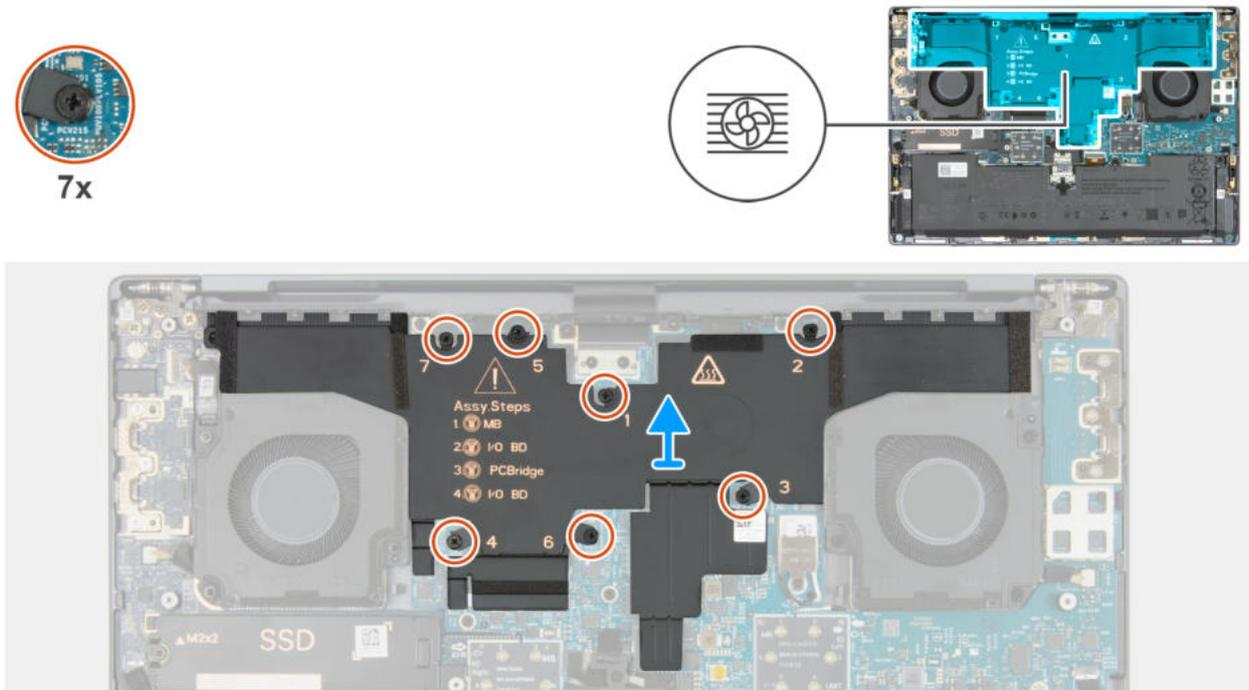
Abbildung 43. Kühlkörper entfernen
