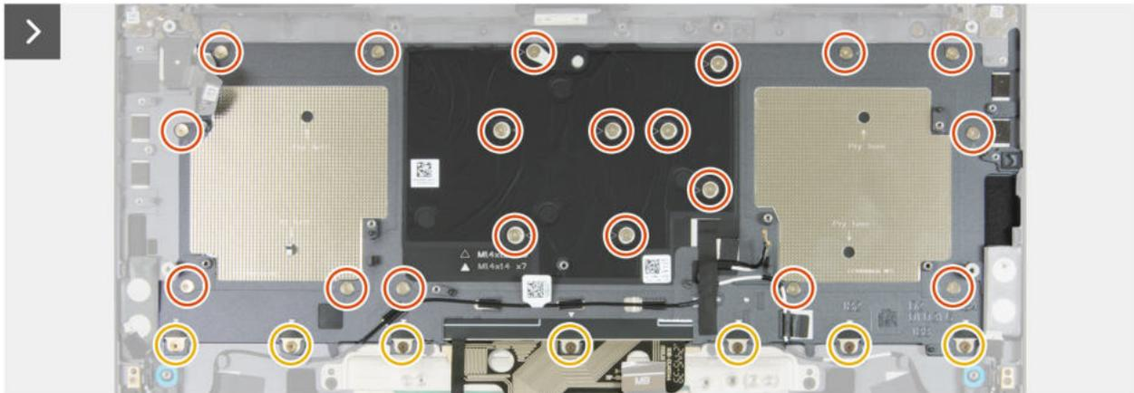
Abbildung 71. Entfernen der Tastatur
