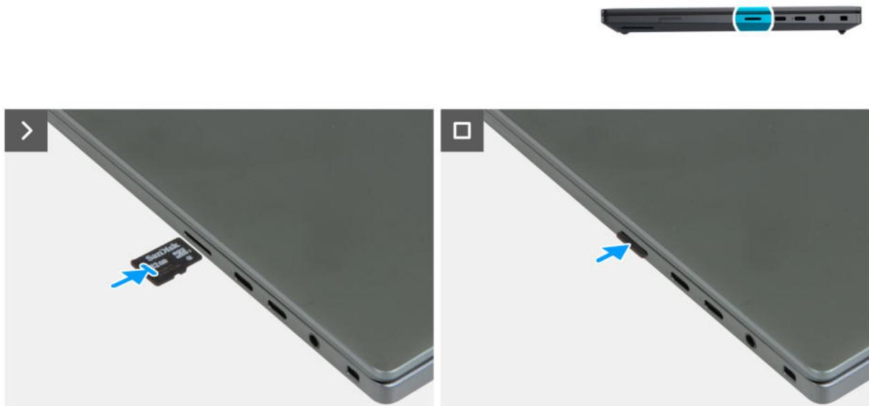
Abbildung 11. Einsetzen der Speicherkarte
