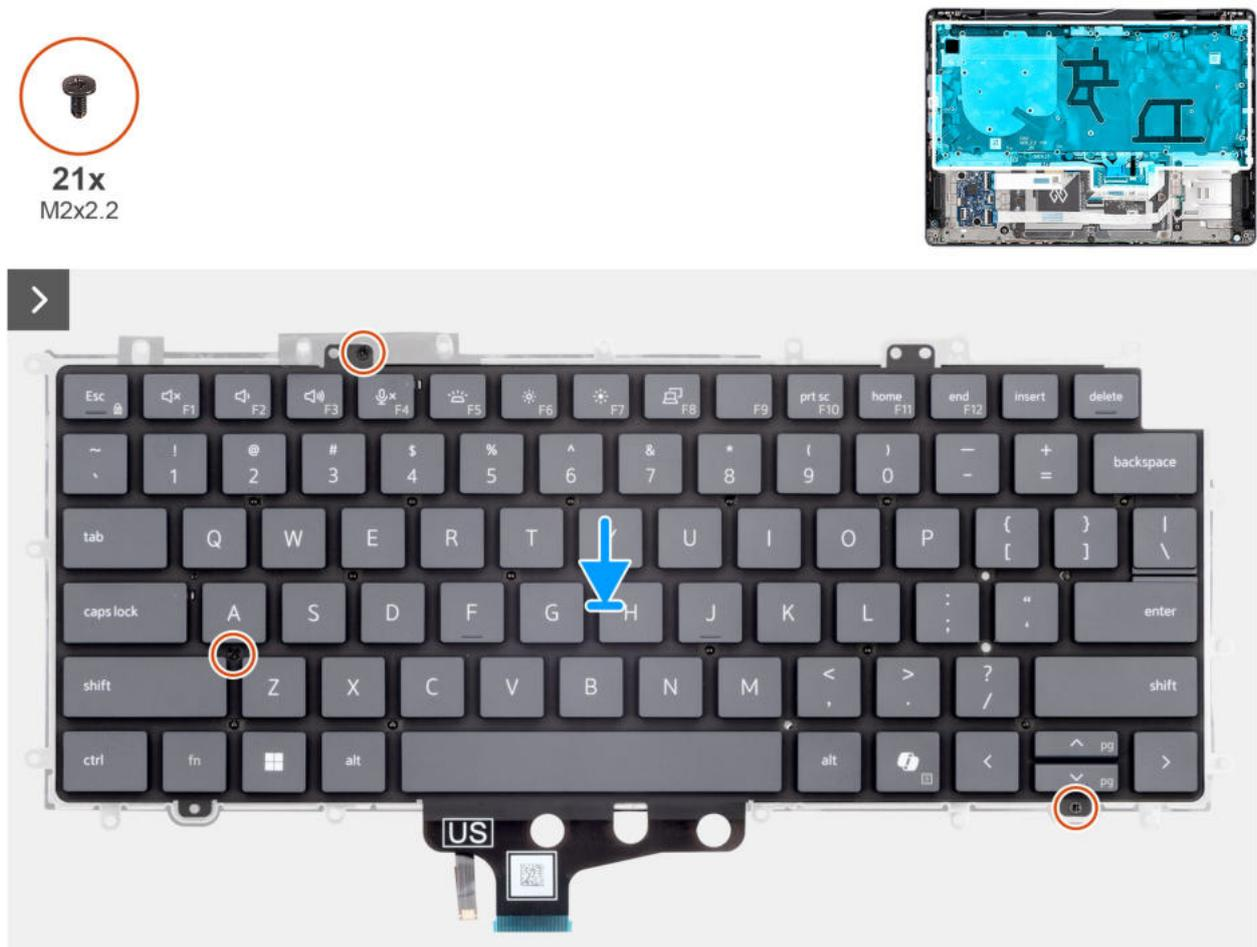
Abbildung 97. Installing the keyboard
