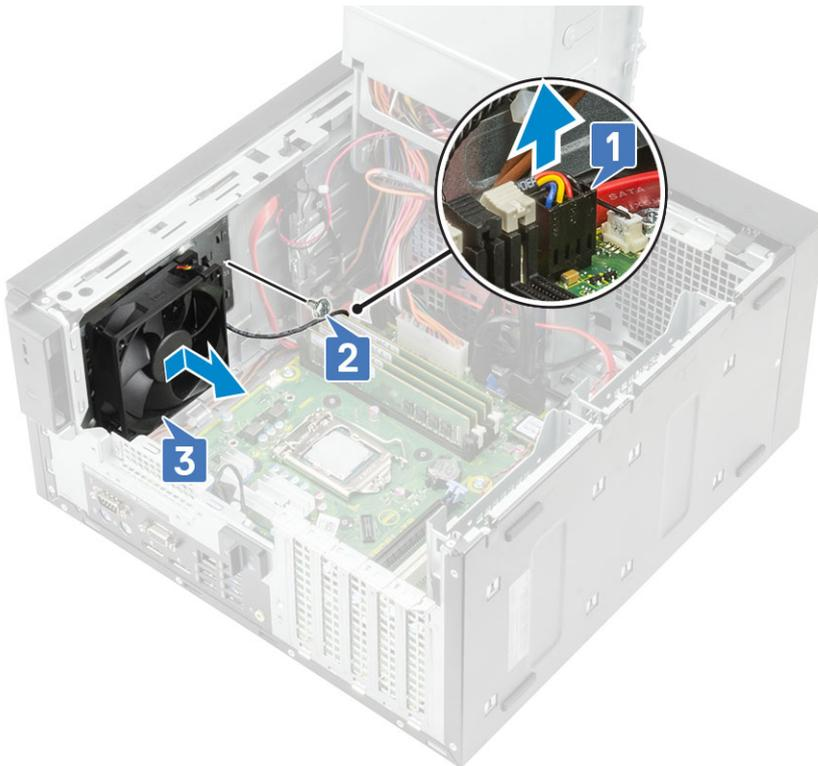
6. Ziehen Sie das Systemlüfterkabel aus der Kabelführung auf der Systemlüfterhalterung [1].
