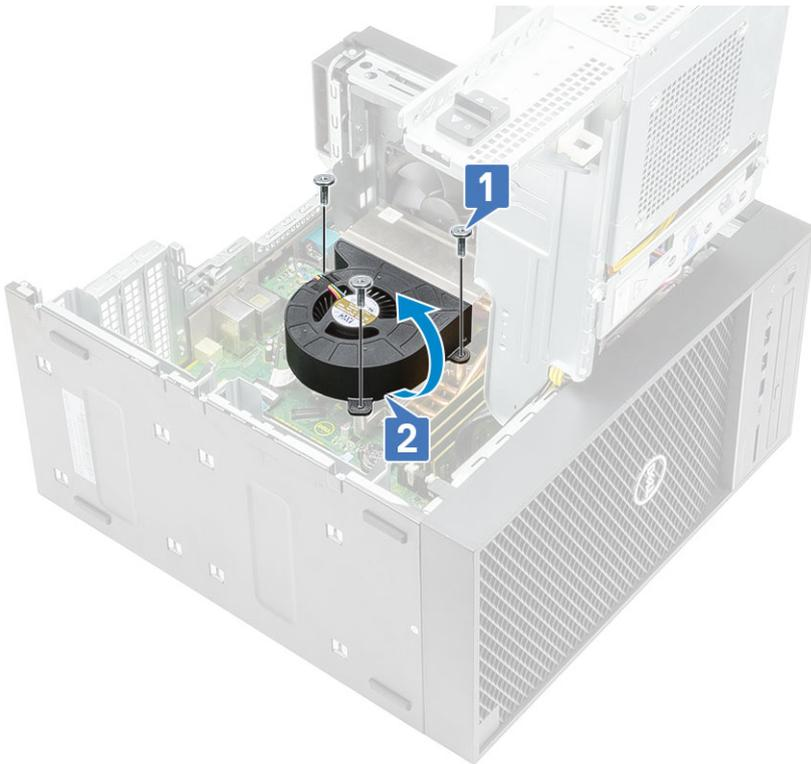
6. Lösen Sie die unverlierbaren Schrauben, mit denen die Kühlkörperbaugruppe an der Systemplatine befestigt ist [1].
