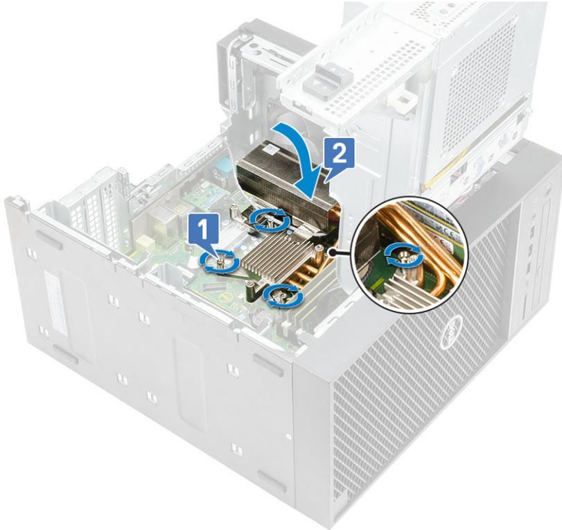
5. Richten Sie die Schraubenbohrungen am Gebläse an den Schraubenbohrungen der Kühlkörperbaugruppe aus und setzen Sie das Gebläse auf die Kühlkörperbaugruppe [1].
