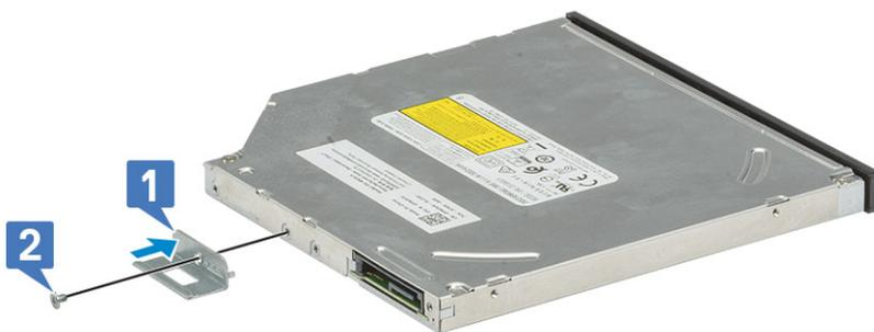
2. Schieben Sie das optische Laufwerk von der Vorderseite des Computers in den Laufwerkschacht, bis es sicher befestigt ist.
