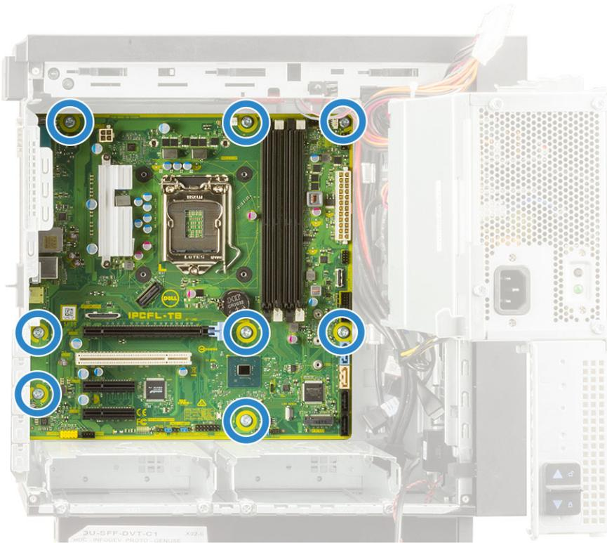
7. Heben Sie die Systemplatine schräg an und nehmen Sie sie aus dem Computer.
