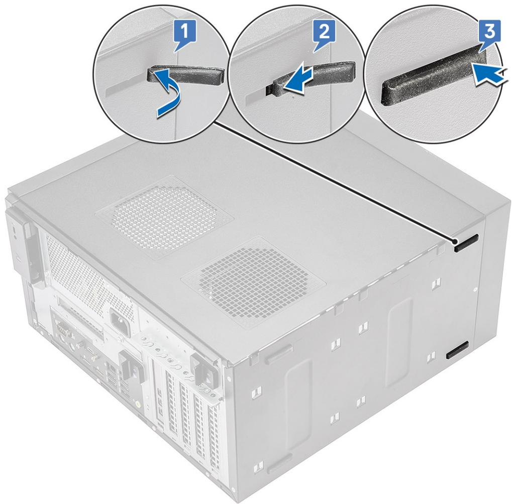
Abbildung 6. Anbringen der vorderen GummifüÙe
