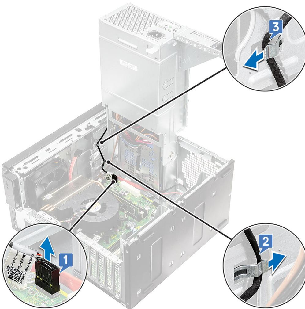
6. Entfernen Sie das Klebeband, mit dem das Netzschaltermodul am Gehäuse befestigt ist [1].
