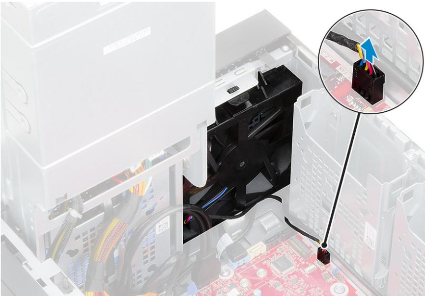
5. Um den vorderen Lüfter aus der Halterung zu entfernen, drücken Sie auf die Lasche, mit der der vordere Lüfter an der Halterung befestigt ist.
