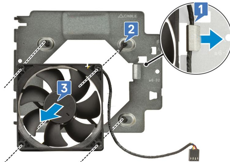
Abbildung 12. Entfernen des Gehäuselüfters
