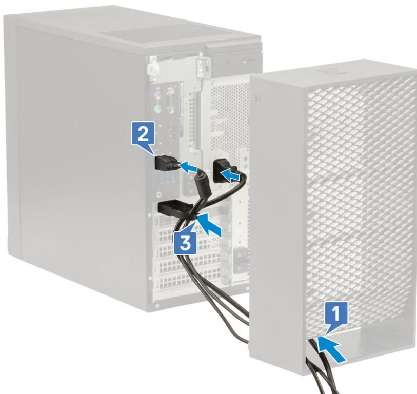
7. Richten Sie die Haken aus Kunststoff auf der Kabelabdeckung an den Steckplätzen am System aus.
