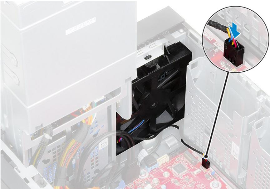
6. Verlegen Sie die Kabel der Festplattenkarte über der Halterung des vorderen Lüfters.
