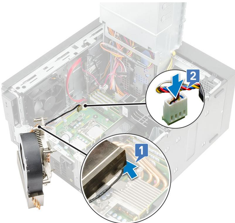
2. Positionieren Sie die Kühlkörperbaugruppe über dem Prozessor.
