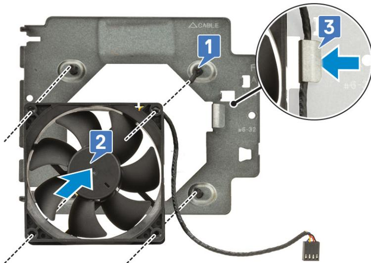
3. Richten Sie die Aussparungen an der Systemlüfterbaugruppe an den Halterungen am Gehäuse aus und schieben Sie die Baugruppe [1].
