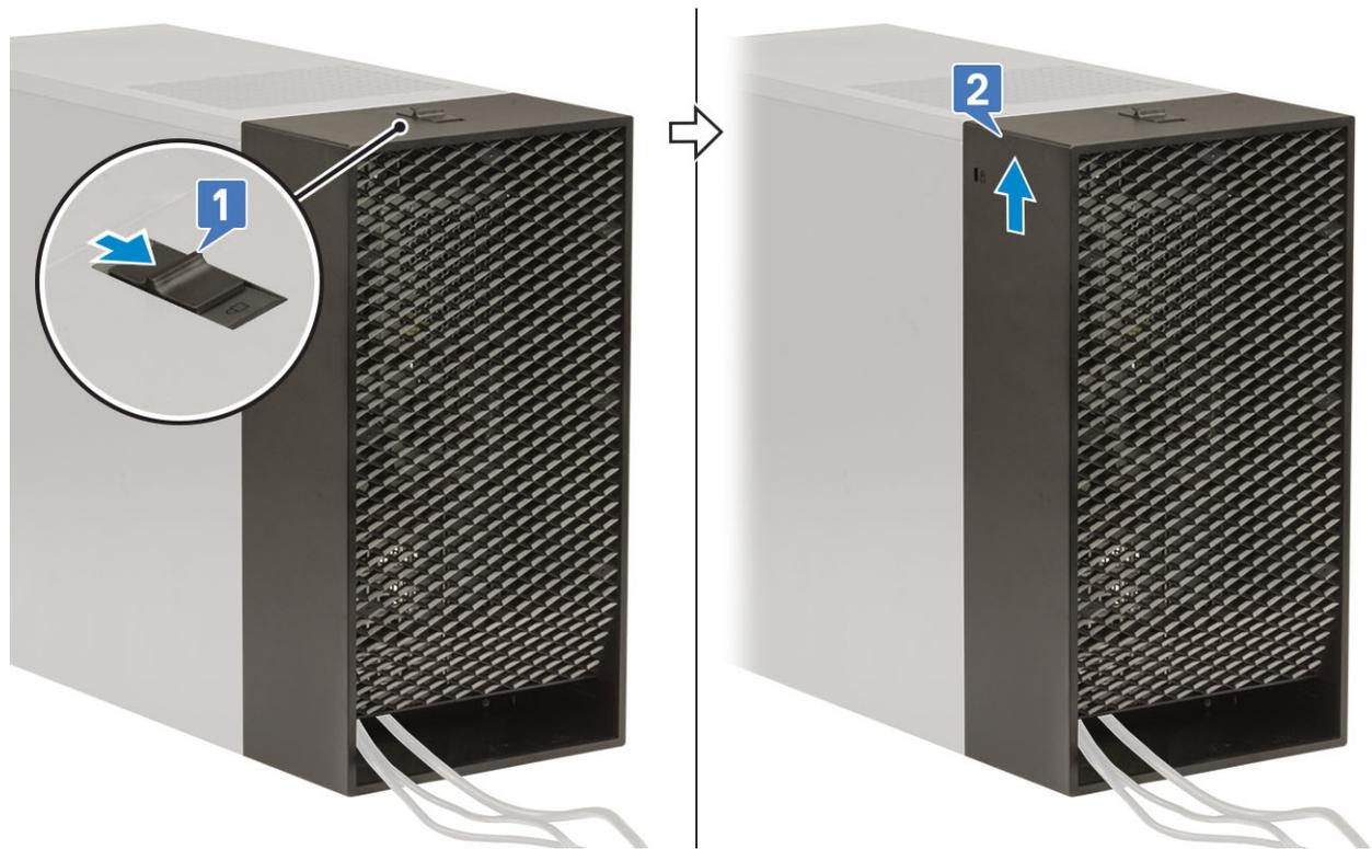
10. Ziehen Sie die Kabelabdeckung, um sie vom Gehäuse zu lösen.
