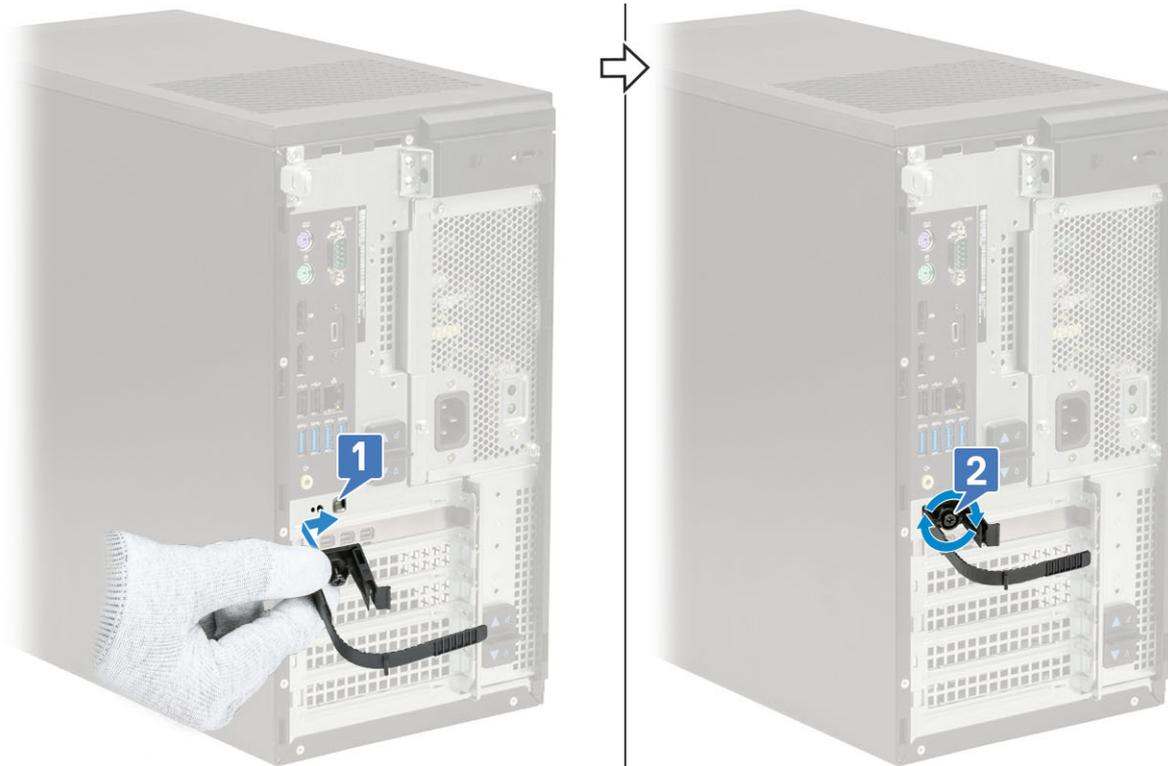
6. Führen Sie die Kabel durch den Steckplatz der Kabelabdeckung [1] und schließen Sie sie an die entsprechenden Ports auf dem System an [2]. Befestigen Sie das Kabel mit dem Kabelbinder und verriegeln Sie die Lasche [3].
