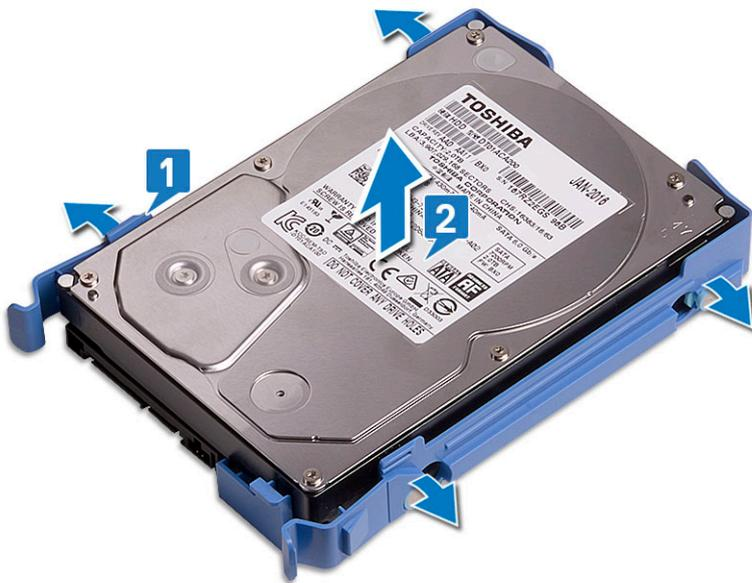
6. Um ein weiteres Festplattenlaufwerk zu entfernen (falls vorhanden), befolgen Sie die Schritte 3 bis 5.
