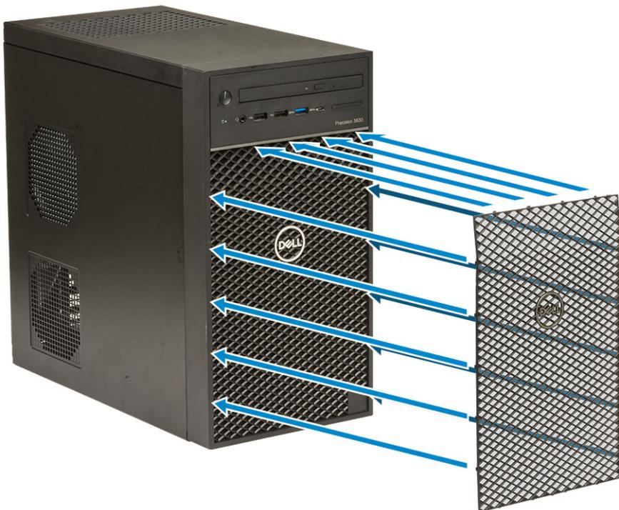
2. So entfernen Sie den Staubfilter:
