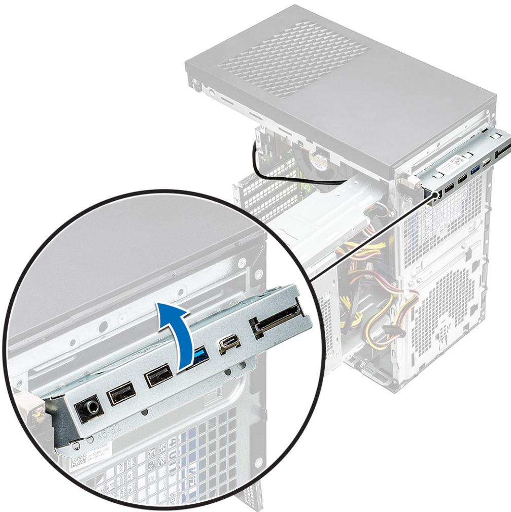
8. Ziehen Sie an der E/A-Leiste und den Kabeln und entfernen Sie sie aus dem E/A-Leistensteckplatz im Gehäuse.
