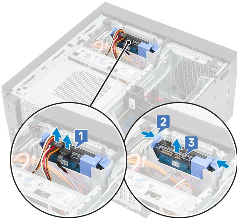
5. Biegen Sie die Festplattenhalterung seitlich nach außen [1] und heben Sie das Festplattenlaufwerk aus der Halterung [2].
