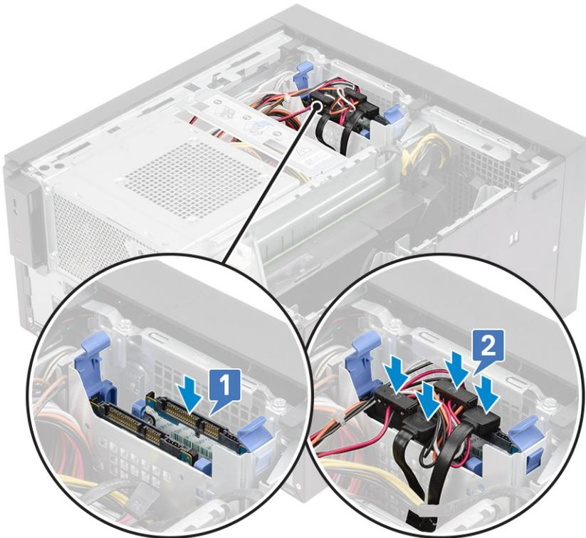
4. Schieben Sie die Festplattenbaugruppe in den unteren Festplattenschacht [1].
