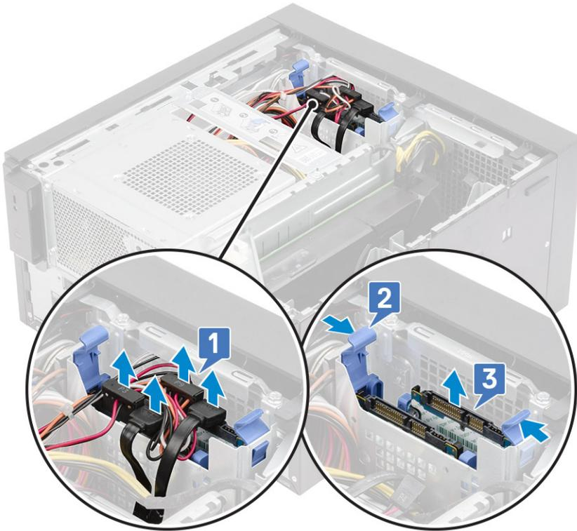
5. Trennen Sie das Daten- und Stromkabel von den jeweiligen Anschlüssen auf der Festplatte [1].
