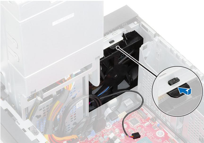
5. Schließen Sie das Kabel des vorderen Lüfters an die Systemplatine an.
