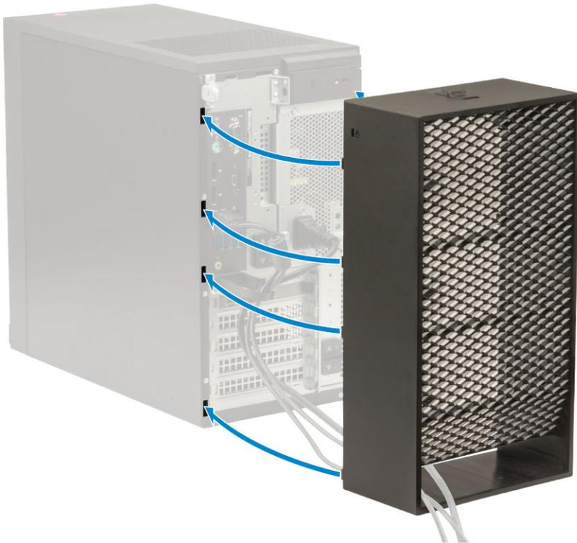
8. Drücken Sie vorsichtig die Kabelabdeckung nach unten, bis sie einrastet [1]. Schieben Sie die Verriegelung zum Gehäuse [2], bis die Kabelabdeckung fest sitzt.
