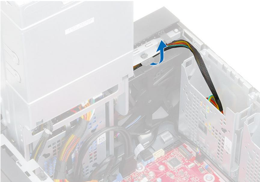
4. Trennen Sie das Kabel des vorderen Lüfters von der Systemplatine.
