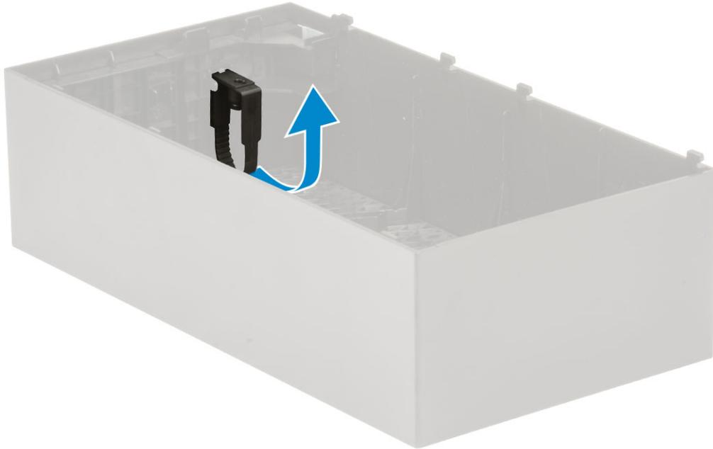
4. Heben Sie die Lasche an [1], um sie zu lösen, und ziehen Sie den Kabelbinder aus dem Steckplatz auf dem Kabelnriegelungsriegel [2].
