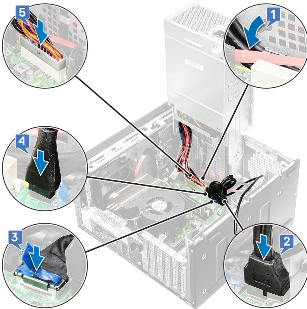
5. Führen Sie das E/A-Audiokabel durch die Führungsklemme neben der Systemplatine auf dem Gehäuse [1].
