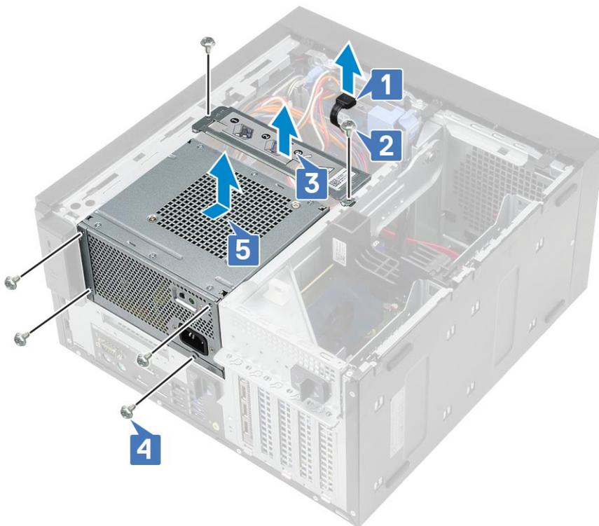
7. Trennen Sie den Kabelbaum von der 95 W-CPU-Systemkonfiguration.
