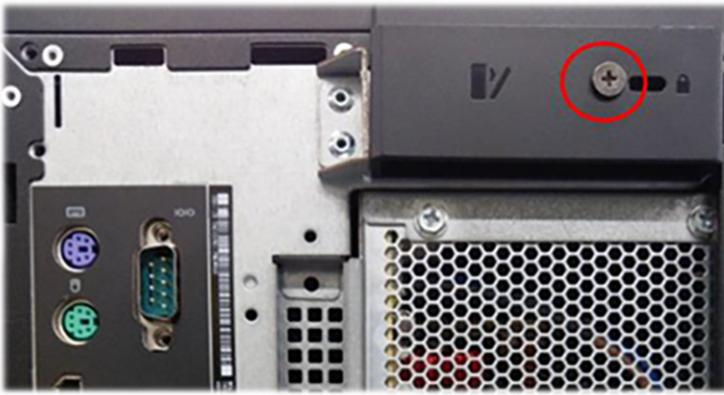
3. Drehen Sie die Abdeckung und heben Sie sie an, um sie aus dem Computer zu entfernen [2, 3].
