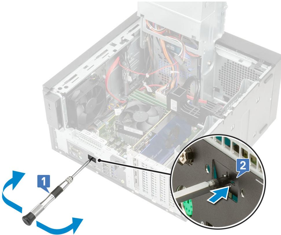
2. Setzen Sie die E/A-Karte in den Steckplatz auf der Innenseite des Computers ein [1] und bringen Sie die beiden M3x3-Schrauben wieder an, um die E/A-Karte am System zu befestigen [2].
