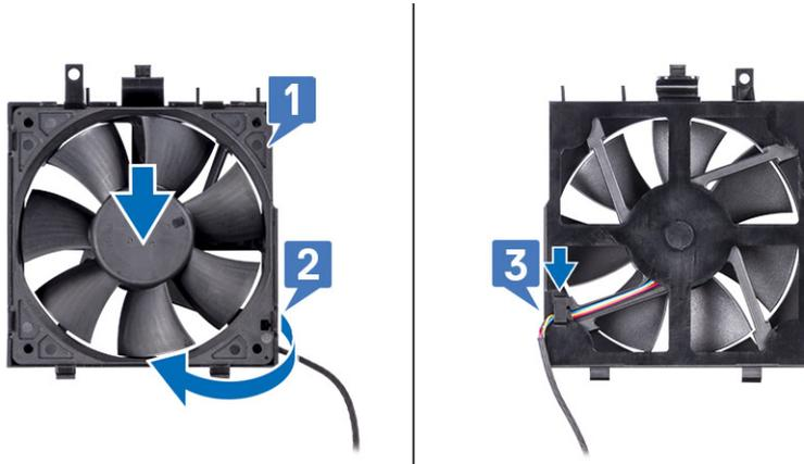
3. Setzen Sie den vorderen Lüfter in die Lüfterhalterung wieder ein.
