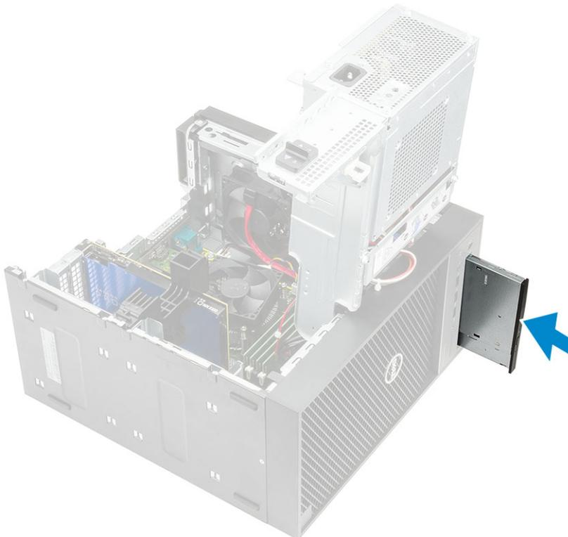
3. Verbinden Sie das Datenkabel und das Netzkabel mit dem optischen Laufwerk.
