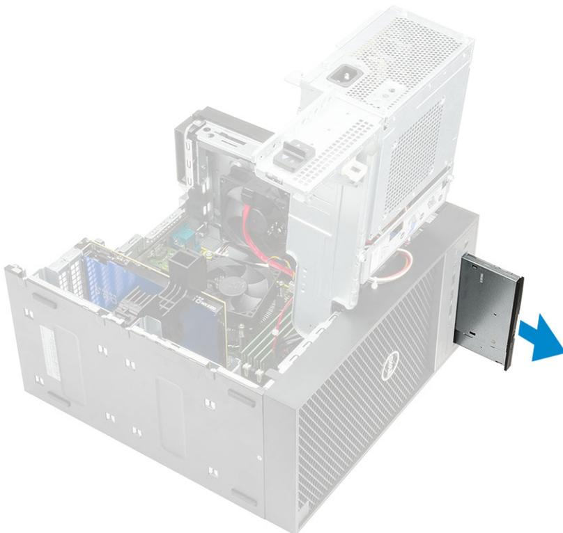
8. Entfernen Sie die M2x2,5-Schraube, mit der die Halterung des optischen Laufwerks am optischen Laufwerk befestigt ist [1], und entfernen Sie die Halterung des optischen Laufwerks [2].
