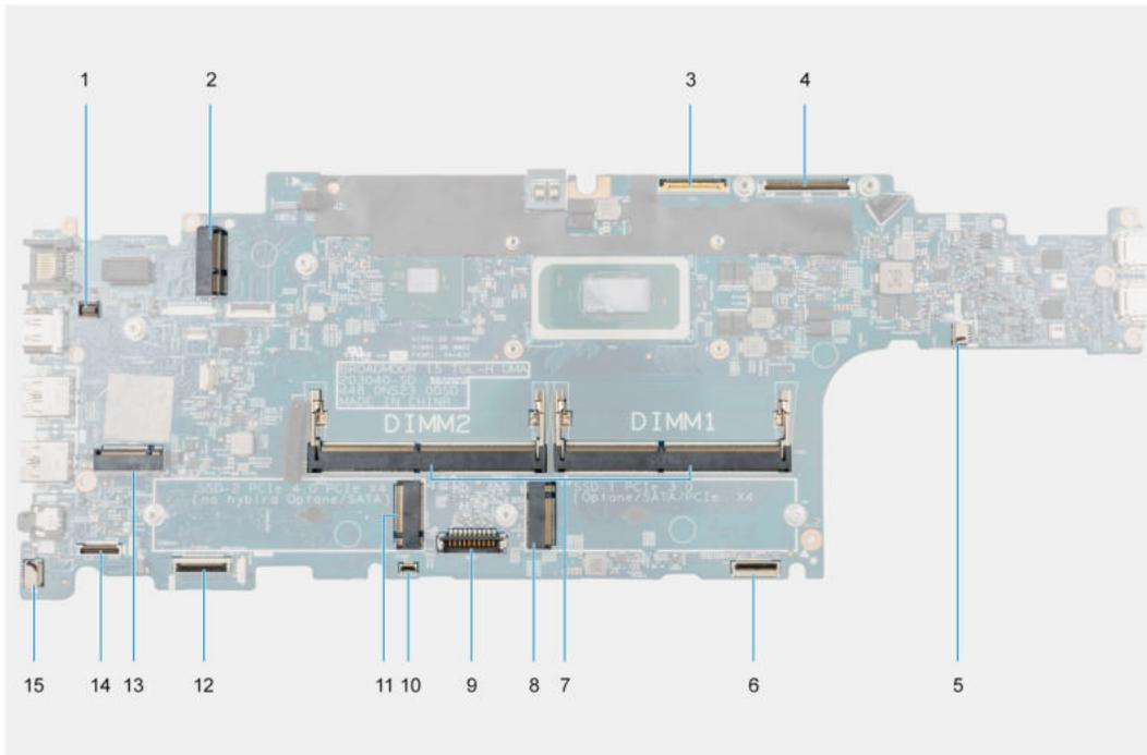
**Abbildung 1. Systemplattenanschlüsse**
