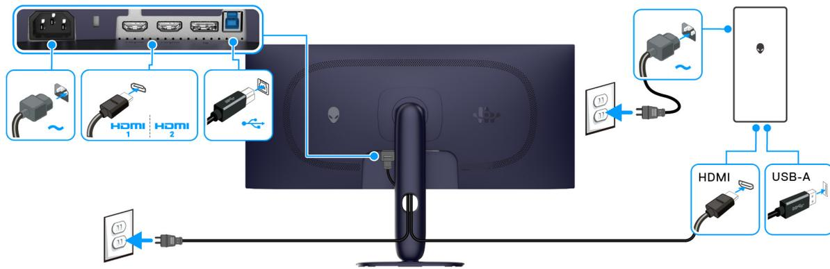
Abbildung 25. HDMI Verbindung
