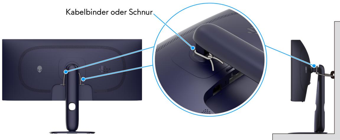
**Abbildung 23. Befestigen Sie den Ständerarm an einer Wand, damit der Monitor nicht umfallen kann**
