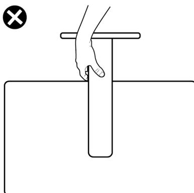
Abbildung 12. Falsches Anheben oder Bewegen des Monitors
