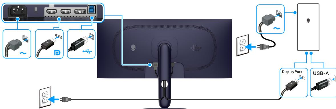
**Abbildung 24. DisplayPort Verbindung**
