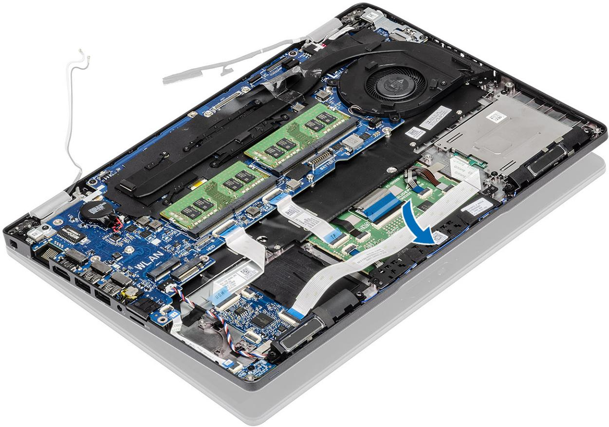
4. Führen Sie das Wireless-Antennenkabel durch die Kabelführung auf der Systemplatine [1].
