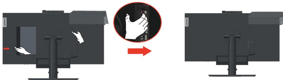
**Hinweis:** Stellen Sie sicher, dass Tiny an der Rückabdeckung ausgerichtet ist.
