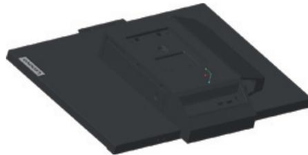
Schritt 4: Bringen Sie die Halterung aus dem VESA-Wandmontageset (100 × 100 mm Lochabstand) mit M4 x 10 mm-VESA-Montageschrauben an.
