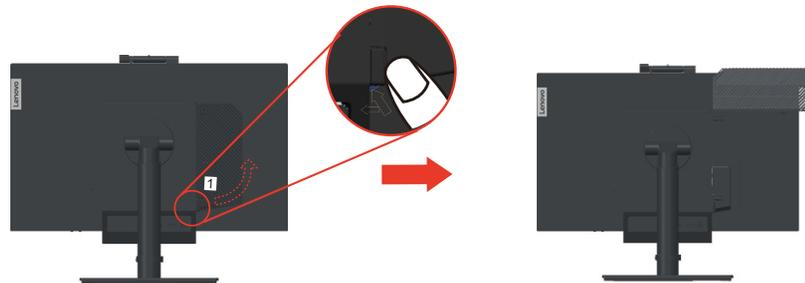
2. Schwenken Sie die hintere WLAN-Antenne um etwa 90 ° nach unten. Halten Sie dann das dickere Ende der hinteren WLAN-Antenne und schrauben Sie sie vom Computer ab.
