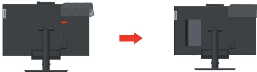
3. Ziehen Sie den Computer aus dem Computerschacht. Schwenken Sie die Kabelabdeckung dann wie abgebildet in die geschlossene Position.
