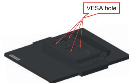
Schritt 5: Fixieren Sie den Monitor an der Wand, halten Sie sich dabei an die mit dem Wandmontageset gelieferten Anweisungen.
