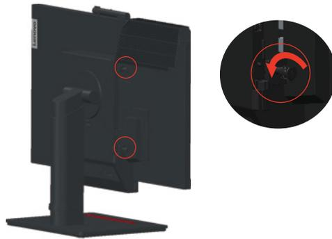
2. Drücken Sie den Computer von der Rückseite wie abgebildet zum Trennen vom 3-in-1-Kabel.
