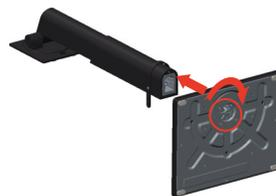
3. Stecken Sie die beiden Metallriegel am Ständer in die entsprechenden Löcher an der Rückseite des Monitors. Schwenken Sie den Ständer dann nach unten, bis er einrastet.
