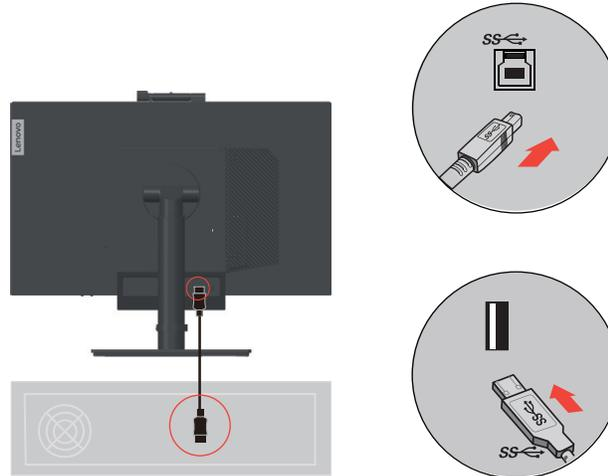
4. Verbinden Sie ein Ende des USB-Kabels mit dem USB-Downstream-Anschluss an der Seite des Monitors; verbinden Sie das andere Ende des USB-Kabels mit einem geeigneten USB-Port an Ihrem Gerät.
