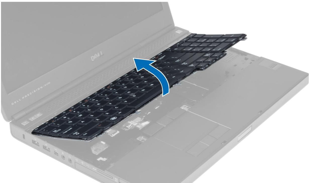
5. Trennen Sie das Tastaturdatenkabel von der Systemplatine und entfernen Sie die Tastatur.
