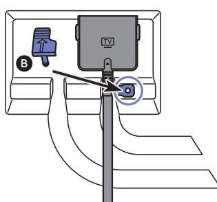
Legen Sie den Kabelhalter in das Loch, um die Kabel zu befestigen.
