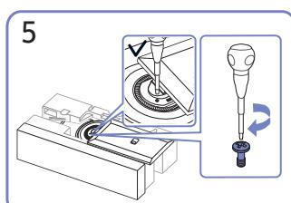
Drehen Sie die Befestigungsschraube in der Mitte des Standfußanschlusses fest, damit er sicher befestigt ist.
