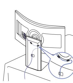
Führen Sie die Kabel durch die Kabelführung, um sie ordentlich zu verstauen.
