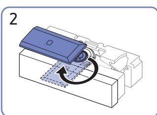
Drehen Sie den Standfußanschluss um 90 Grad.
