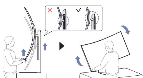
Den Standfuß auf seine volle Höhe anheben und dann den Monitor im Uhrzeigersinn drehen, um ihn ins Querformat zu wechseln.
