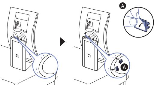
Bringen Sie die Kabelführung an der Nut auf der Rückseite des Monitors an.
