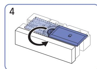
Drehen Sie den Standfußanschluss um 180 Grad in die Gegenrichtung.
