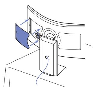
Schließen Sie die hintere Abdeckung, um den Vorgang abzuschließen.
