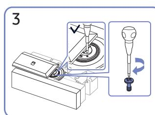
Drehen Sie die Befestigungsschraube in der Mitte des Standfußanschlusses fest, damit er sicher befestigt ist.
