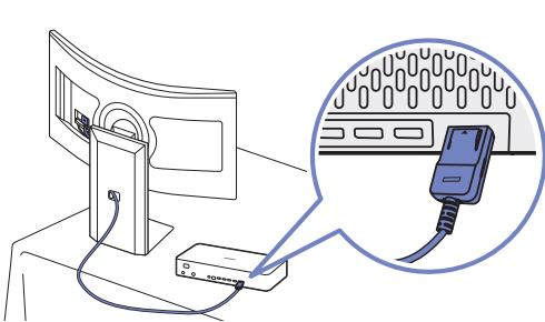
Schließen Sie die Kabel an One Connect an.
