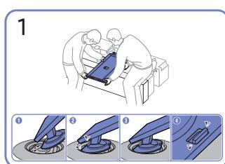
Schieben Sie den Standfußanschluss in Pfeilrichtung (siehe Abbildung) in das Gerätegehäuse hinein.
