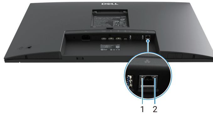
Abbildung 14. RJ45 Konnektor LED-Status
