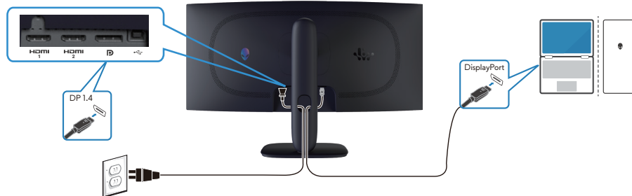
Afbeelding 22. De DisplayPort (DP naar DP)-kabel aansluiten
