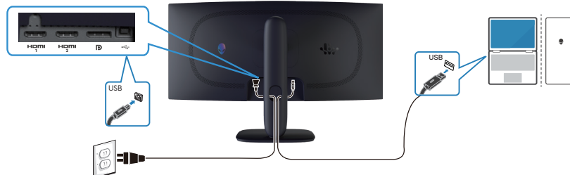
Afbeelding 24. De USB Type-B (Type-B naar Type-A)-kabel aansluiten
