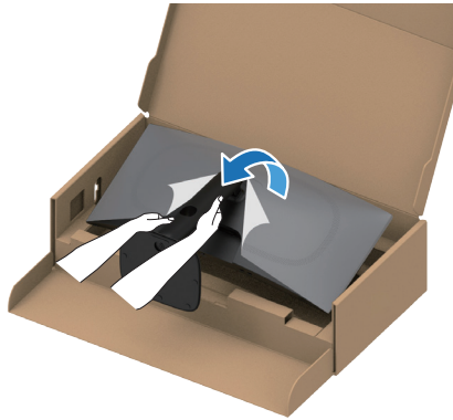
Abbildung 16. Ständer halten und Monitor anheben
