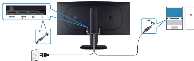
Abbildung 24. Das USB-Type-B-Kabel (Type-B auf Type-A) anschließen
