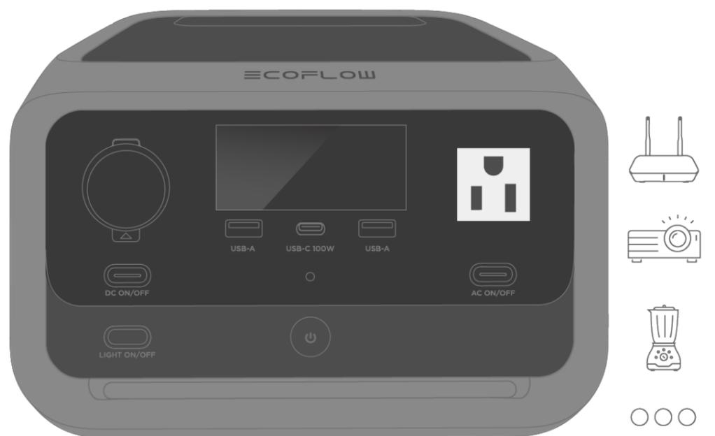
Achten Sie bei Verwendung der AC-Ausgänge darauf, dass die Gesamtleistung aller geladenen Geräte geringer ist als die Nennleistung der Steckdosen (Einzelheiten zu Leistungsbeschränkungen bei X-Boost finden Sie in der X-Boost-Anleitung).
