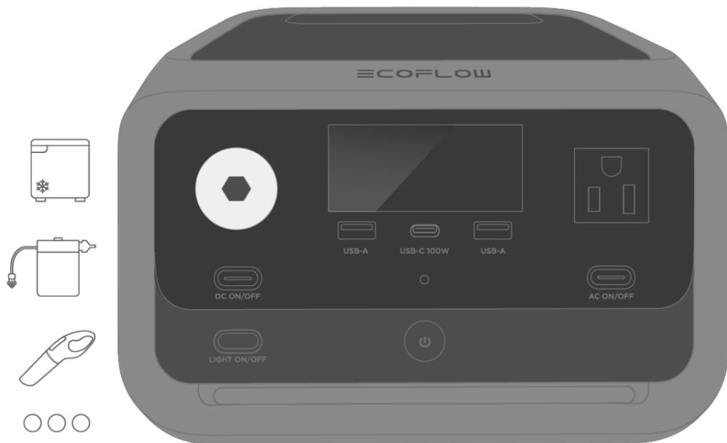
Wenn Sie Ihr Gerät über den DC-Ausgang einschalten, stellen Sie bitte sicher, dass dieser den Anlaufstromanforderungen des Geräts gerecht wird. Andernfalls kann das Gerät möglicherweise nicht normal starten (vorbehaltlich tatsächlicher Tests).
