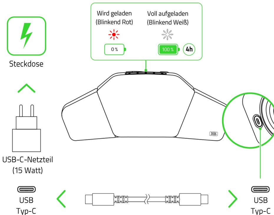
**i** Die Ladezeit hängt von der jeweiligen Stromversorgung ab. Externes Netzteil und Kabel separat erhältlich. Achte beim Aufladen des Kopfpolsters darauf, dass das Kabel nicht zur Stolperfalle wird. Du kannst ansonsten auch das Kopfpolster zum Aufladen entfernen.
