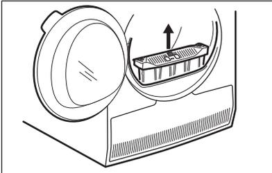
2. Öffnen Sie die Kondensatorabdeckung.
