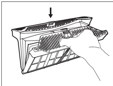
3. Entfernen Sie die Flusen von den beiden inneren Teilen des Siebs mit der Hand.
