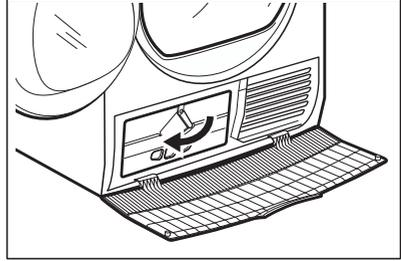
4. Klappen Sie den Kondensatordeckel nach unten.
