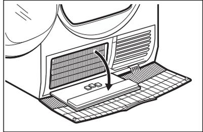
5. Entfernen Sie nach Bedarf die Flusen aus dem Kondensator und seinem Fach. Sie können einen Staubsauger mit dem Bürstenaufsatz verwenden.
