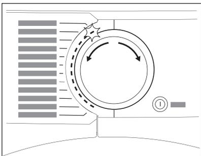
Wählen Sie das gewünschte Programm mit dem Programmwählschalter aus. Das Display zeigt die ungefähre Programmdauer an.
