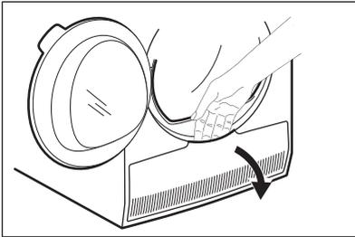
3. Drehen Sie den Hebel, um den Kondensatordeckel zu entriegeln.
