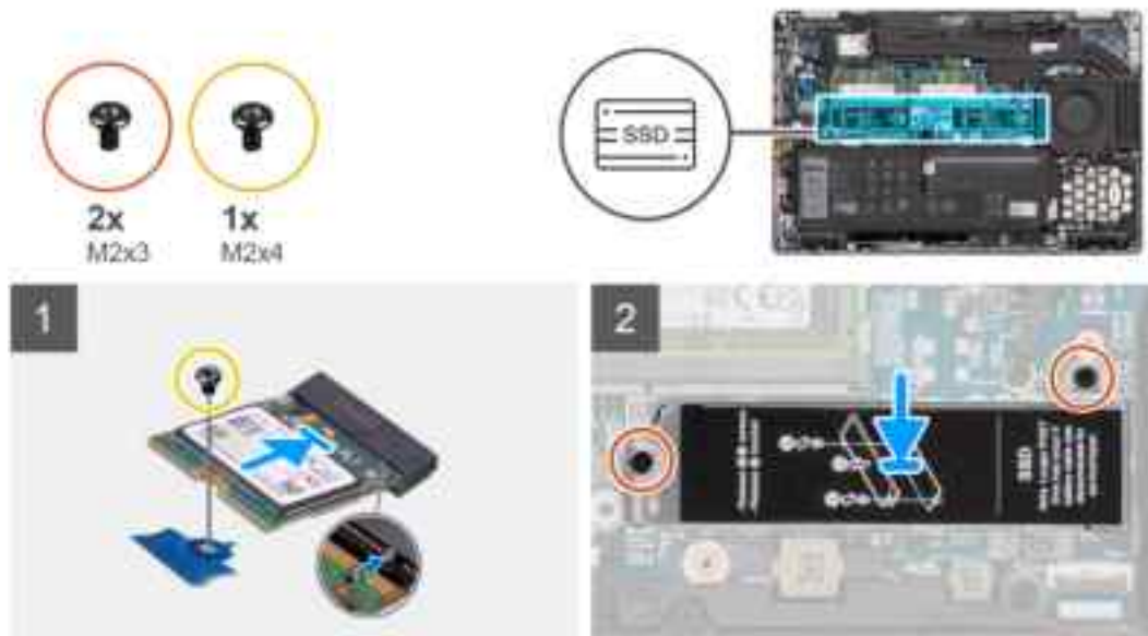
Abbildung 8. M.2-2230-Solid-State-Laufwerk mit Halterung
