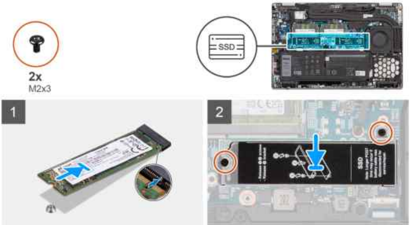
Abbildung 4. M.2-2280-Solid-State-Laufwerk mit Halterung
