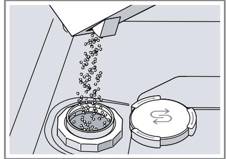
Den Vorratsbehälter komplett mit Spezijsalz füllen. Das Wasser im Vorratsbehälter wird verdrängt und läuft ab.
