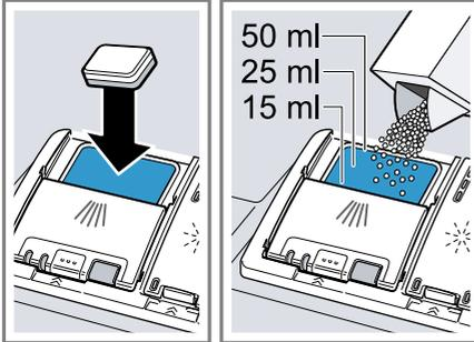
Wenn Sie Tabs verwenden, genügt eine Tablette. Tabs quer einlegen. Wenn Sie Pulverreiniger oder Flüssigreiner verwenden, beachten Sie die Dosierungshinweise des Herstellers und die Dosierungseinteilung der Reinigerkammer.
