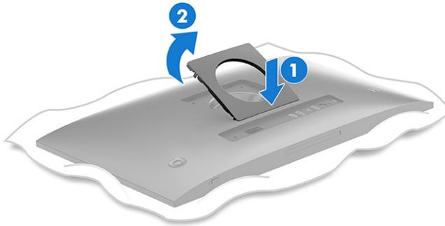
3. Entfernen Sie die vier Schrauben aus den VESA Bohrungen auf der Rückseite des Monitorkopfes (1) und entfernen Sie dann den Monitorständeranschluss (2).
