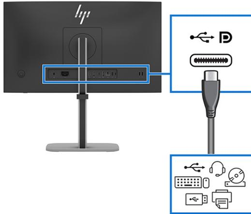
**HINWEIS:** Um die USB Type-A-Anschlüsse und den USB Type-C Anschluss (Downstream) zu aktivieren, schließen Sie das USB Type-C Kabel oder das USB Type-C-auf-USB Type-A-Kabel vom Quellgerät an den USB Type-C (Upstream) Anschluss an der Rückseite des Monitors an. Dieser Anschluss dient als USB-Hub für eine Maus, Tastaturen, Telefone, externe Festplatten und alles andere, was über einen USB-Anschluss angeschlossen wird.
