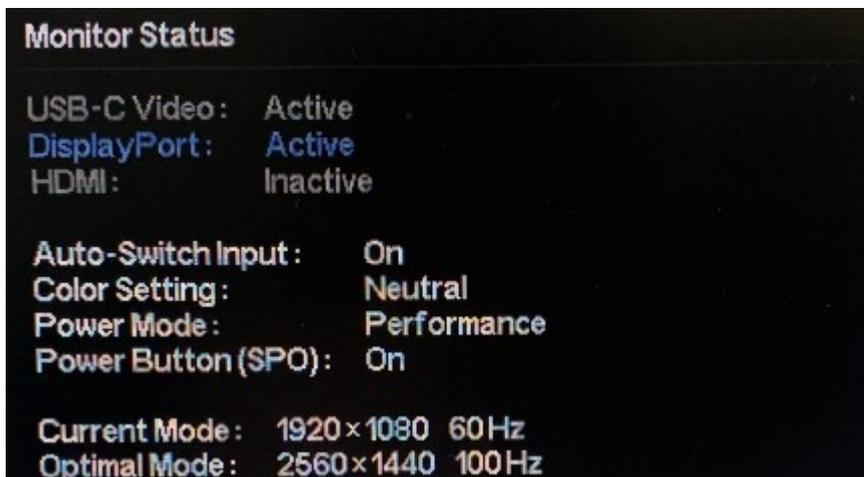
Das Einschaltbild und die Monitorstatusmeldung zeigen an, dass der Monitor wie erwartet funktioniert und nach einem gültigen Videosignal sucht.
