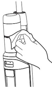
Verwenden Sie ein Tuch, um die Oberfläche mit einem neutralen Reinigungsmittel zu reinigen. Das Tuch sollte trocken sein, damit kein Wasser in das Gerät eindringen kann.
