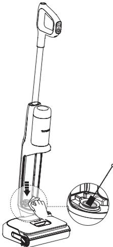
Reinigen Sie den Schmutzsensor mit einem feuchten Tuch oder dem Reinigungswerkzeug.
