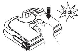
Setzen Sie den Behälter wieder in das Gerät ein. Wenn Sie den Vorgang korrekt ausgeführt haben, sollten Sie ein „klick“ hören.
