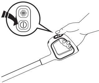
Schalten Sie das Gerät vor den Wartungsarbeiten aus, um das Verletzungsrisiko zu verringern.
