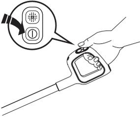
Drücken Sie die Taste ①, um das Gerät standardmäßig im AUTO-Modus zu starten. Drücken Sie die Taste erneut, um das Gerät auszuschalten. Wechseln Sie durch Drücken der
