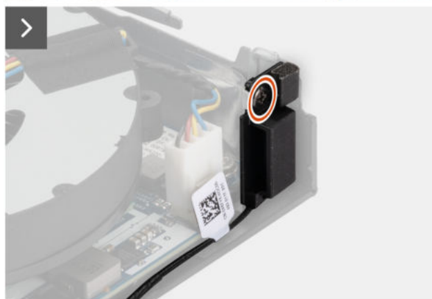
Abbildung 64. Entfernen des Antennenmoduls (schwarzes Kabel)
