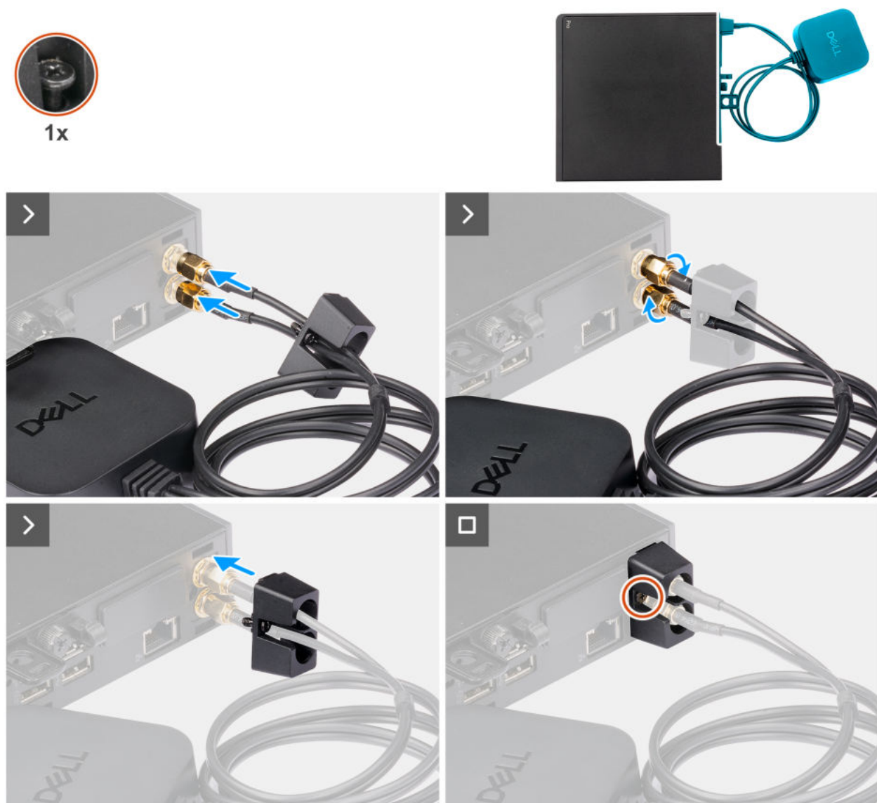
Abbildung 35. Einbauen der externen Puck-Antenne
