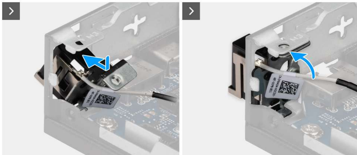
Afbeelding 68. De antennemodule (witte kabel) plaatsen
