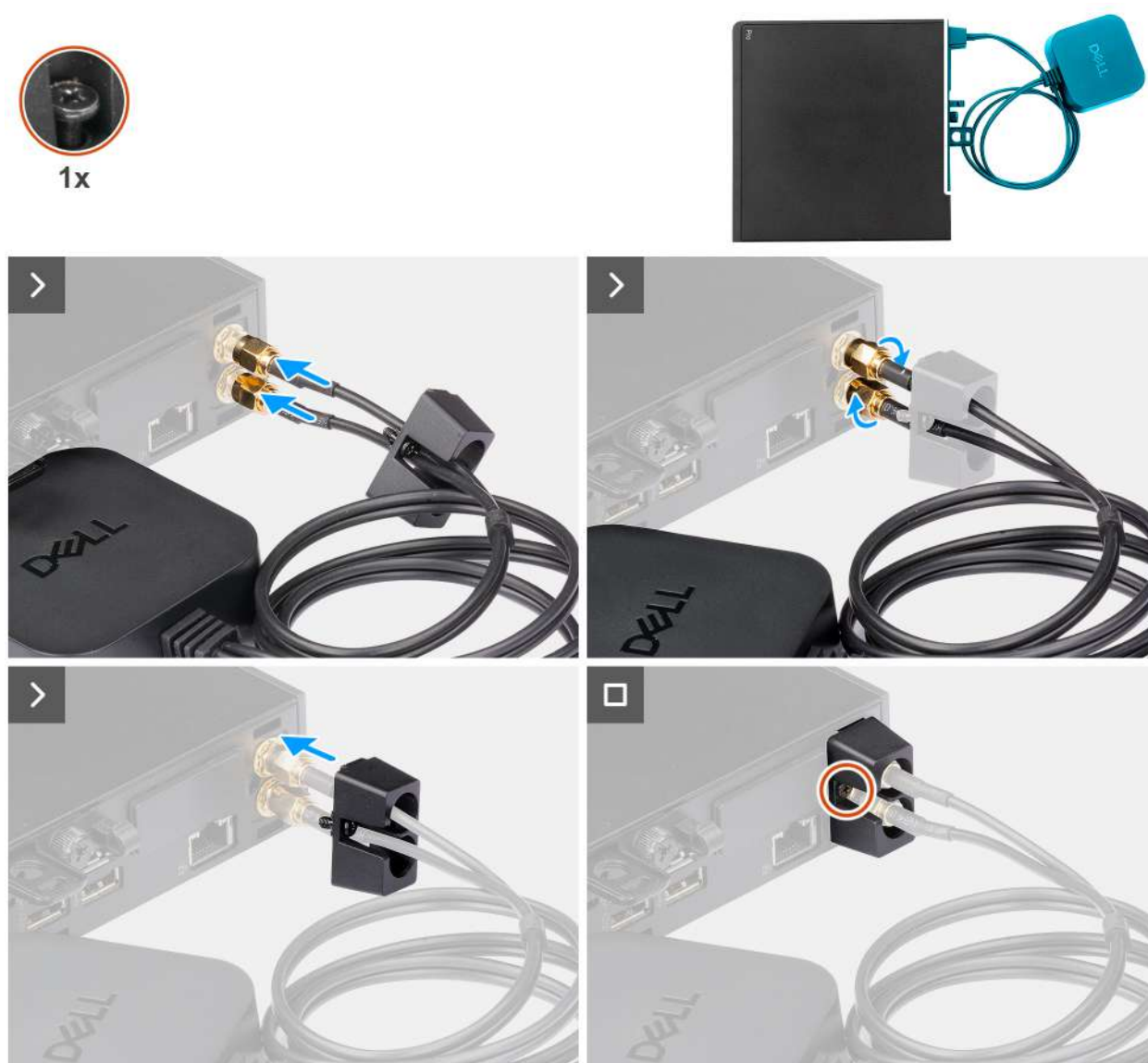
Afbeelding 35. De externe puckantenne installeren
