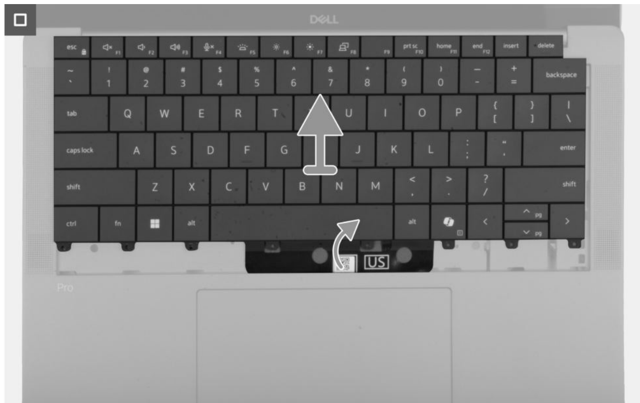
Abbildung 72. Entfernen der Tastaturbaugruppe
