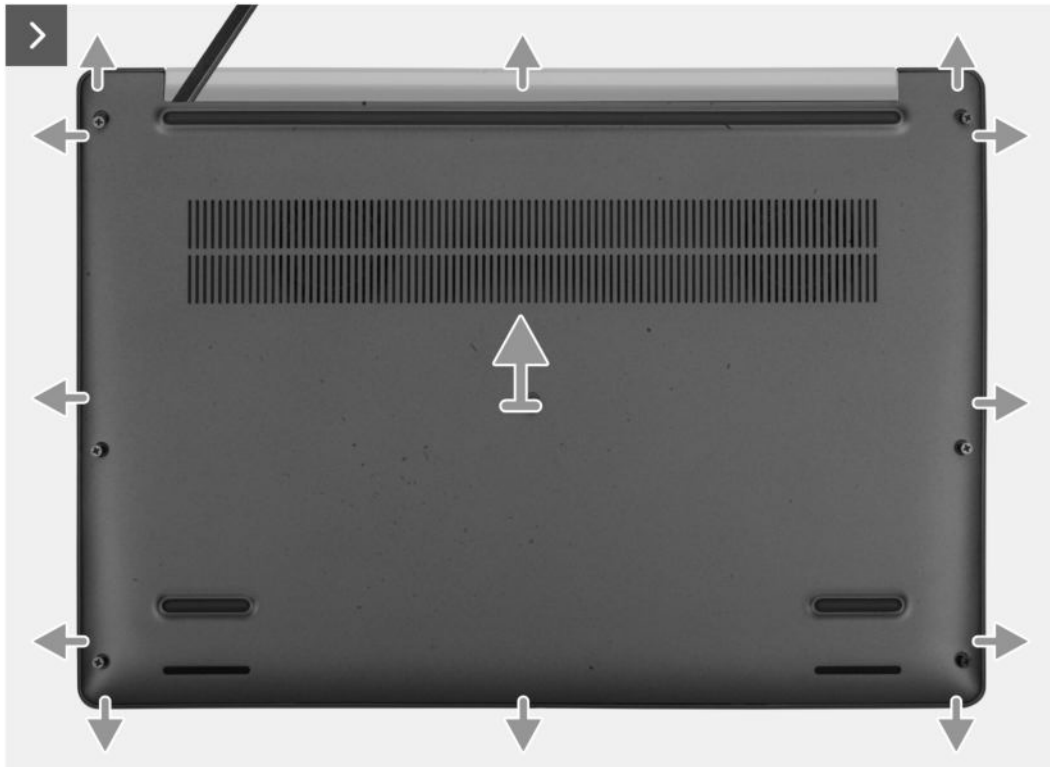
Abbildung 15. Entfernen der Bodenabdeckung
