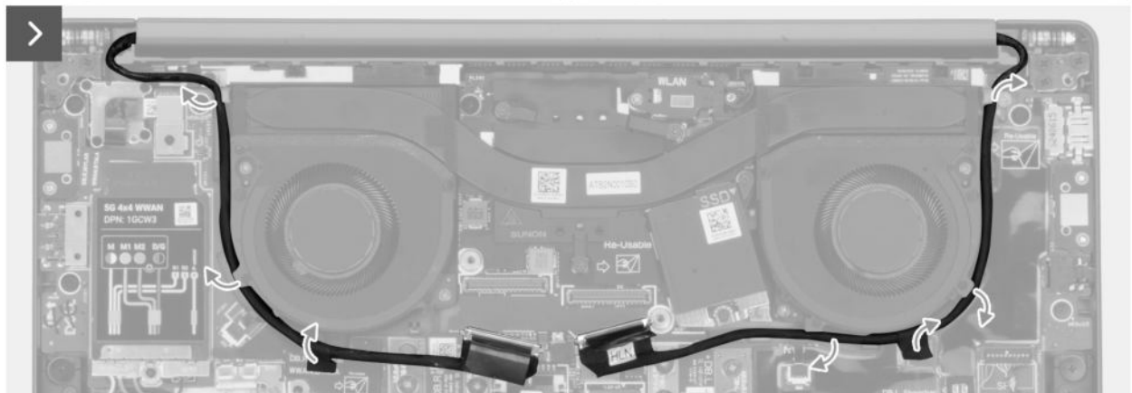
Abbildung 56. Trennen der Display- und Kamerakabel
