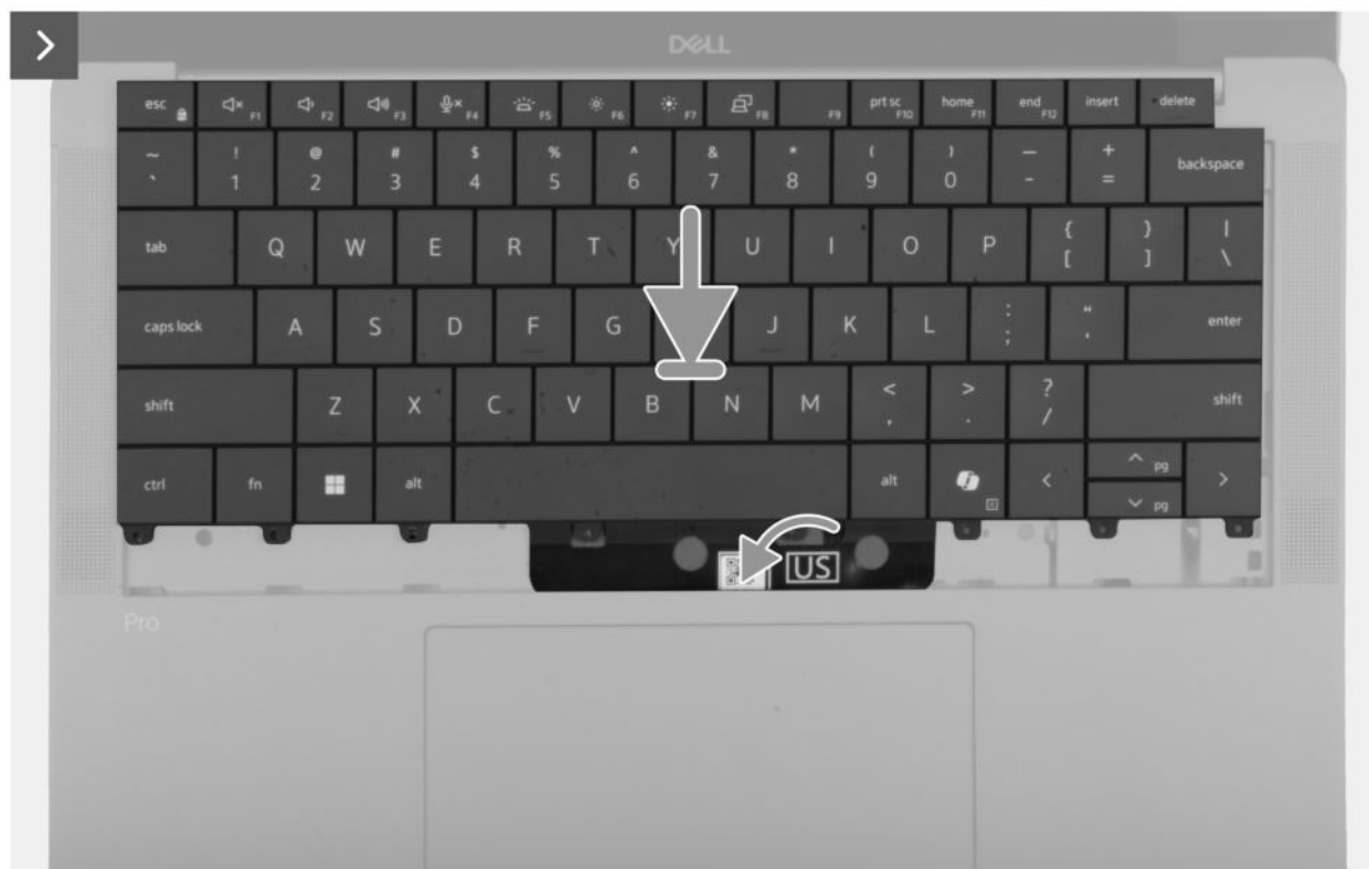
Abbildung 73. Installieren der Tastaturbaugruppe
