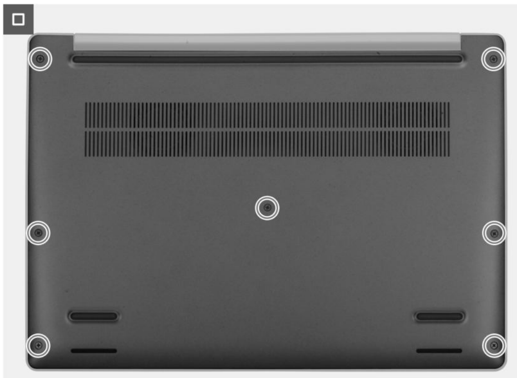
Abbildung 19. Festziehen der unverlierbaren Schrauben
