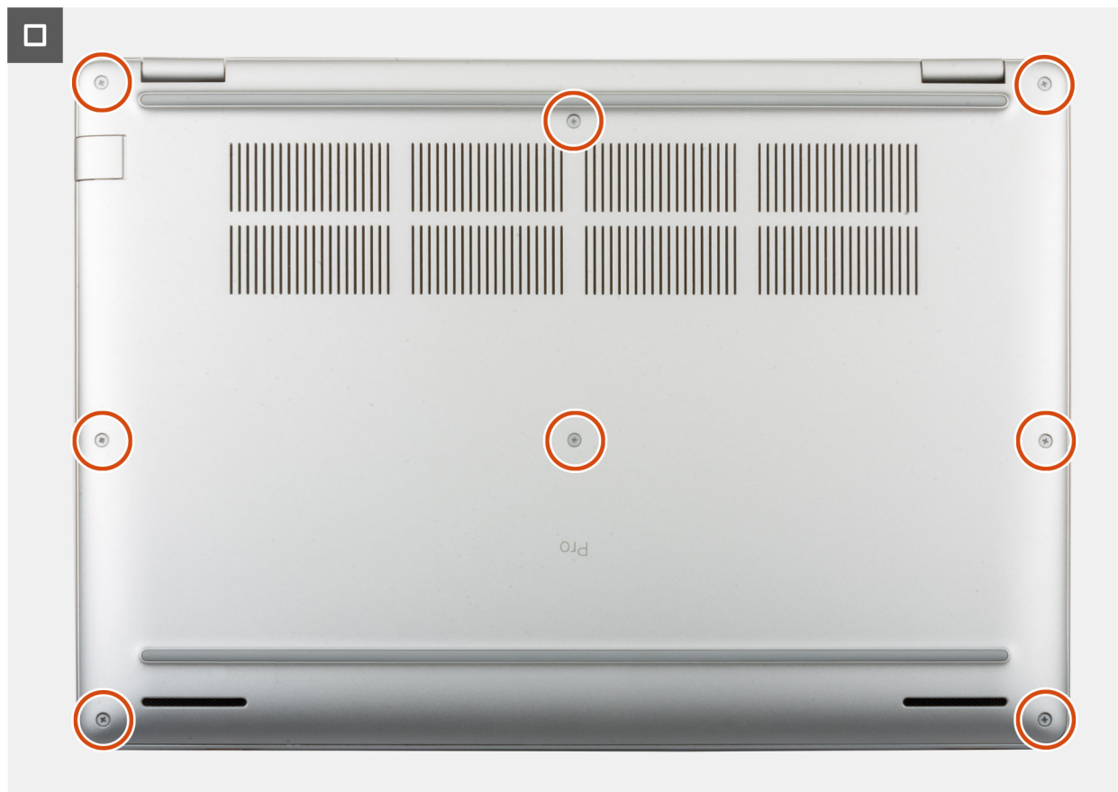
Abbildung 16. Anbringen der Bodenabdeckung
