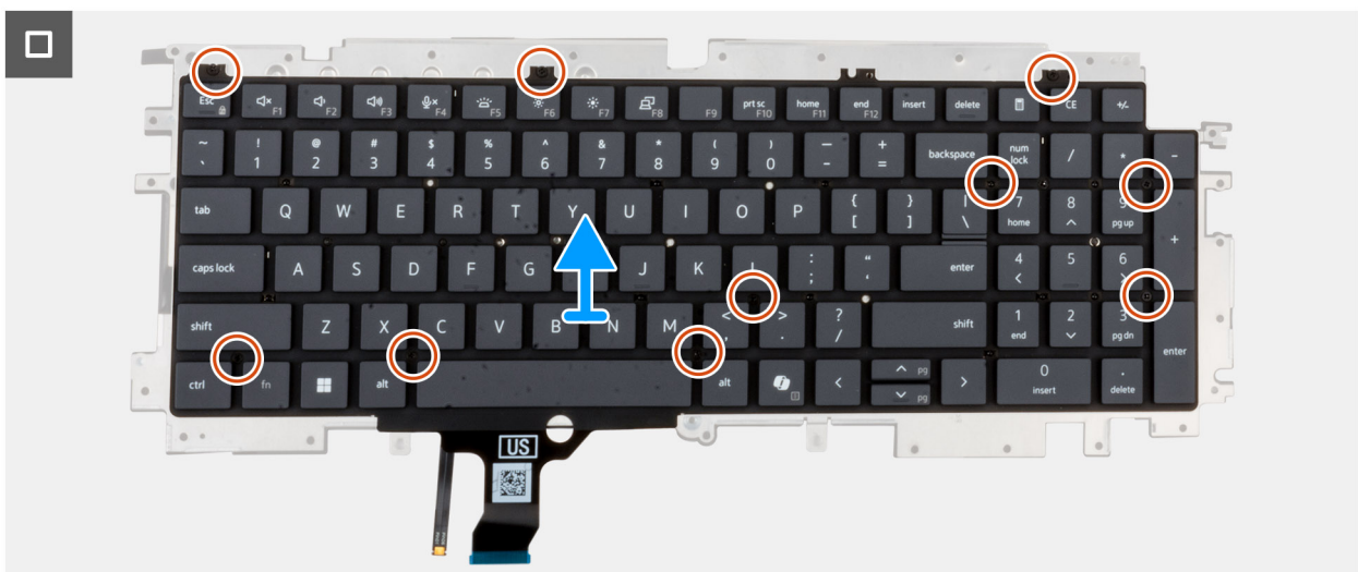
Abbildung 59. Entfernen der Tastatur
