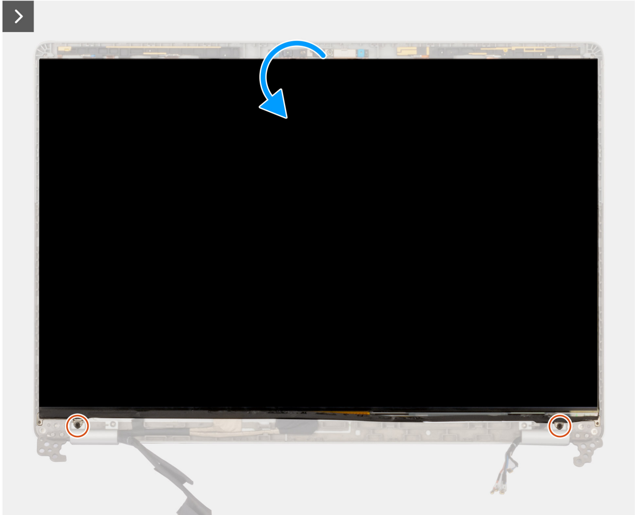
Abbildung 30. Entfernen des Bildschirms
