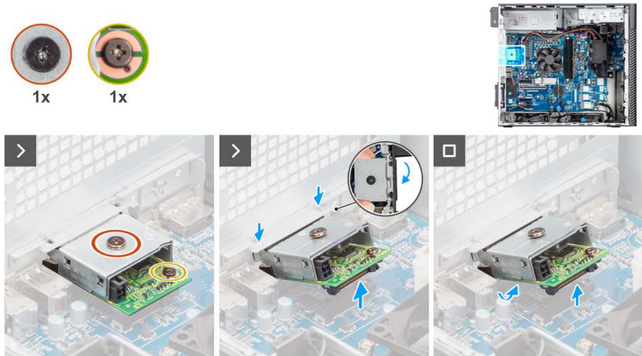
Afbeelding 82. De optionele USB-module verwijderen
