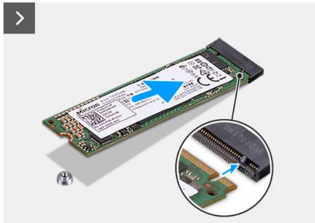
Afbeelding 34. De M.2 2280 PCIe SSD plaatsen
