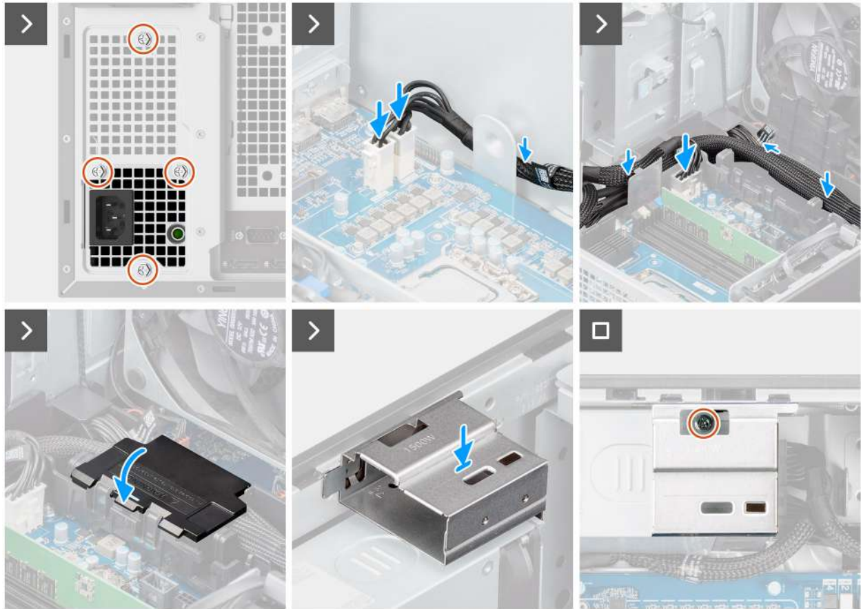
Afbeelding 56. De voedingseenheid van 1500 W plaatsen
