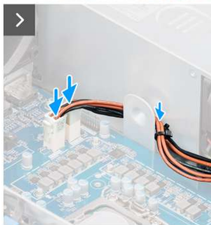
Afbeelding 58. De voedingseenheid van 360 W plaatsen
