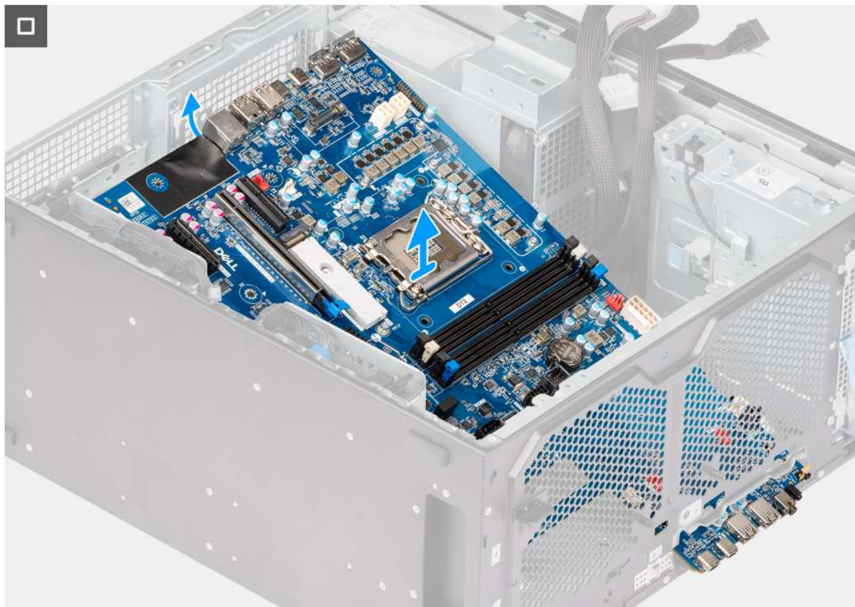
Afbeelding 92. De systeemkaart verwijderen
