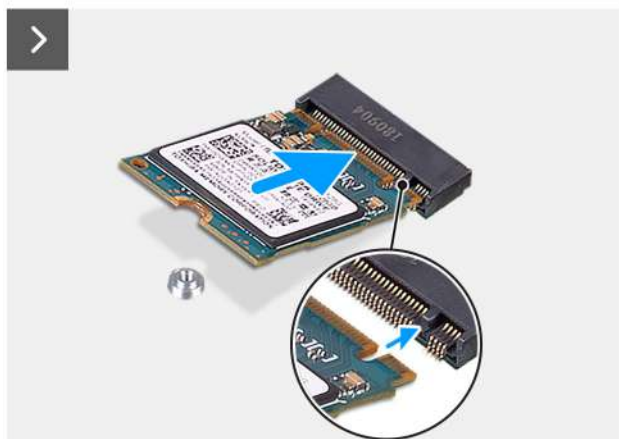
Afbeelding 32. De M.2 2230 PCIe SSD plaatsen
