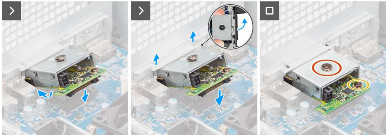
Afbeelding 81. De optionele Thunderbolt-module installeren
