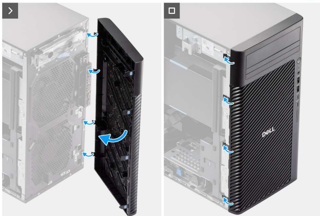
Afbeelding 18. Het montagekader aan de voorkant plaatsen
