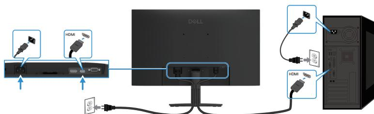
Abbildung 16. HDMI-Kabel anschließen
