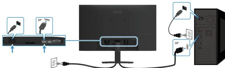
Abbildung 15. DP-Kabel anschließen
