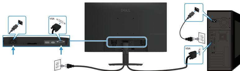
Abbildung 14. VGA-Kabel anschließen
