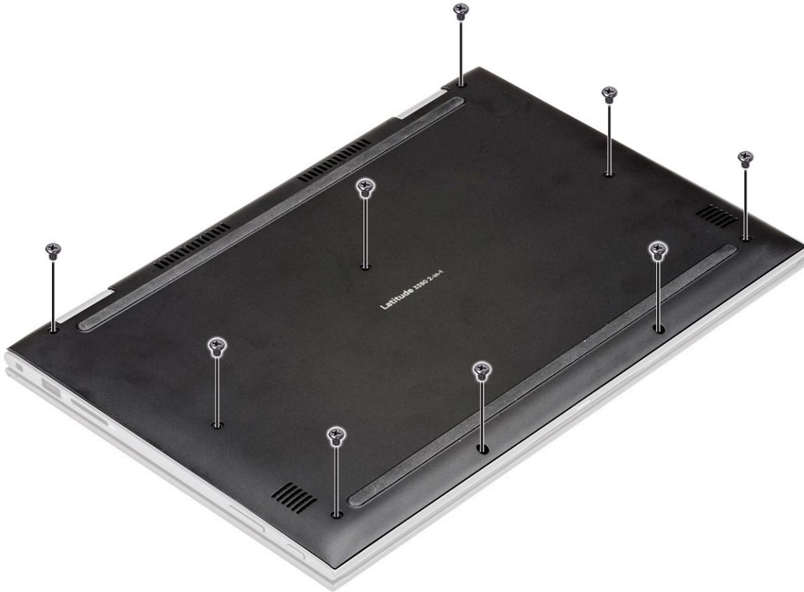
4. Hebeln Sie mithilfe eines Kunststoffstifts die Bodenabdeckung von den Kanten des Notebook-Gehäuses ab [1].
