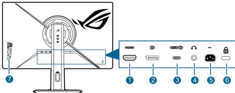
1. **HDMI-Port:** Dieser Port dient dem Anschließen eines HDMI-kompatiblen Gerätes.
