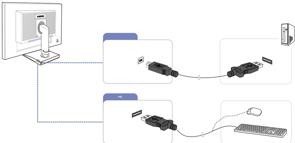
1 Verbinden Sie den [USB]-Anschluss des Monitors über ein USB-Kabel mit dem USB-Anschluss des Computers.
