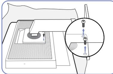
Lösen Sie die Schraube auf der Rückseite des Geräts.
