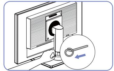
Sie können den Sicherungsstift nun entfernen und den Standfuß ausrichten.
