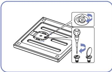
Ziehen Sie (mit einem Schraubenzieher oder einer Münze) die Schraube an der Unterseite des Sockels fest.
