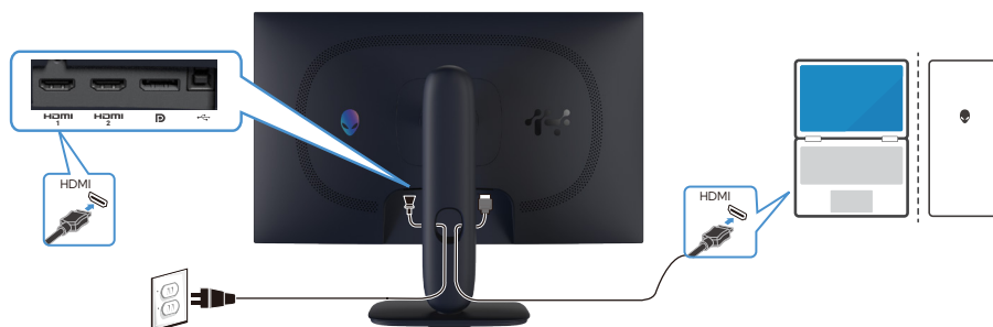
Figure 29. De HDMI-kabel aansluiten
