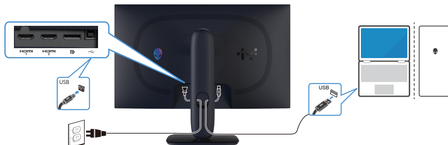
Figure 30. De USB Type-B (Type-B naar Type-A)-kabel aansluiten
