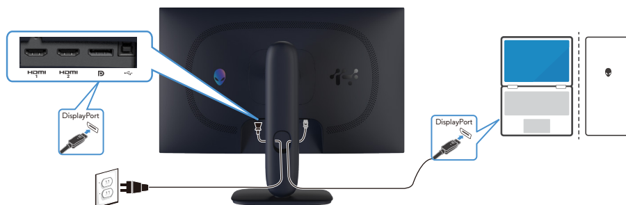
Figure 28. De DisplayPort (DP naar DP)-kabel aansluiten
