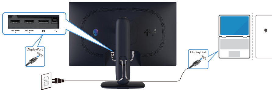
Figure 28. DisplayPort-Kabel (DP auf DP) anschließen
