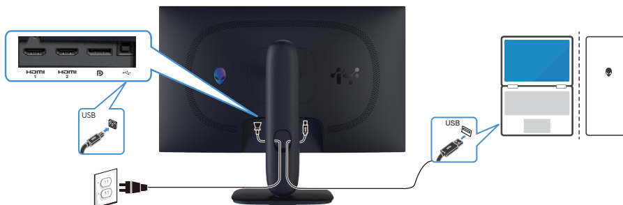
Figure 30. Das USB-Type-B-Kabel (Type-B auf Type-A) anschließen
