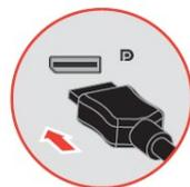
3. Verbinden Sie ein Ende des HDMI-Kabels mit dem HDMI-Anschluss an der Rückseite des Computers und das andere Ende mit dem HDMI-Anschluss am Monitor. Lenovo empfiehlt Kunden, die den HDMI-Eingang an ihrem Monitor nutzen müssen, das „HDMI-zu-HDMI-Kabel OB47070 von Lenovo“ zu kaufen.
