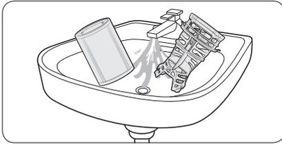
4. Beseitigen Sie Schmutz und Verunreinigungen aus dem Mikrofilter und den Grobfilter.
