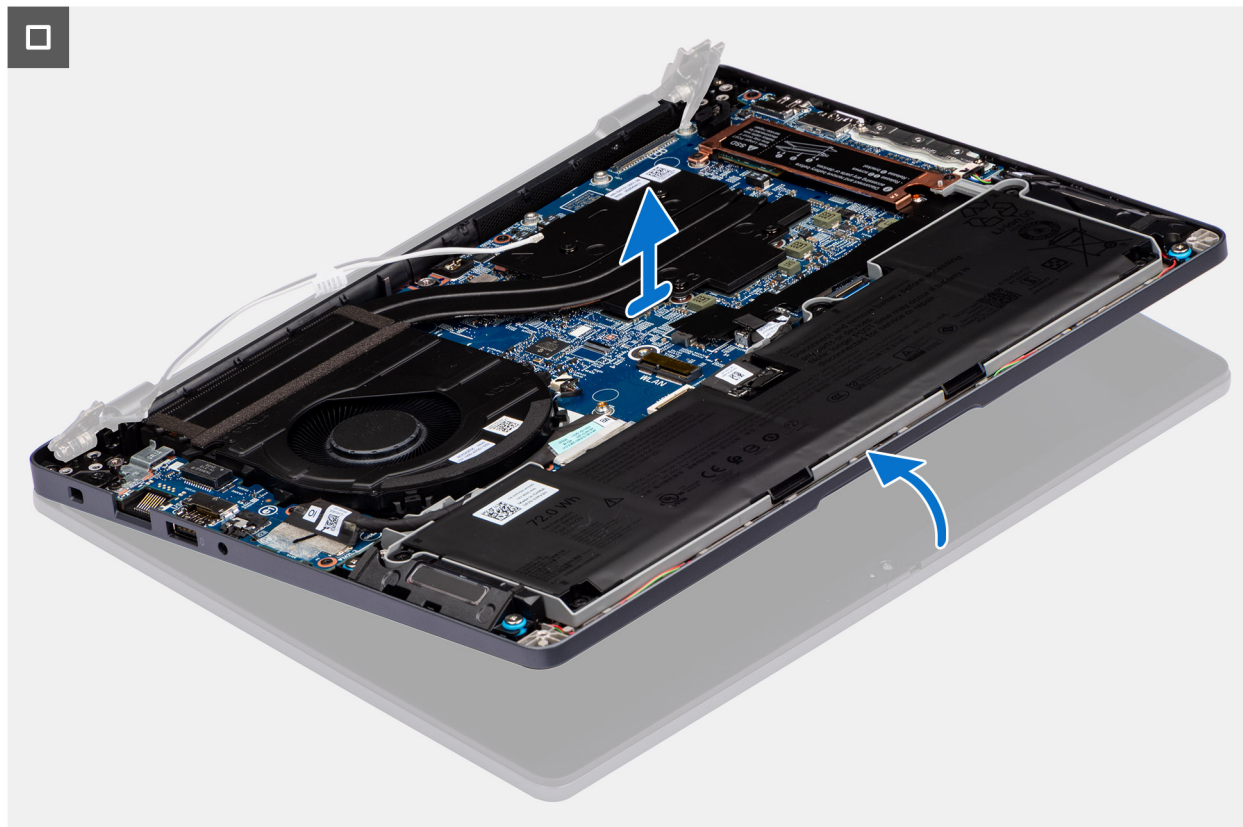
Abbildung 44. Entfernen der Bildschirmbaugruppe
