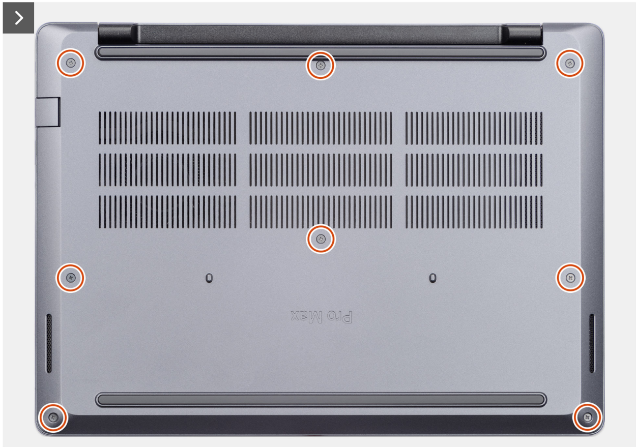
Abbildung 11. Entfernen der Bodenabdeckung
