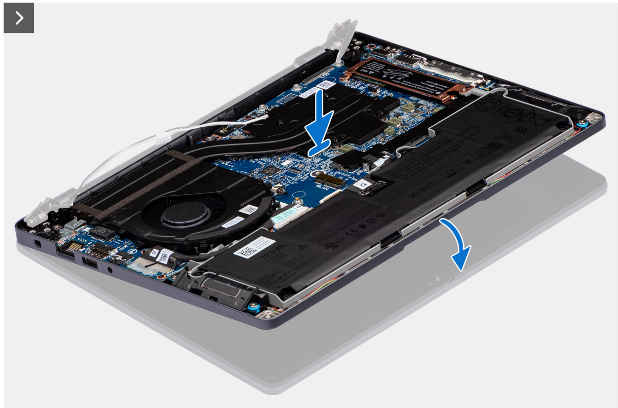
Abbildung 46. Einbauen der Bildschirmbaugruppe
